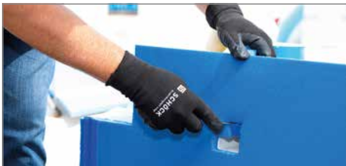
Ill. 36: Découper la forme de la gaine de palier
