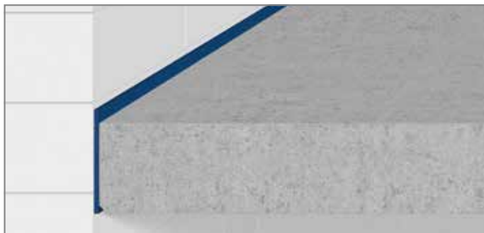
Ill. 31: Le matériau de joint Tronsole® type L est mis en oeuvre avec un surplomb de 30-40 mm au-dessus de la marche brute/du palier, ou de 10 mm au-dessus de la surface du revêtement
