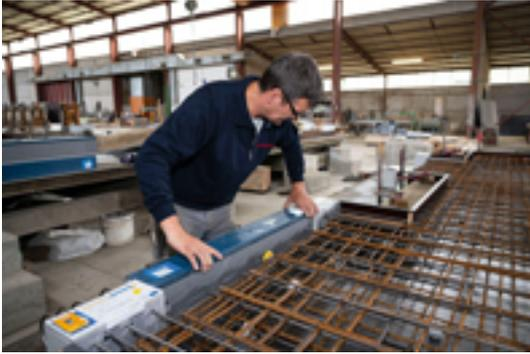
*Das tragende Wärmedämmelement Schöck Isokorb wurde bereits im Fertigteilwerk eingebaut, um Fertigteile in einer hohen Sichtbetonqualität herzustellen. Foto: Schöck Bauteile GmbH*
