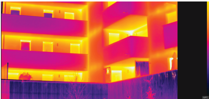
Mise en évidence par caméra thermique infrarouge de ponts thermiques conséquents pour ce nouvel ensemble immobilier.
