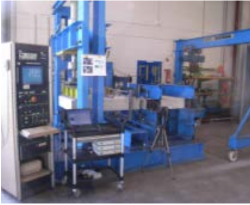
Simulatore sismico utilizzato per le prove di laboratorio sul giunto Isokorb® (Foto Schöck Italia)
