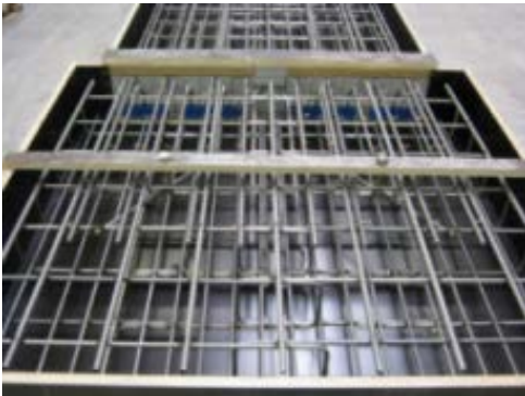
Il provino Isokorb®, prima del getto di calcestruzzo, utilizzato per i test (Foto Schöck Italia)
