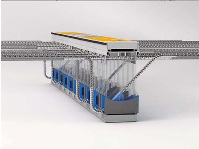
*Integrierte Feuerschutzbänder aus dämmschichtbildenden Materialien an der Oberseite des Schöck Isokorb garantieren, dass die bei Brandeinwirkung aufgehenden Fugen wirksam verschlossen und die Bewehrungsstäbe nicht durch Heissgase geschwächt werden.*
