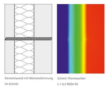
Der Schöck Thermoanker verbindet die äußere Schale von Element- und Sandwichwänden nahezu ohne Wärmebrücken. Foto: Schöck Bauteile GmbH, Abdruck honorarfrei.
