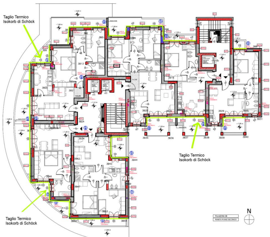
Foto 5: Dettagli di posa del giunto isolante Isokorb® in corrispondenza di balconi e terrazze di uno dei quattro edifici
