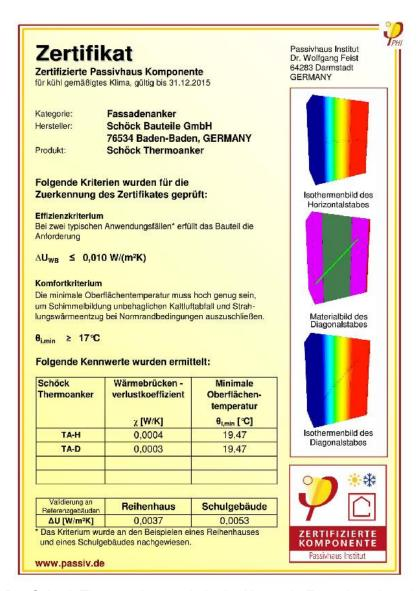
Der Schöck Thermoanker wurde in der Kategorie Fassadenanker als Passivhaus Komponente zertifiziert.
