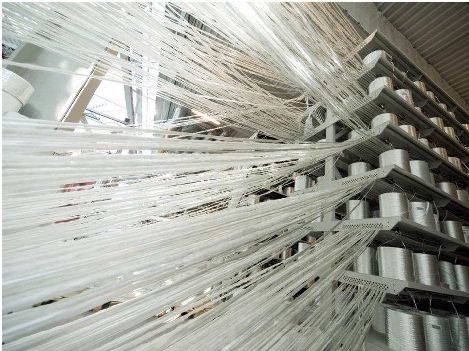
*Bei der Pultrusion, dem ersten Schritt des Herstellungsverfahrens, werden die hochfesten Glasfasern so dicht wie möglich gebündelt, durch ein Werkzeug gezogen und dabei mit flüssigem Kunstharz imprägniert. Anschließend, in der*
