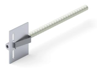
Der stabförmige Wandhalter – hier im Modell mit Gleitpunkt – besteht aus einem Glasfaserverbundwerkstoff. Die punktuellen Wärmeverluste sind dabei so gering, dass pauschale Berechnungsmethoden eine rechnerisch wärmebrückenfreie Konstruktion ergeben. Foto: Schöck Bauteile GmbH
