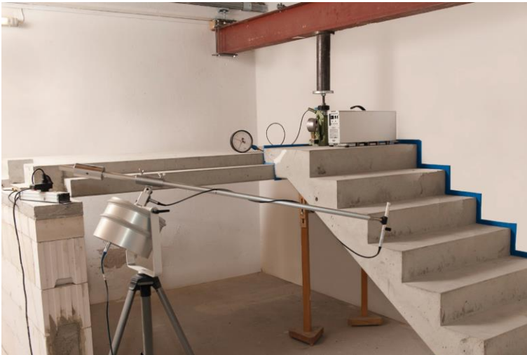
Trittschallmessungen bei massiven Treppen nach DIN 7396 dienen als Grundlage des Schallschutznachweis nach DIN 4109. Foto: Schöck Bauteile GmbH, Abdruck honorarfrei.
