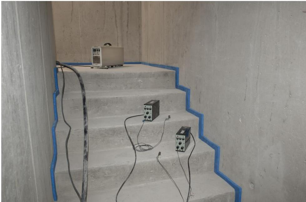
*Trittschallmessgerät auf dem schalldämmten Treppenlauf. Foto: Schöck Bauteile GmbH, Abdruck honorarfrei.*
