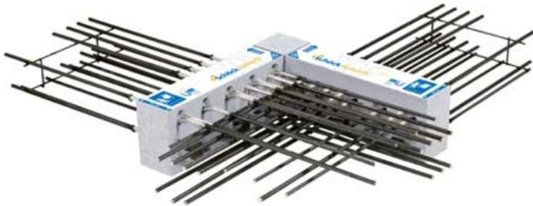
*Mit dem Isokorb Typ EXT hat Schöck eine optimale Lösung für Balkone über Außenecken entwickelt. Die hohe Tragfähigkeit des Isokorb EXT ermöglicht Auskragungslängen bis zu zwei Metern.*
