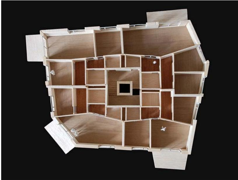
*Am Modell lässt sich das durchdachte Zwiebelschalenprinzip ablesen: Vom inneren Kern aus gelangt man nach und nach über „reinigende“ Schleusen in die Aufenthaltsräume an den Aussenseiten des Gebäudes.*
