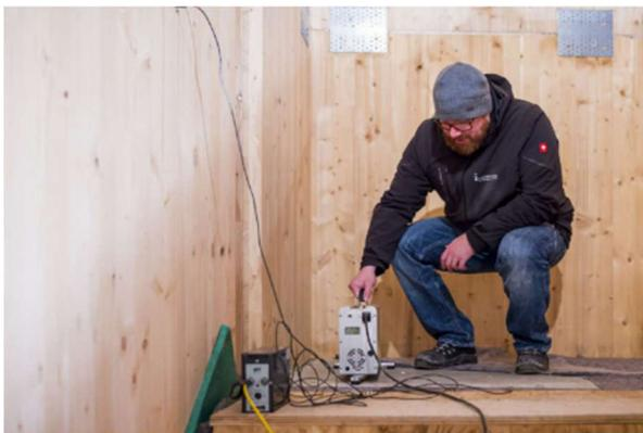
*Da es in Deutschland bislang jedoch wenig Erfahrung und messbare Daten zum Schallschutz im Holzbau bzw. im Holzhybridbau gibt, hat Schöck den Einsatz von Tronsole zur Trittschalldämmung wissenschaftlich begleiten und prüfen lassen.
