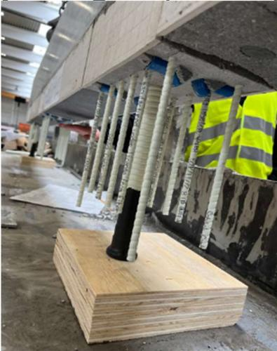
Beim Aufstellversuch mit einem Prototyp im Fertigteilwerk wurde die Stabilität der Montagestütze in Verbindung mit dem neuen Einbausystem überprüft.
