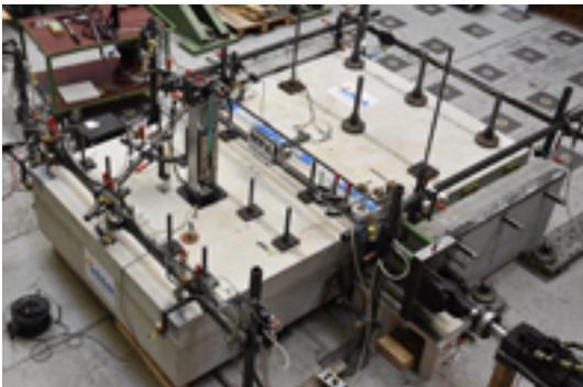
*In einer Bauteilversuchsreihe am MPA Karlsruhe hat Schöck den Einfluss des Anchlusselements Schöck Isokorb auf das Schwingungsverhalten von frei auskragenden Stahlbetonbalkonen untersucht.
