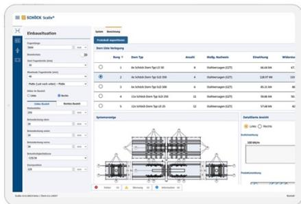
*Das Scalix Modul „Dehnfuge Stahlbeton – Stahlbeton“ zur einfachen und sicheren Bemessung des neuen Querkraftdorns Stacon.*
