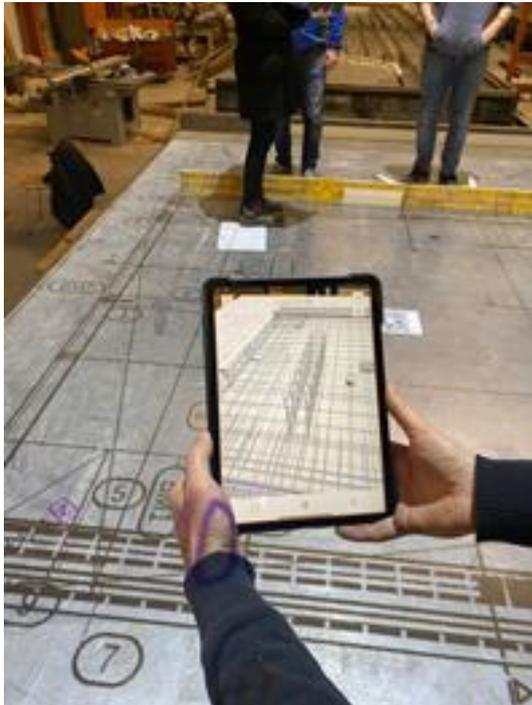
*Chekker ist eine einfach zu bedienende und hocheffiziente Hybridlösung aus 2,5D-Laser-/Beamerprojektion und optionaler AR-Visualisierung auf Tablet, Smartphone oder HoloLens.
