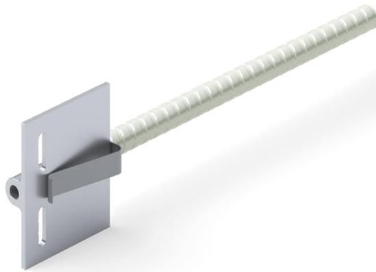
*Der stabförmige Wandhalter – hier im Modell mit Gleitpunkt – besteht aus einem Glasfaserverbundwerkstoff. Die punktuellen Wärmeverluste sind dabei so gering, dass pauschale Berechnungsmethoden eine rechnerisch wärmebrückenfreie Konstruktion ergeben. Foto: Schöck Bauteile GmbH*
