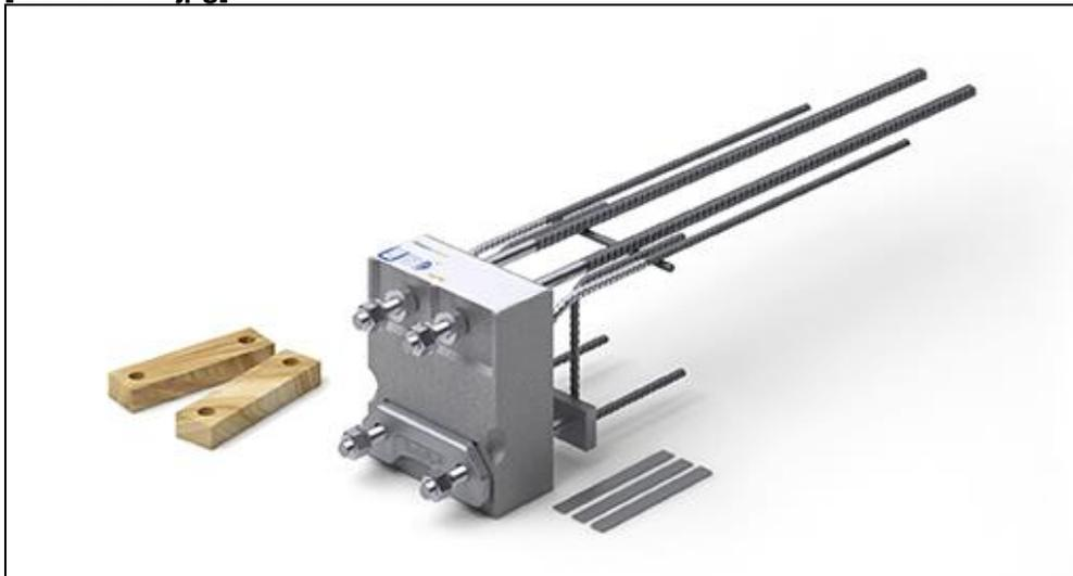
*Das tragende Wärmedämmelement Isokorb Typ KS garantiert einen wärmebrückenarmen Anschluss von frei ausragenden Stahlträgern an Stahlbetondecken. Foto: Schöck Bauteile GmbH, Abdruck honorarfrei.*
