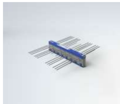
Schöck Isokorb typu K z HTE-Compact o grubości 80 mm jest nośnym elementem izolacji termicznej, który został opracowany dla żelbetonowych balkonów wspornikowych. Fot. Schöck
