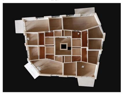
Am Modell lässt sich das durchdachte Zwiebelschalenprinzip ablesen: vom inneren Kern aus gelangt man nach und nach über "reinigende" Schleußen in die Aufenthaltsräume an den Außenseiten des Gebäudes.
