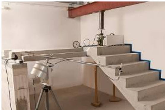
Procedura badań laboratoryjnych dla schodów żelbetonowych została opracowana w czerwcu 2016r. w Niemczech i została zawarta w normie DIN 7396 Fot. Schöck
