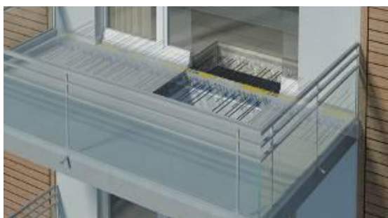
Łączniki termoizolacyjne Schöck Isokorb są w całości zatopione w betonowej powłoce Fot.: Schöck
