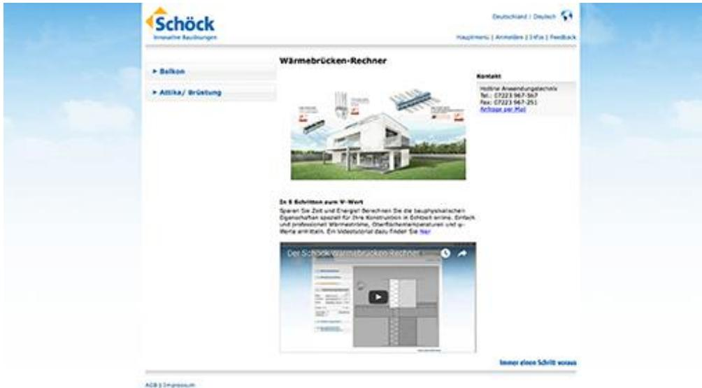
*Ausgehend von der Konstruktion können mit dem Wärmebrücken-Rechner zwei-dimensionale Wärmeströme, Isothermen, Oberflächentemperaturen und psi- sowie  $f_{Rsi}$ -Werte berechnet werden. Foto: Schöck Bauteile GmbH, Abdruck honorarfrei.*
