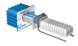
Die Schöck Tronsole Typ Q ist das Trittschalldämmelement für den Anschluss eines gewendelten Treppenlaufs an eine Treppenhauswand. Das integrierte drehbare Trageelement passt sich der Laufneigung an und erleichtert den Einbau. Das besondere Elastomerlager sorgt für einen exzellenten Trittschallschutz. Die komplette Produktpallette ist ab September auf dem Markt erhältlich.
