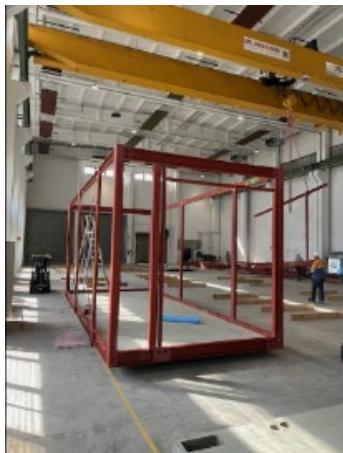
*Testmontage im neuen Daiwa Werk in Fürstenwalde: Der Stahlgerüstrahmen umschließt die Bodenplatte aus Beton. Am unteren horizontalen U-Profil wurden*
