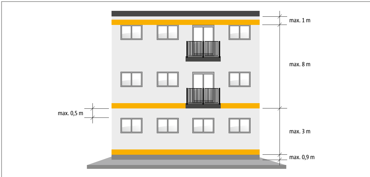
Abb. 1: Anordnung von Balkonen im Brandriegel
