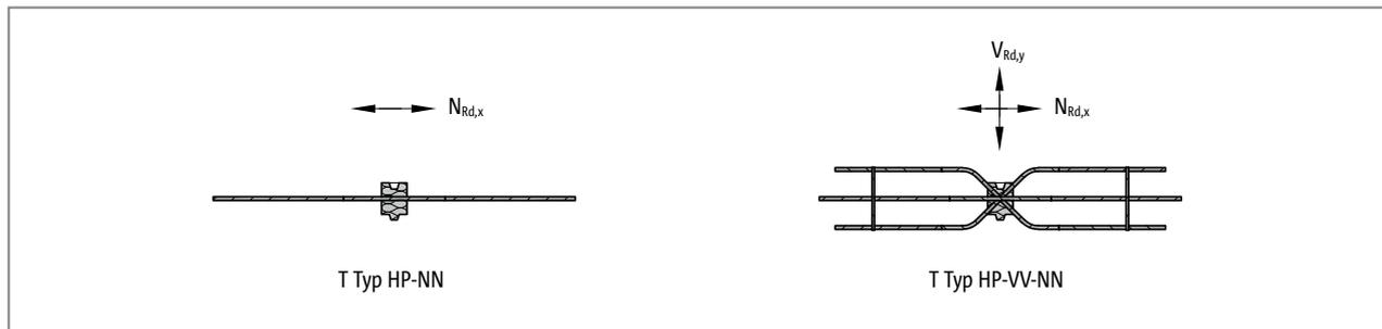
Abb. 20: Schöck Isokorb® T Typ HP: Typenauswahl
