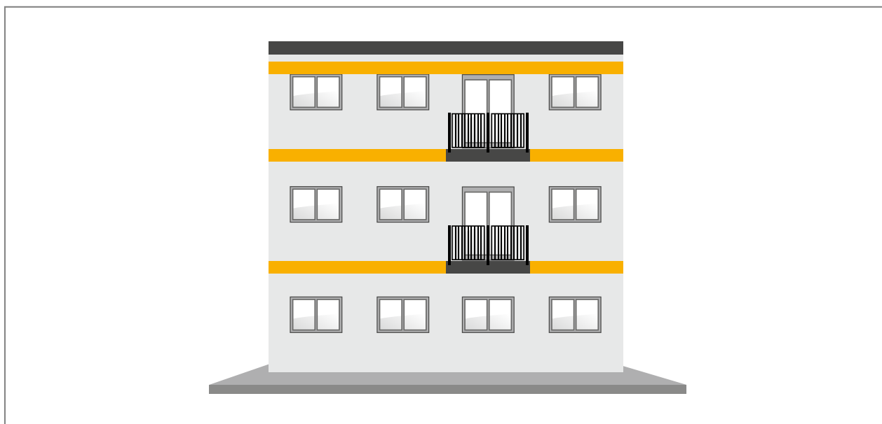
Abb. 2: Anordnung von Balkonen im Brandriegel
