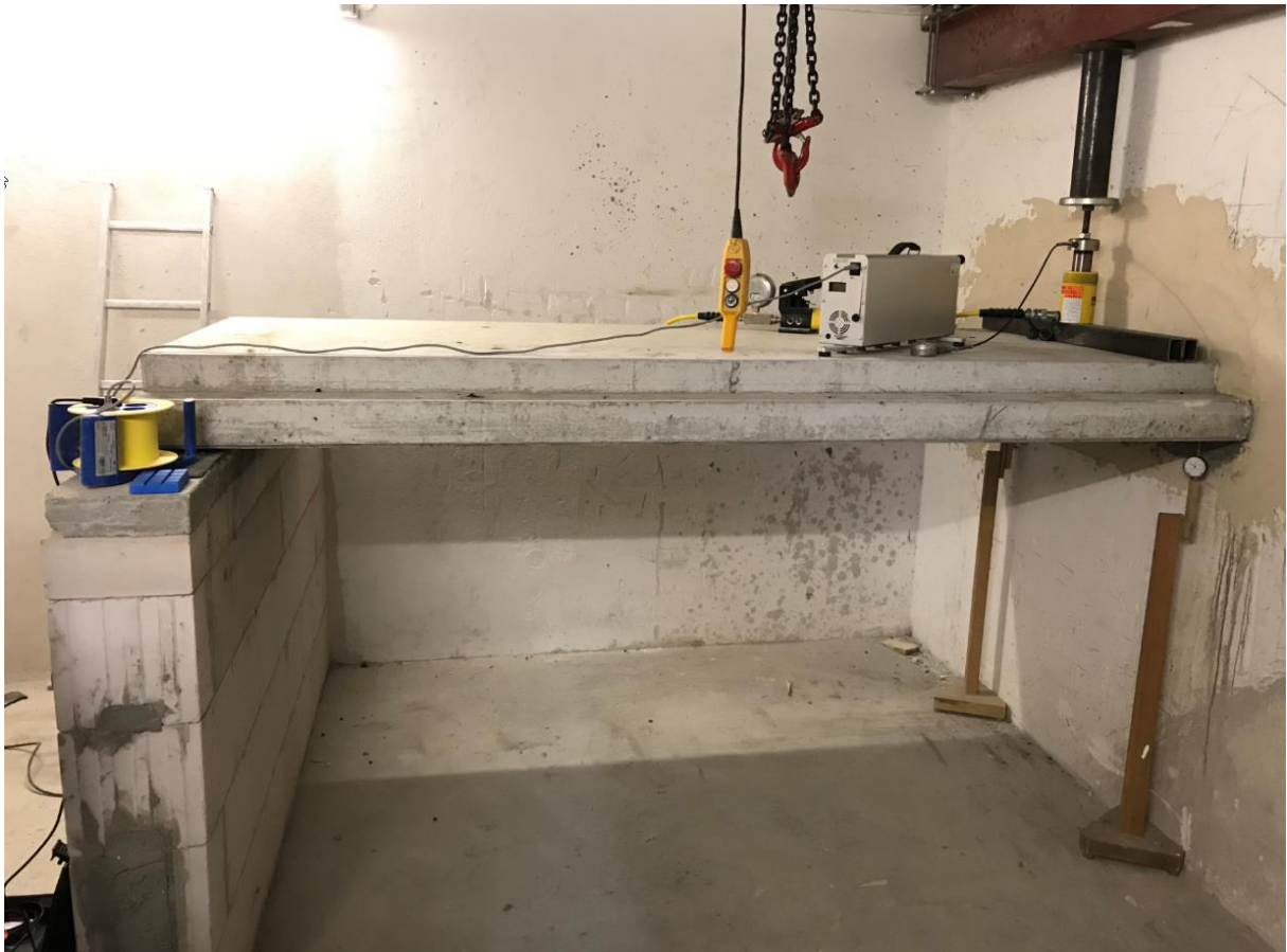
Abbildung 5: Entkoppeltes Referenztreppenpodest Gesamtansicht oben mit Hydraulikstempel zur Aufbringung der Zusatzlasten
