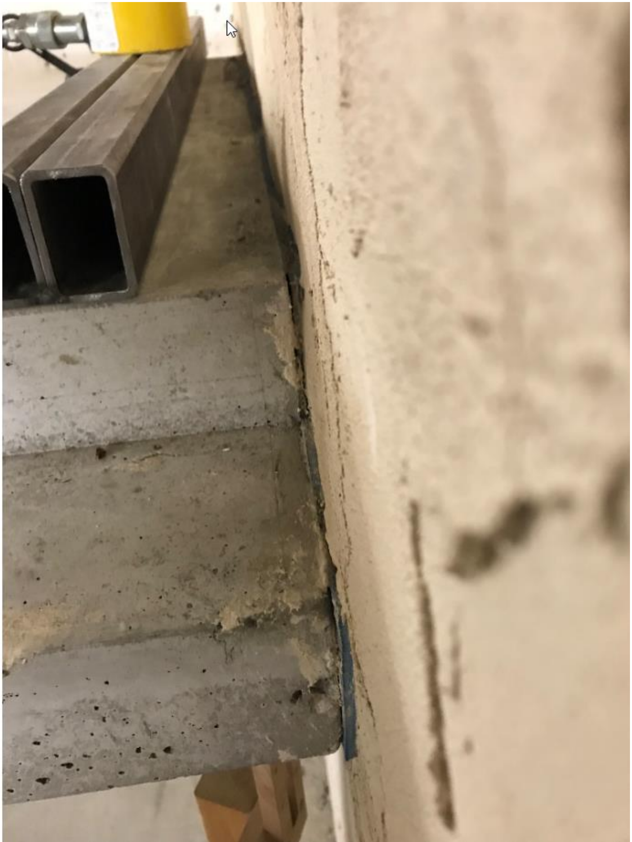
Abbildung 6: Entkoppeltes Referenztreppenpodest mit Schöck Tronsole® Typ Q-FV ( z=1,5 cm) und Schöck Tronsole® Typ L-250
