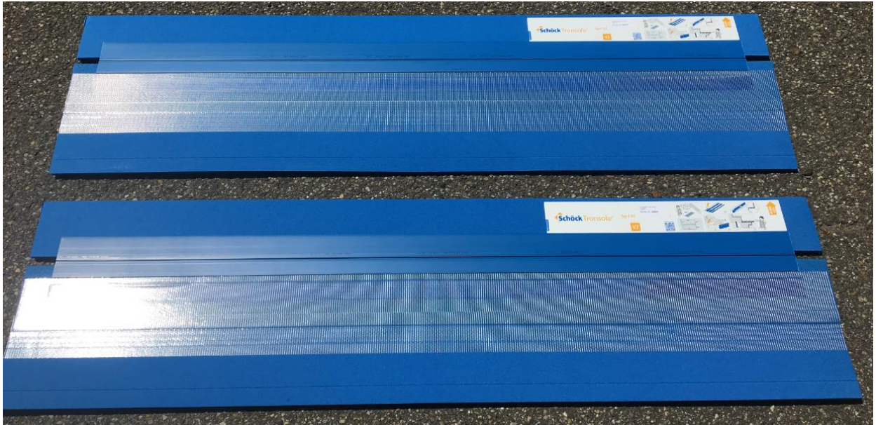
Abbildung 5: Geprüfte Schöck Tronsole® Typ F-V1-L1500 (oben) und Typ F-V2-L1500 (unten)
