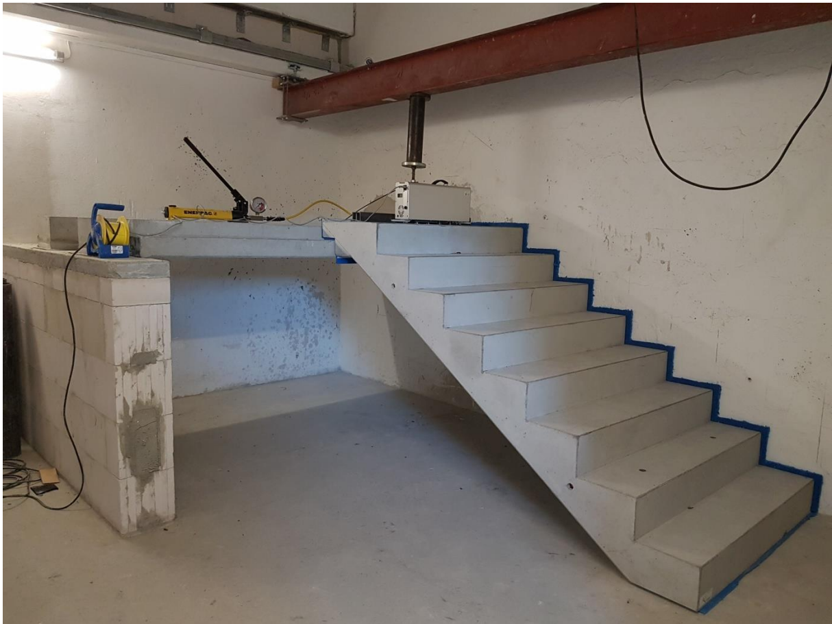
Abbildung 6: Entkoppelter Referenztreppenlauf (Laufbreite 1300 mm) mit Hydraulikpresse zur Aufbringung der Zusatzlasten
