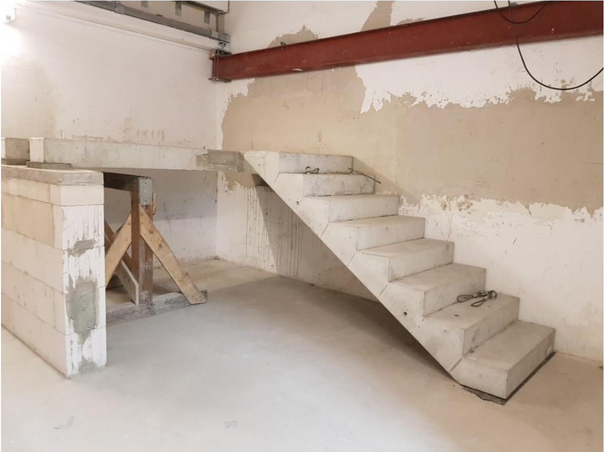
Abbildung 9: Referenztreppenlauf starr an das Referenztreppenpodest angebunden
