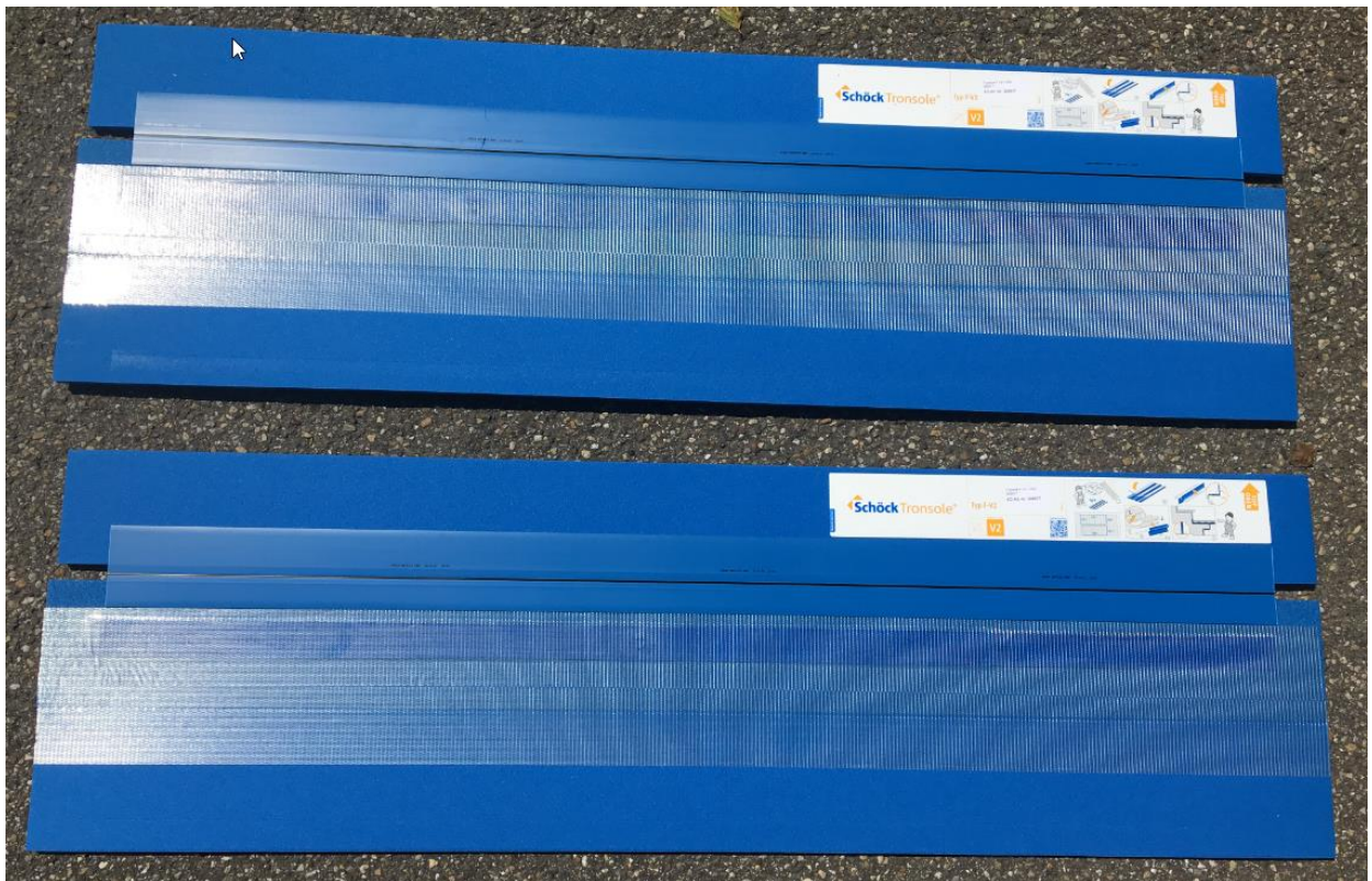
Abbildung 5: Geprüfte Schöck Tronsole® Typ F-V1-L1300 (oben) und Typ F-V2-L1300 (unten)
