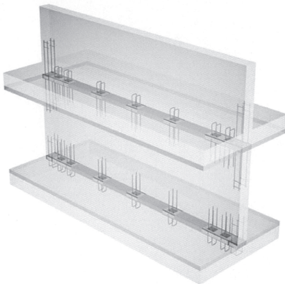
Abbildung 7: Vorgesehene Verwendung des Alphadock-Anschlusselements
