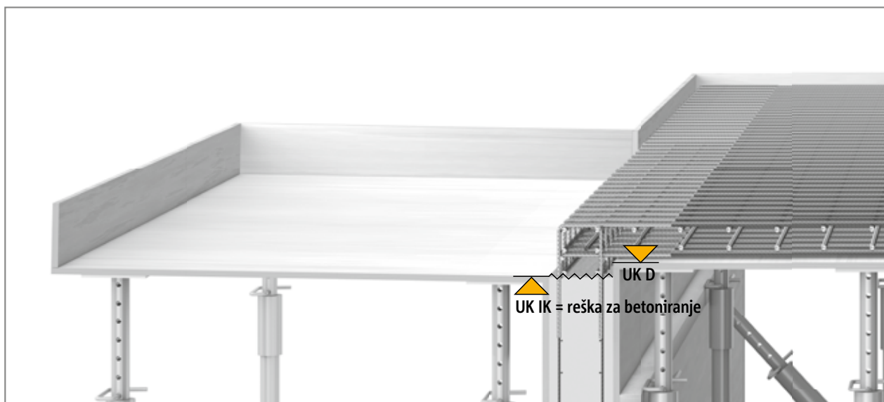
Schöck Isokorb® tip K: Priprema oplata i armature za betoniranje. Završetak zida odozdo (prekid betoniranja) = donji rub oplata balkona
