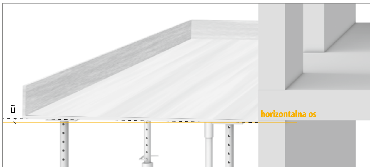
Nadvišenje kod betoniranja
