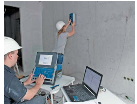
Messung der Körperschall-Nachhallzeit der Treppenhauswand.
