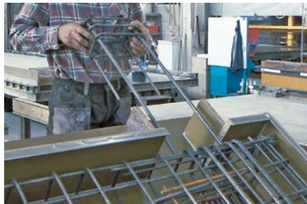
Abb. 1: Treppe schalen, Typ Z Part T einsetzen
