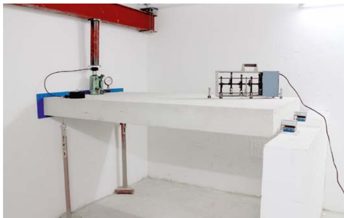
Prüfaufbau mit Tronsole® Typ Z und Typ L für Podestmessung
