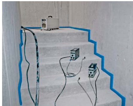
Eingebaute Treppe wird mit Norm-Hammerwerk angeregt.
