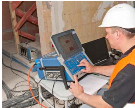
Trittschallmessung der Treppe durch Prüfingenieur.
