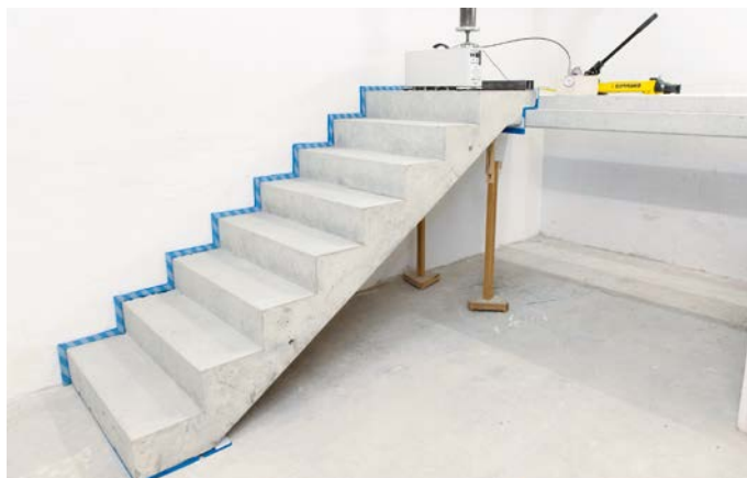
Prüfaufbau mit Tronsole® Typ F und Typ L für Laufmessung
