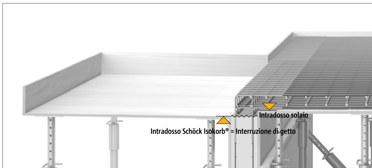
Fig. 41: Schöck Isokorb® T tipo KL: preparazione del cassero e dell'armatura per il getto. Interruzione di getto parete = intradosso balcone!
