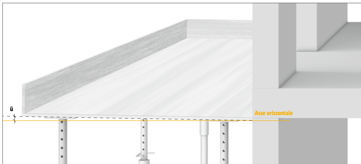
Fig. 25: Controfreccia della cassaforma in fase di getto
