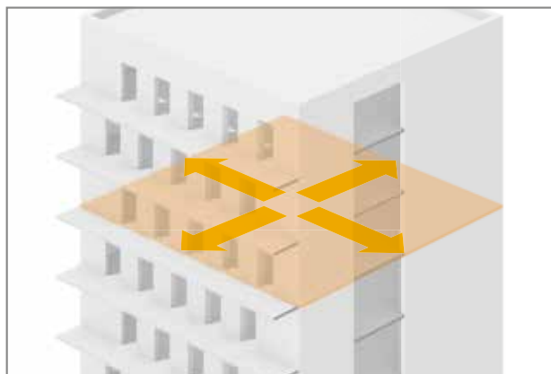
Fig. 14: Direzioni della vibrazione di un edificio in caso di sisma
