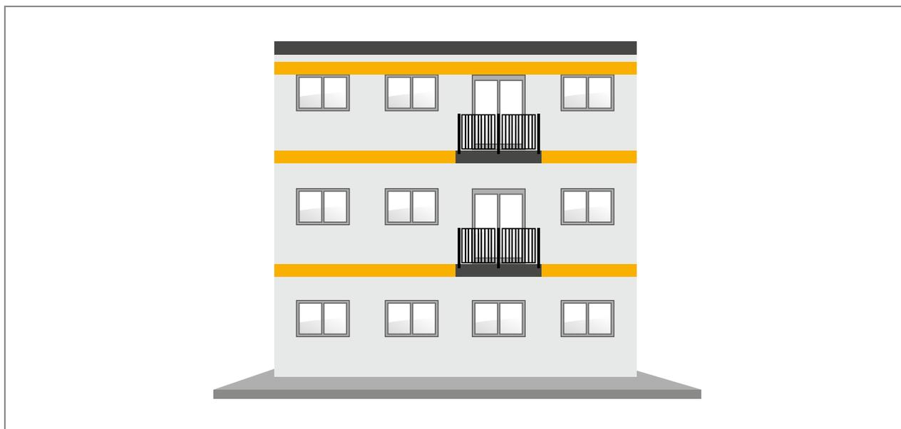
Abb. 2: Anordnung von Balkonen im Brandriegel
