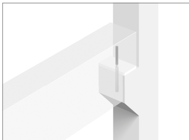
Fig. 16: Schöck Dorn : Stabilité d'appui d'une poutre sur une console
