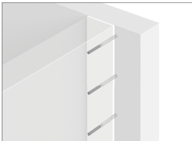
Fig. 11: Schöck Dorn : Liaison mur-mur (face-flanc)
