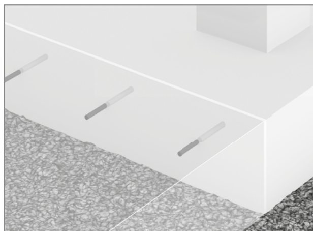
Fig. 14: Schöck Dorn : Joint de dilatation dans la plaque de fondation
