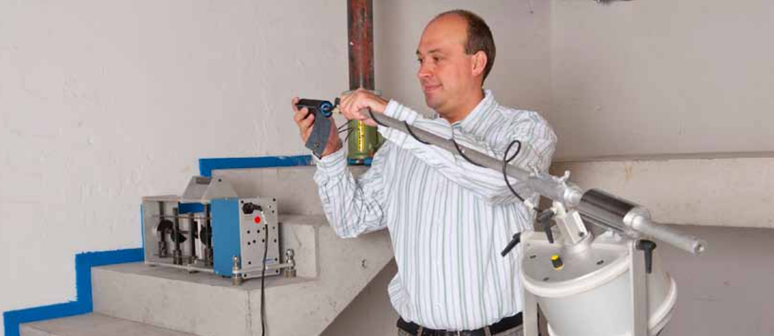
Dipl.-Ing. (FH) Christoph Fichtel, STEP GmbH, bei der Vorbereitung einer Labor-Prüfung im Schalltechnischen Treppenprüfstand.
