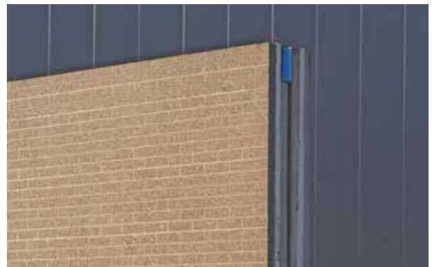
Stap 6: De in de kern geïsoleerde sandwichwand is klaar voor transport naar de werf.
