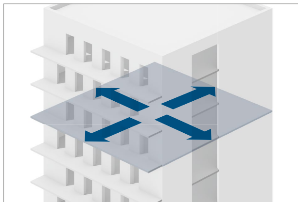
Slika 11: Smjerovi gibanja zgrade kod potresa
