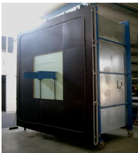
Afbeelding 4.3: Warme zijde proefstand met ingebouwde proefvoorwerpen
