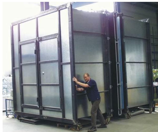
Afbeelding 4.4: Proefstand met koude zijde (links) en warme zijde (rechts)
