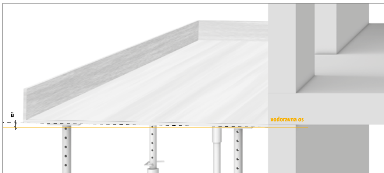
Sl. 25: Nadvišanje opaža pri betoniranju
