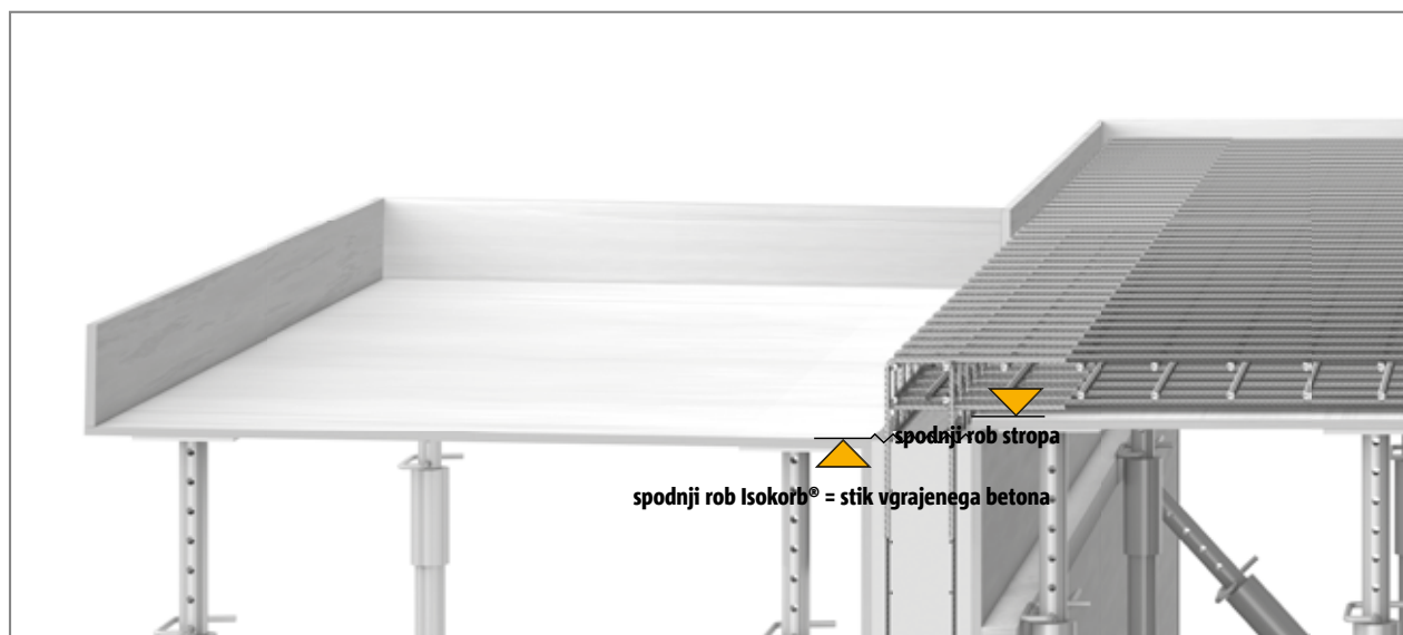
Sl. 41: Schöck Isokorb® T tip KL: priprava opaža in armature za betoniranje. Stik vgrajenega betona na steni = spodnji rob opaža balkona!
