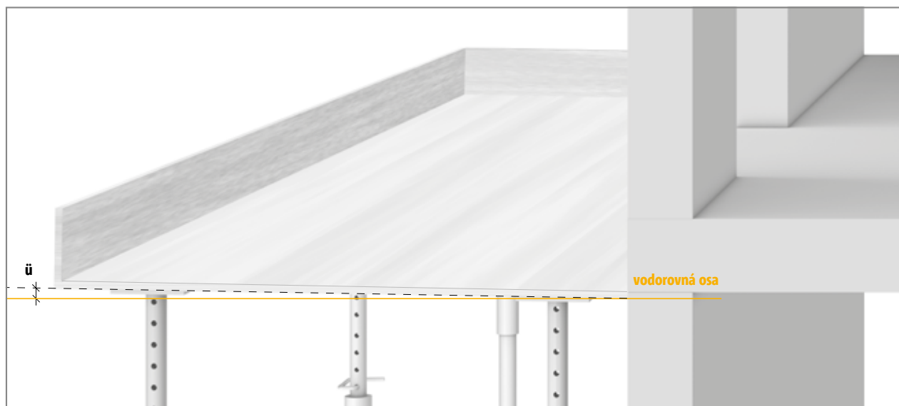
Obr. 25: Nadvýšení bednění při betonování
