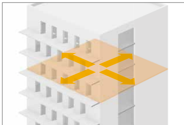
Obr. 14: Směry pohybu budovy při zemětřesení
