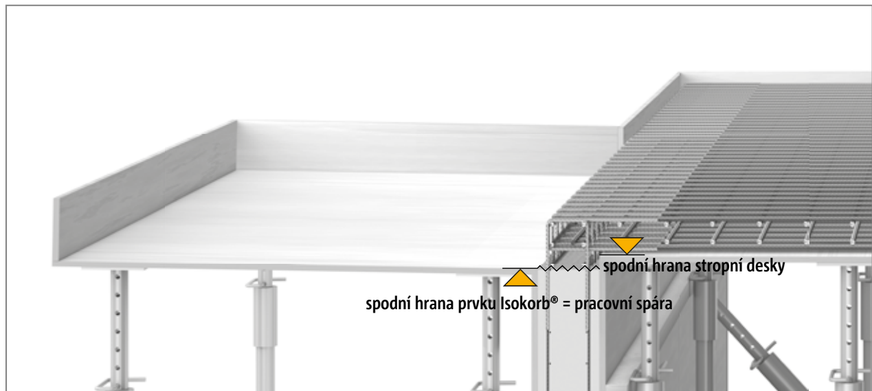
Obr. 41: Schöck Isokorb® T typ KL: Příprava bednění a výztuže před betonáží; úroveň pracovní spáry - stěna = úroveň bednění - spodní hrana balkónové desky!
