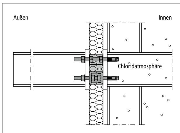
Abb. 239: Schöck Isokorb® T Typ S mit Hutmuttern: Stahlkonstruktion frei auskragend; innen chloridhaltige Atmosphäre
