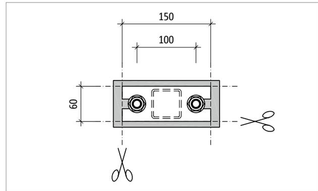
Abb. 258: Schöck Isokorb® T Typ S-V: Maße nach Abschneiden des Dämmkörpers
