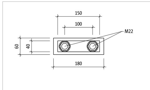
Abb. 248: Schöck Isokorb® T Typ S-N-D22: Produktansicht
