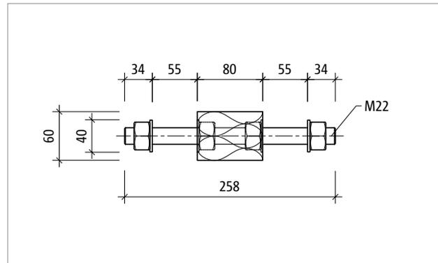
Abb. 246: Schöck Isokorb® T Typ S-N-D22: Produktschnitt
