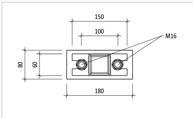
Abb. 253: Schöck Isokorb® T Typ S-V-D16: Produktansicht
