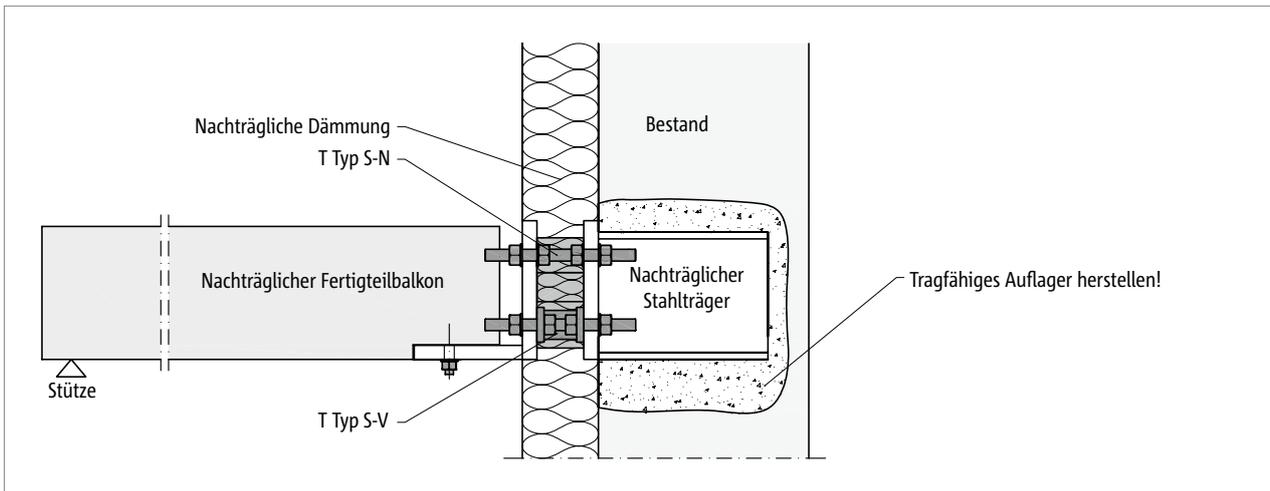
Abb. 272: Schöck Isokorb® T Typ S-N und T Typ S-V: Nachträglicher Fertigteilbalken gestützt; angeschlossen an nachträglich eingebauten Stahlträger
