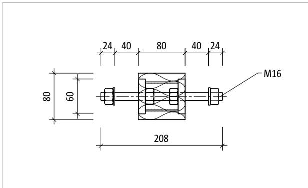
Abb. 251: Schöck Isokorb® T Typ S-V-D16: Produktschnitt
