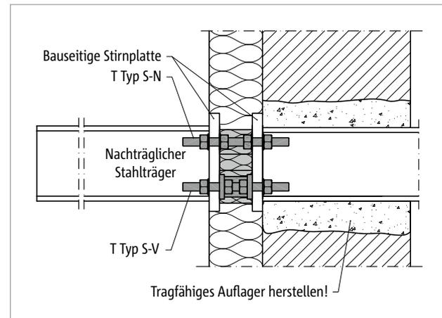
Abb. 238: Schöck Isokorb® T Typ S-N und T Typ S-V: nachträglich montierte frei auskragende Stahlkonstruktion; weitere Beispiele zur Sanierung siehe Seite 196
