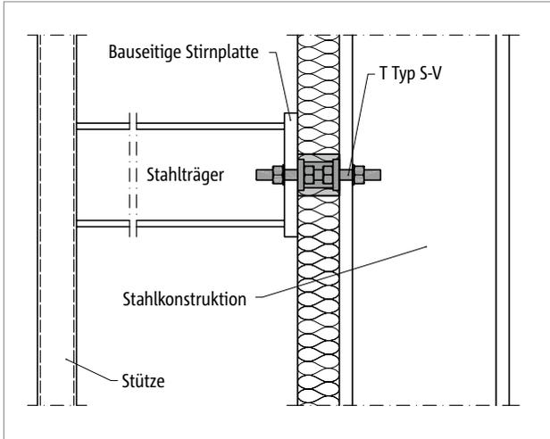
Abb. 229: Schöck Isokorb® T Typ S-V: Stahlkonstruktion gestützt
