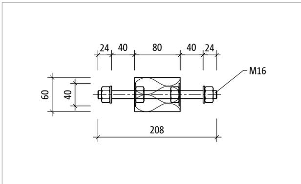
Abb. 245: Schöck Isokorb® T Typ S-N-D16: Produktschnitt
