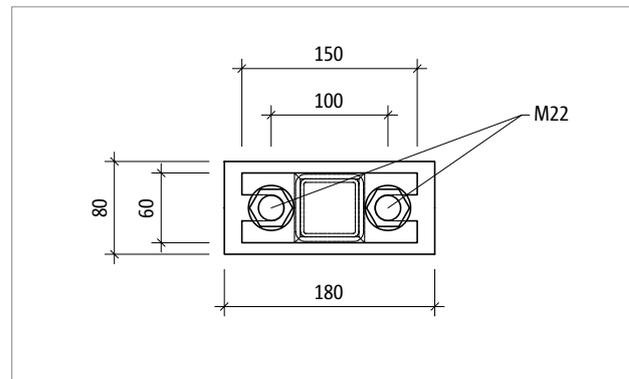
Abb. 254: Schöck Isokorb® T Typ S-V-D22: Produktansicht
