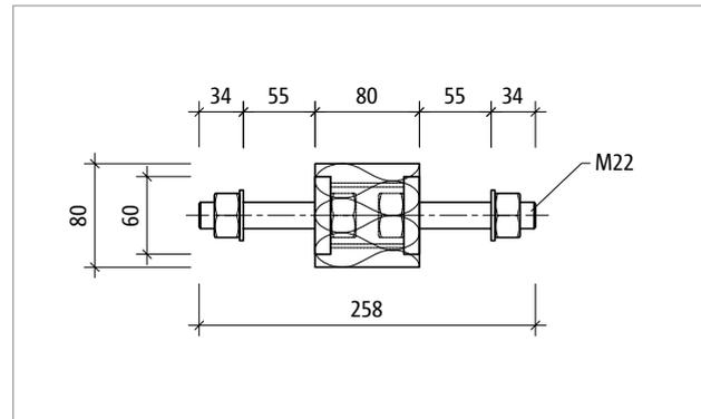
Abb. 252: Schöck Isokorb® T Typ S-V-D22: Produktschnitt
