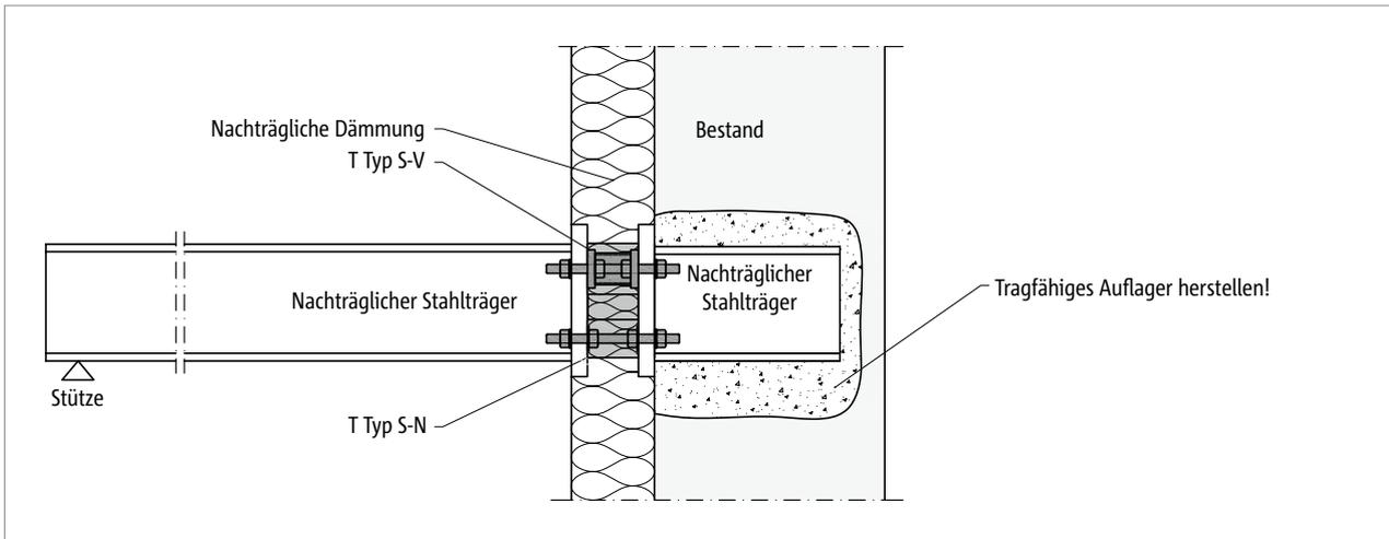
Abb. 271: Schöck Isokorb® T Typ S-N und T Typ S-V: Nachträglicher Stahlbalken gestützt; angeschlossen an nachträglich eingebautes Wandauflager
