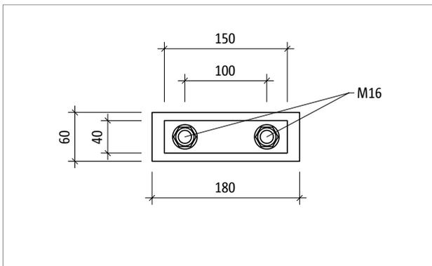
Abb. 247: Schöck Isokorb® T Typ S-N-D16: Produktansicht
