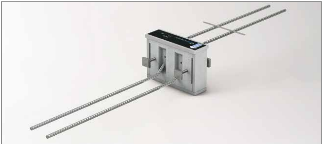
Ilustr. 4: Schöck Isokorb® T typu QP: Wersja przeciwpożarowa z dookoła zamontowanymi płytami ogniochronnymi
