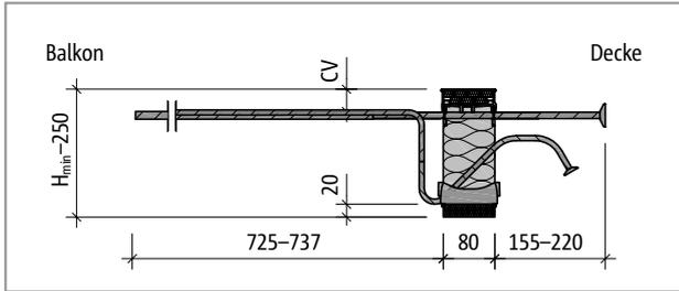
Abb. 119: Schöck Isokorb® T Typ K-U-M2: Produktschnitt
