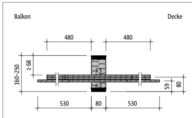
Abb. 282: Schöck Isokorb® T Typ H-VV2-NN1: Produktschnitt
