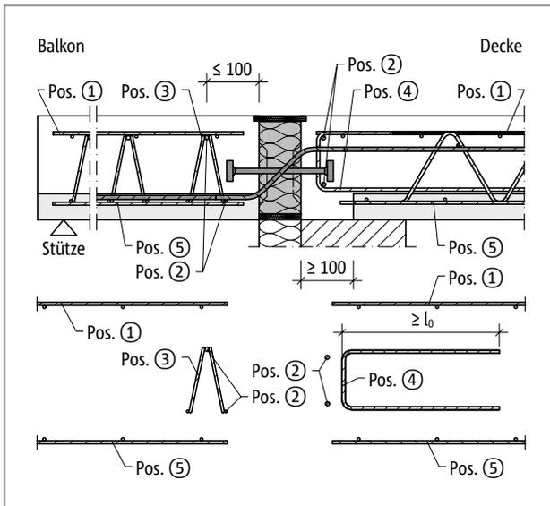
Abb. 231: Schöck Isokorb® T Typ Q-P: Bauseitige Bewehrung mit Gitterträger
