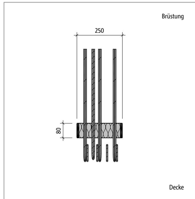
Abb. 333: Schöck Isokorb® T Typ A-MM2 bei REI120: Produktschnitt; Brandschutzplatten seitlich
