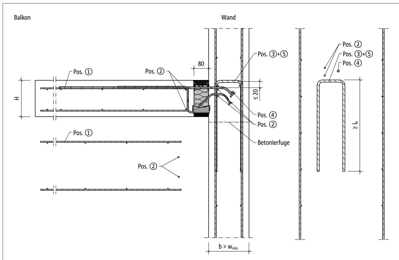
Abb. 135: Schöck Isokorb® T Typ K-O: Bauseitige Bewehrung für Wandanschluss mit größerer Bauteilabmessung ( $w_{vorh} > w_{min}$ )
