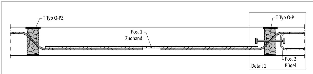
Abb. 239: Schöck Isokorb® T Typ Q-PZ, Q-P: Schnitt A-A; Bewehrungsanschluss Zugband
