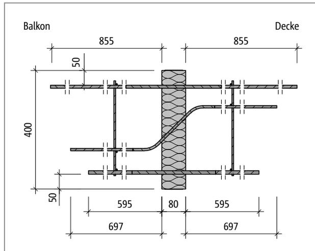
Abb. 374: Schöck Isokorb® T Typ B-M1-VB1: Produktschnitt
