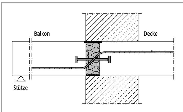
Abb. 206: Schöck Isokorb® T Typ Q-P: Anschluss gestützter Balkon bei einschaligem, wärmedämmendem Mauerwerk
