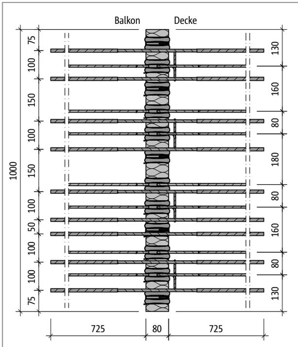
Abb. 58: Schöck Isokorb® T Typ K-M8-V1: Produktgrundriss
