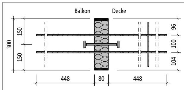
Abb. 223: Schöck Isokorb® T Typ Q-P-V1: Produktgrundriss
