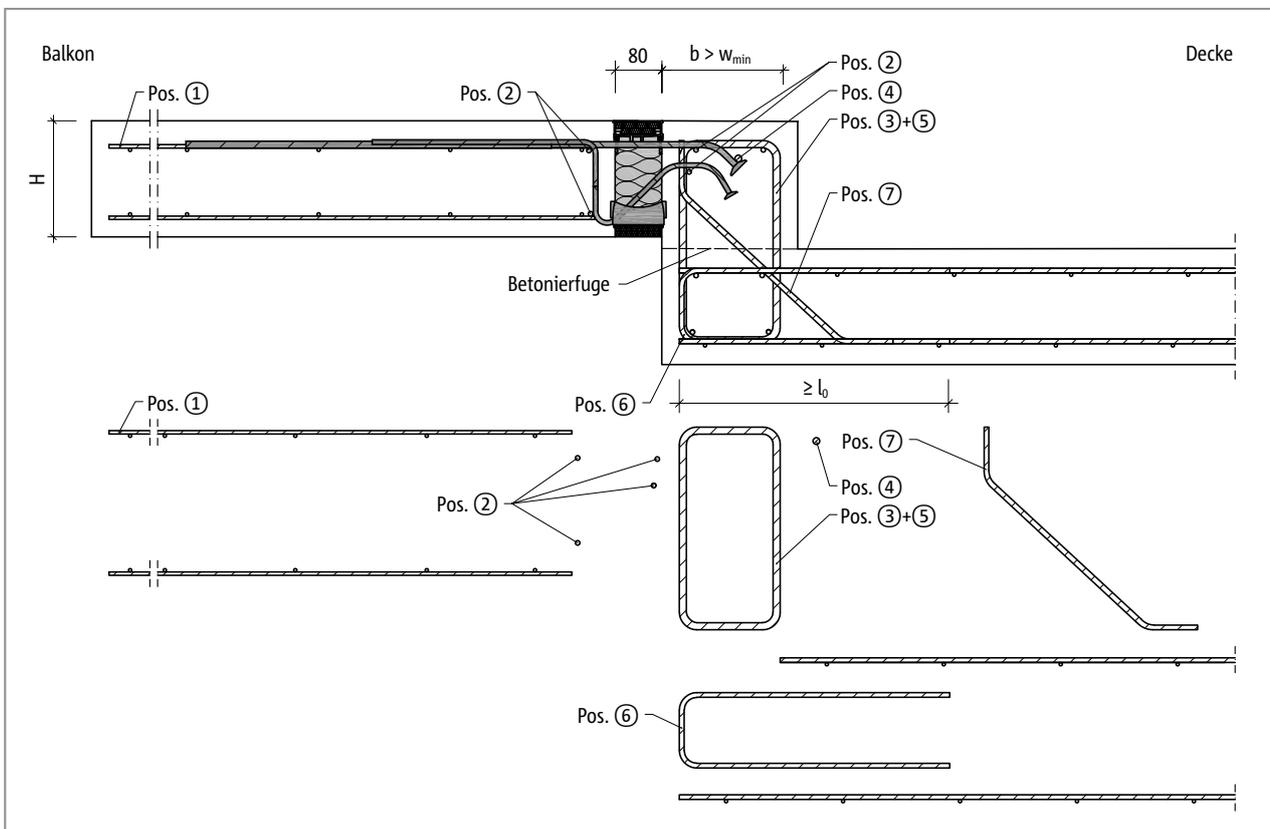
Abb. 133: Schöck Isokorb® T Typ K-O-F: Bauseitige Bewehrung für Balkon mit Höhenversatz nach oben mit größerer Bauteilabmessung ( $w_{vorh} > w_{min}$ )
