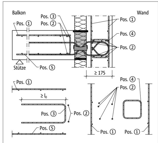
Abb. 187: Schöck Isokorb® T Typ Q-VV1 bis Q-VV5: Bauseitige Bewehrung in Wand
