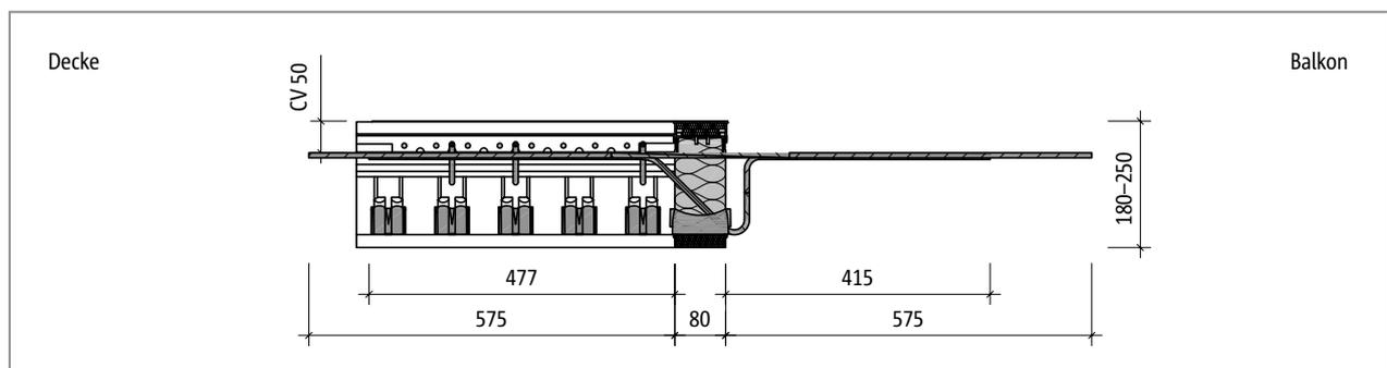
Abb. 251: Schöck Isokorb® T Typ C-M1: Produktschnitt
