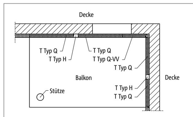
Abb. 268: Schöck Isokorb® T Typ H: Balkon zweiseitig aufliegend mit Stütze
