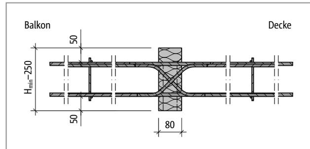
Abb. 312: Schöck Isokorb® T Typ D bei R0-CV50: Produktschnitt
