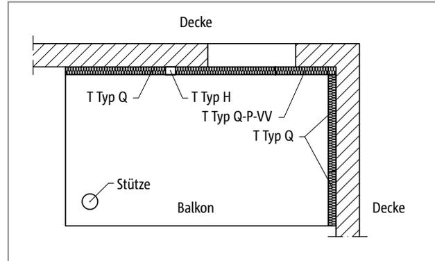
Abb. 202: Schöck Isokorb® T Typ Q, Q-P-VV: Balkon zweiseitig gelagert mit Stütze und abhebenden Querkräften
