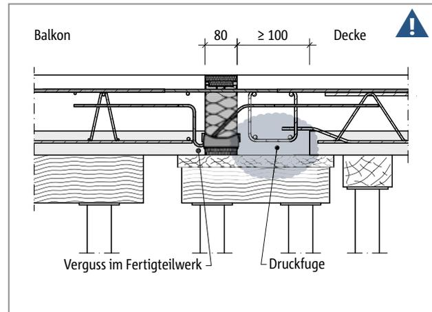
Abb. 95: Schöck Isokorb® T Typ K-F: Einbau in Verbindung mit Elementplatten (hier:  $h \leq 170$  mm), indirekte Lagerung, Druckfuge deckenseitig
