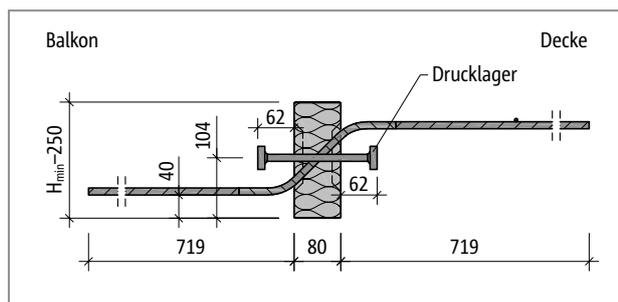
Abb. 227: Schöck Isokorb® T Typ Q-P bei R0: Produktschnitt
