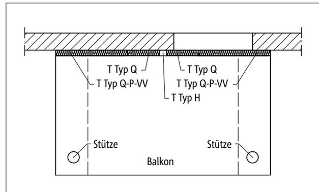
Abb. 204: Schöck Isokorb® T Typ Q-P-VV, Q: Balkon mit Stützenlagerung, Anschluss bei unterschiedlichen Auflagersteifigkeiten; optional mit T Typ H
