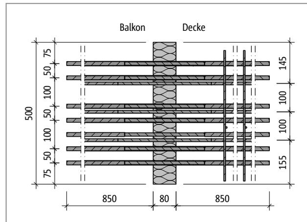
Abb. 63: Schöck Isokorb® T Typ K-M13-V1: Produktgrundriss
