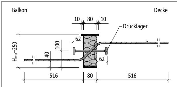
Abb. 215: Schöck Isokorb® T Typ Q-P-V5: Produktschnitt
