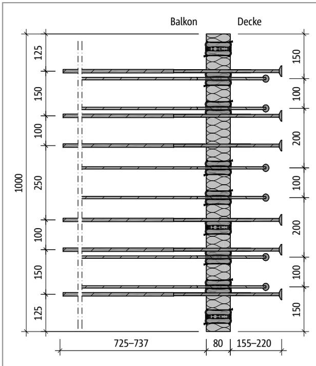
Abb. 121: Schöck Isokorb® T Typ K-U-M2: Produktgrundriss
