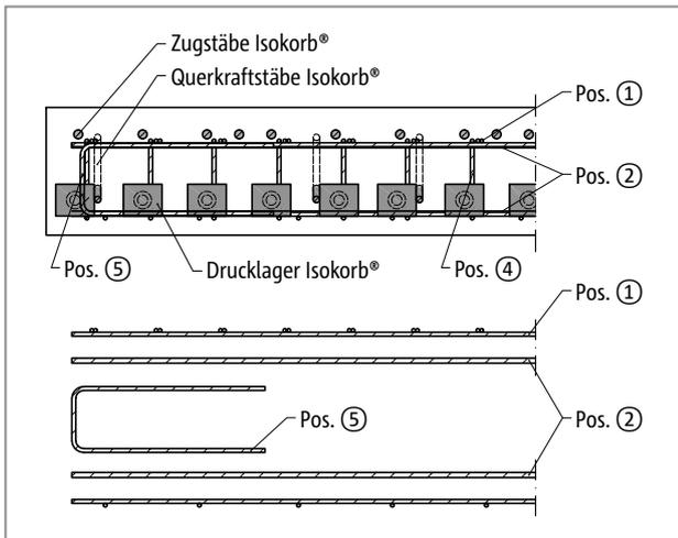
Abb. 75: Schöck Isokorb® T Typ K-M12: Bauseitige Bewehrung balkonseitig im Schnitt A-A; Pos.5 = konstruktive Randeinfassung am freien Rand senkrecht zum Schöck Isokorb®
