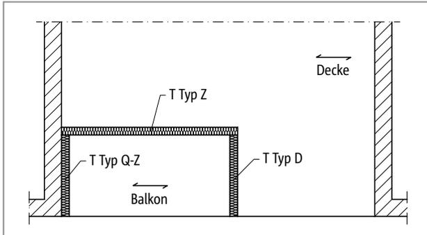
Abb. 301: Schöck Isokorb® T Typ D, QZ, Z: Decke einachsig gespannt
