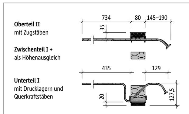
Abb. 140: Schöck Isokorb® T Typ K-O-F-M1-V1-CV35 bis K-O-F-M3-V1-CV35
