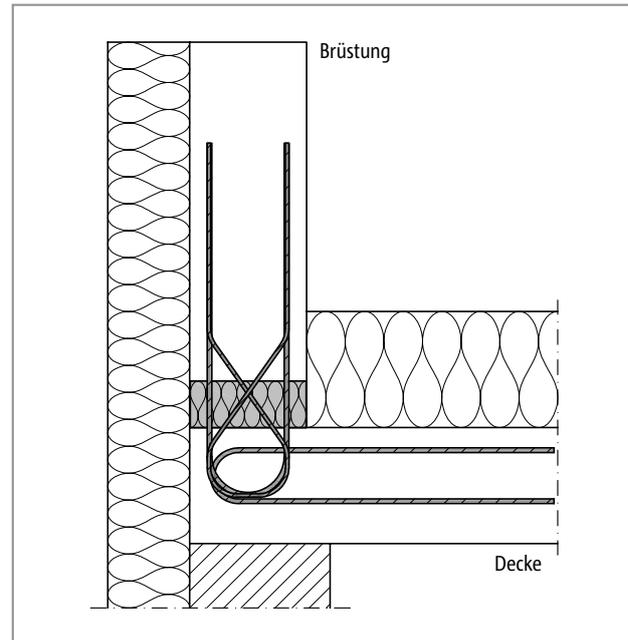
Abb. 318: Schöck Isokorb® T Typ A: Anschluss einer Brüstung (T Typ A-MM2)
