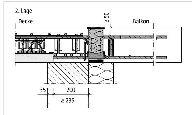
Abb. 262: Schöck Isokorb® T Typ C: Elementplatte ohne Randunterstützung mit WDV5 (Schnitt T Typ C-CV50-2. Lage, Ansicht T Typ C-CV35-1. Lage)
