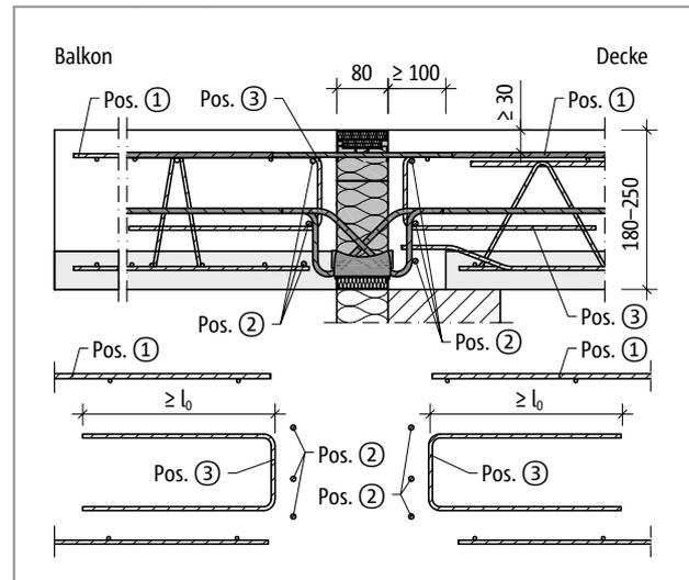
Abb. 90: Schöck Isokorb® T Typ K-F-VV: Bauseitige Bewehrung bei Balkonplattendicke  $h = 180-250$  mm
