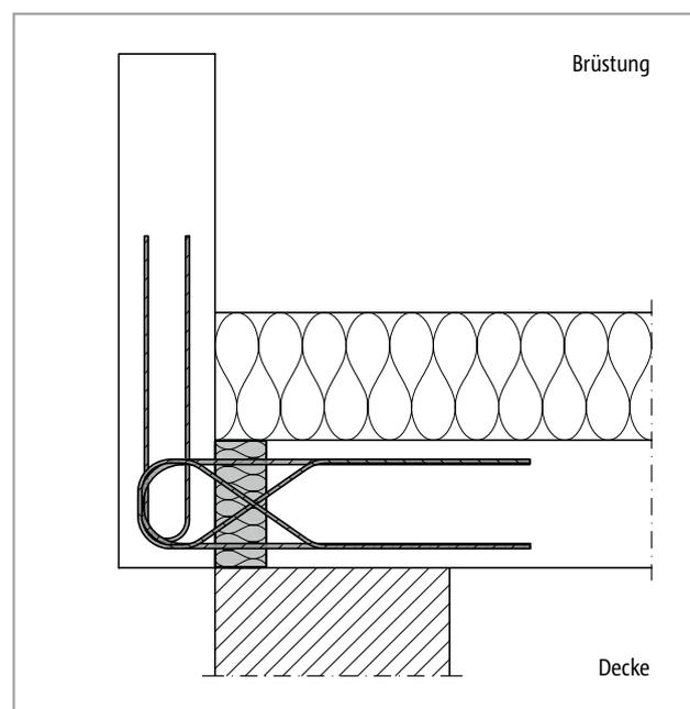
Abb. 338: Schöck Isokorb® T Typ F: Anschluss einer frontal angeschlossenen Brüstung bei wärmedämmendem Mauerwerk
