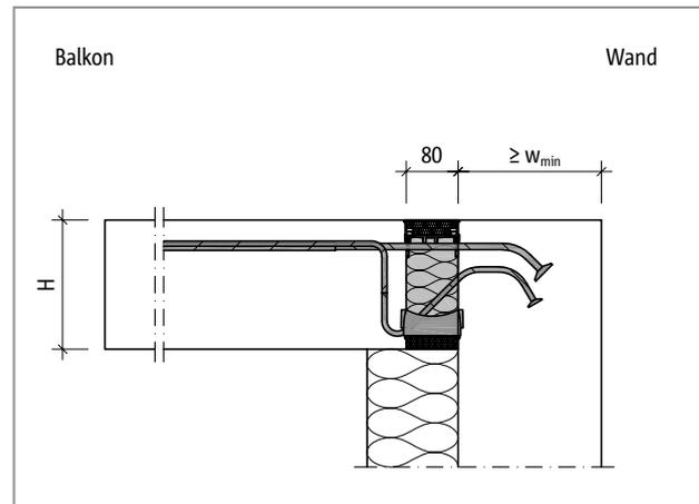
Abb. 113: Schöck Isokorb® T Typ K-O: Wandanschluss nach unten bei Außen-dämmung
