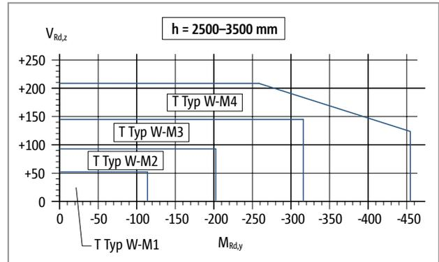
Abb. 382: Schöck Isokorb® T Typ W: Interaktionsdiagramm
