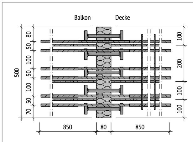
Abb. 62: Schöck Isokorb® T Typ K-M12-V1: Produktgrundriss
