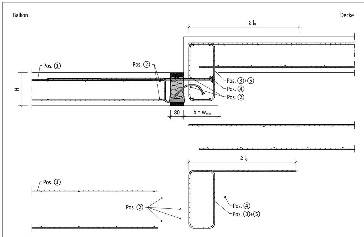
Abb. 128: Schöck Isokorb® T Typ K-U: Bauseitige Bewehrung für Balkon mit Höhenversatz nach unten mit minimaler Bauteilabmessung ( $w_{vorh} = w_{min}$ )
