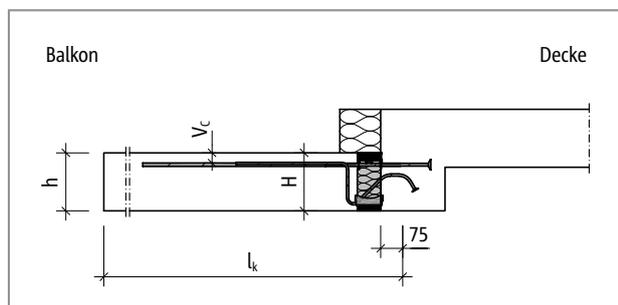
Abb. 114: Schöck Isokorb® T Typ K-U: Statisches System
