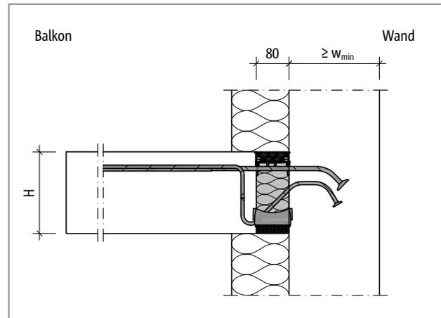
Abb. 111: Schöck Isokorb® T Typ K-O: Wandanschluss nach unten bei Außen-dämmung
