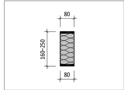
Abb. 296: Schöck Isokorb® T Typ Z-EI120: Produktschnitt
