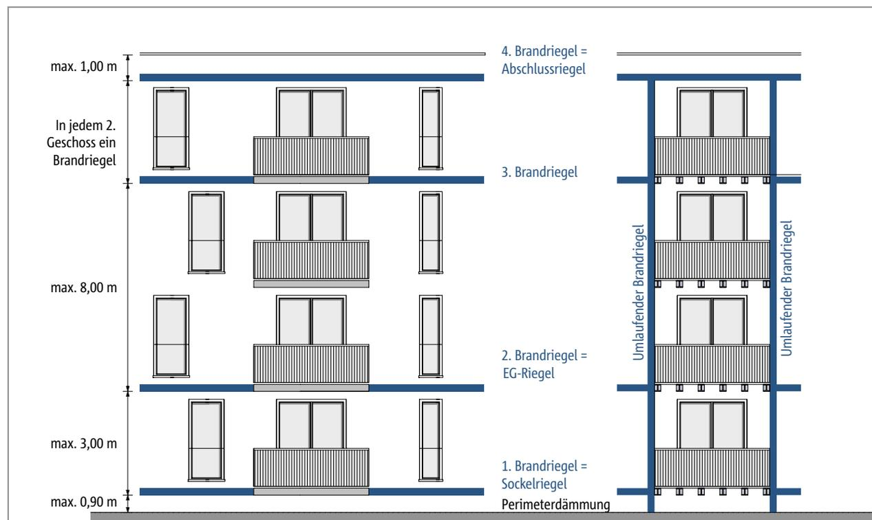
Abb. 13: Mögliche Anordnung von Brandriegeln im WDVS
