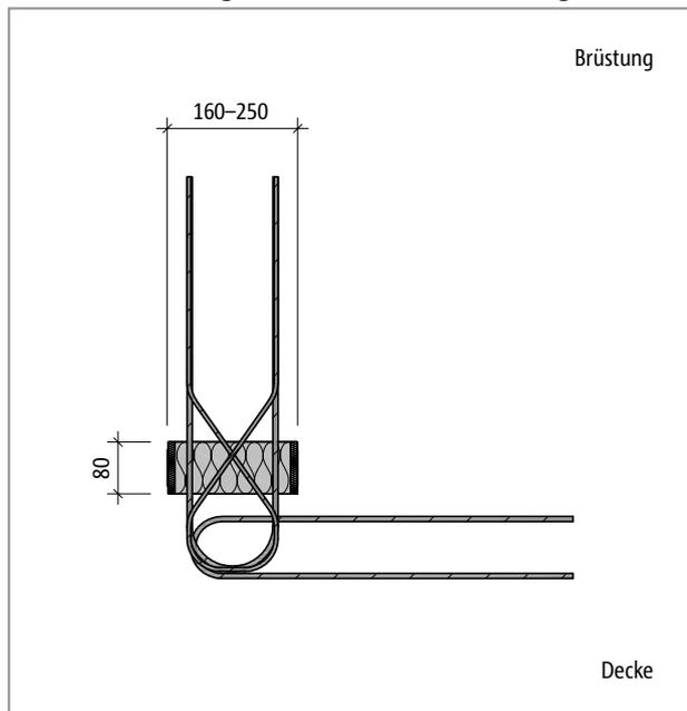
Abb. 332: Schöck Isokorb® T Typ A-MM2 bei REI120: Produktansicht; Brandschutzplatten seitlich
