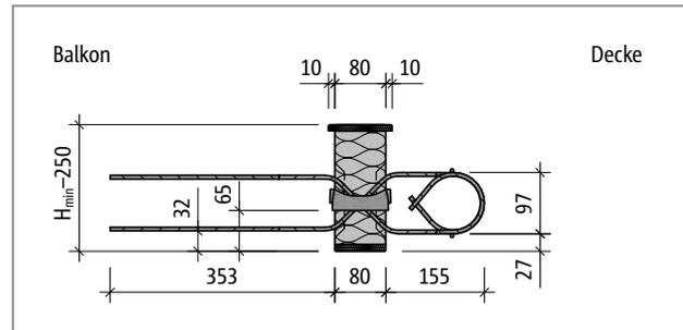
Abb. 173: Schöck Isokorb® T Typ Q-VV1 bis Q-VV5: Produktschnitt
