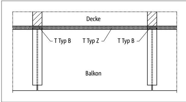
Abb. 365: Schöck Isokorb® T Typ B: Balkonkonstruktion mit frei auskragenden Unterzügen (Fertigteilebalkon)
