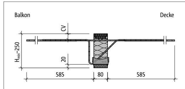
Abb. 53: Schöck Isokorb® T Typ K-M5 und K-M6: Produktschnitt
