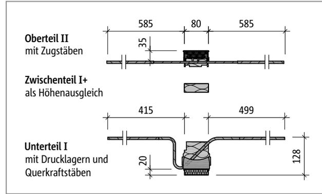
Abb. 84: Schöck Isokorb® T Typ K-F-M1-V2-CV35 bis K-F-M6-V2-CV35
