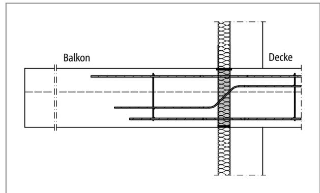
Abb. 368: Schöck Isokorb® T Typ B: Balkonkonstruktion mit frei auskragenden Unterzügen
