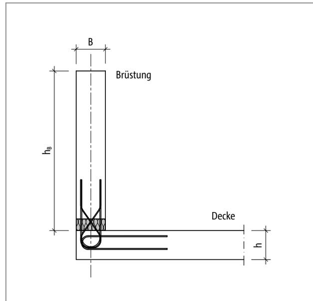
Abb. 320: Schöck Isokorb® T Typ A: Statisches System
