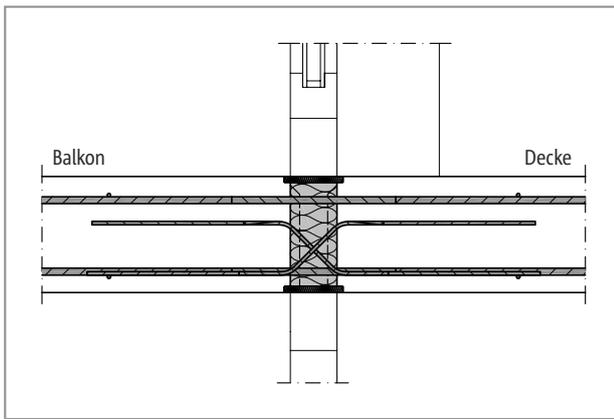
Abb. 303: Schöck Isokorb® T Typ D: Einbauschritt; einachsig gespannte Decke
