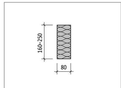
Abb. 300: Schöck Isokorb® T Typ Z-EI0: Produktschnitt
