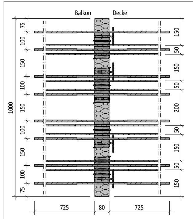
Abb. 59: Schöck Isokorb® T Typ K-M6-VV1: Produktgrundriss
