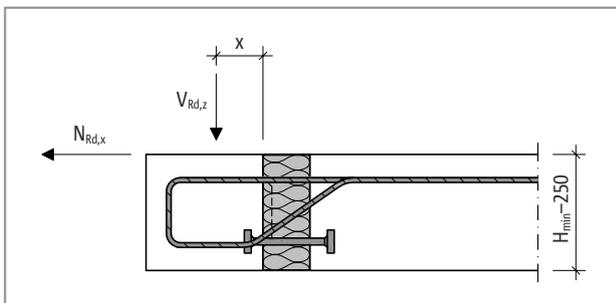
Abb. 355: Schöck Isokorb® T Typ O: Abstand des Lasteinleitungspunktes  $x$  (Lastabstand)
