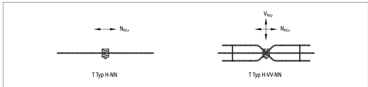
Abb. 271: Schöck Isokorb® T Typ H: Typenauswahl
