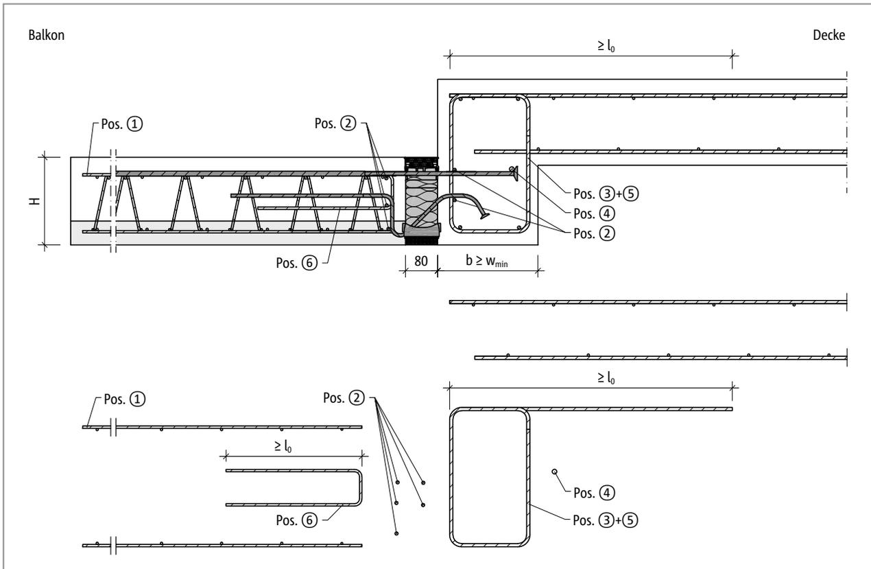
Abb. 142: Schöck Isokorb® T Typ K-U-F: Bauseitige Bewehrung für Balkon mit Höhenveratz nach unten
