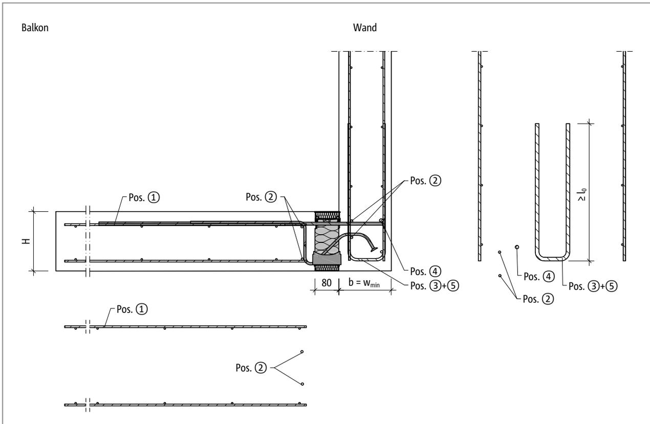
Abb. 130: Schöck Isokorb® T Typ K-U: Bauseitige Bewehrung für Wandanschluss mit minimaler Bauteilabmessung ( $w_{vorh} = w_{min}$ )
