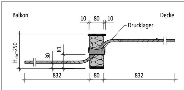
Abb. 172: Schöck Isokorb® T Typ Q-V12: Produktschnitt
