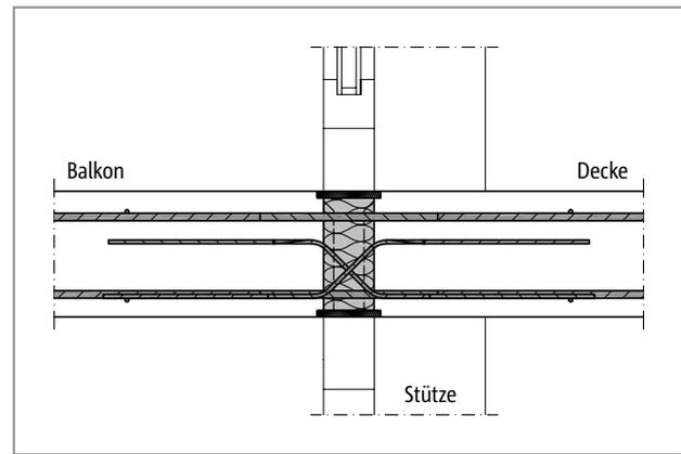
Abb. 304: Schöck Isokorb® T Typ D: Einbauschritt; Flachdecke
