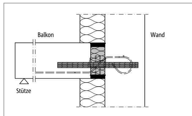
Abb. 270: Schöck Isokorb® T Typ Q, H-VV-NN: Anschluss an einer Stahlbetonwand mit Außendämmung
