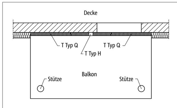
Abb. 265: Schöck Isokorb® T Typ H: Balkon mit Stützenlagerung
