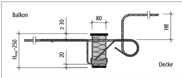
Abb. 97: Schöck Isokorb® T Typ K-HV: Produktschnitt
