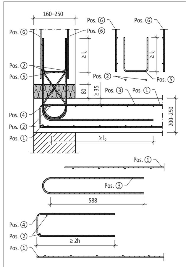
Abb. 335: Schöck Isokorb® T Typ A: Bauseitige Bewehrung außenliegend
