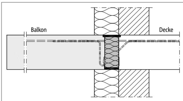
Abb. 293: Schöck Isokorb® T Typ Z, K: Wärmedämmverbundsystem (WDVS)
