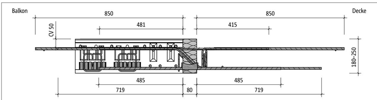
Abb. 254: Schöck Isokorb® T Typ C-M2: Produktschnitt
