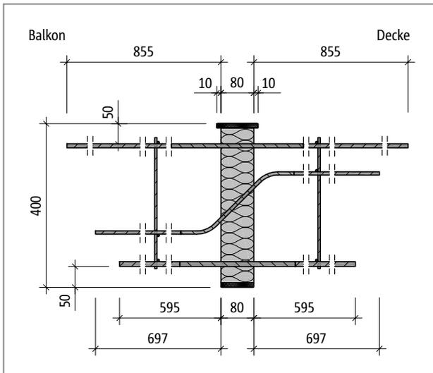
Abb. 371: Schöck Isokorb® T Typ B-M1: Produktschnitt
