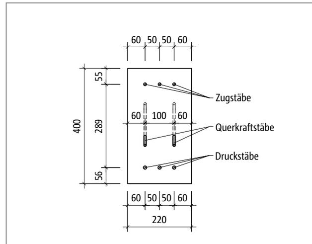
Abb. 375: Schöck Isokorb® T Typ B bei R0: Produktansicht
