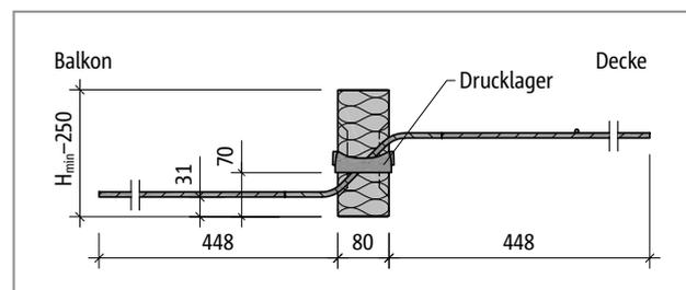
Abb. 181: Schöck Isokorb® T Typ Q-V6 bei R0: Produktschnitt
