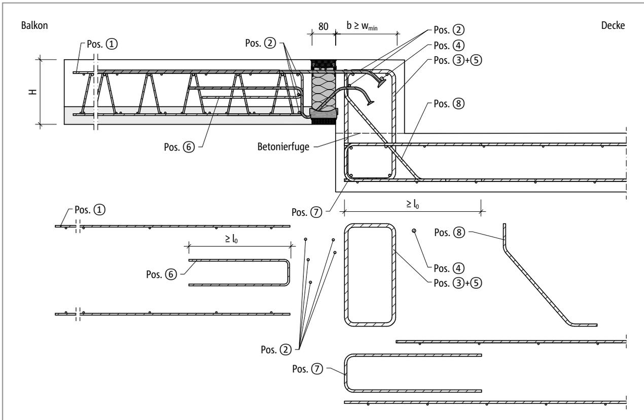
Abb. 144: Schöck Isokorb® T Typ K-O-F: Bauseitige Bewehrung für Balkon mit Höhenversatz nach oben
