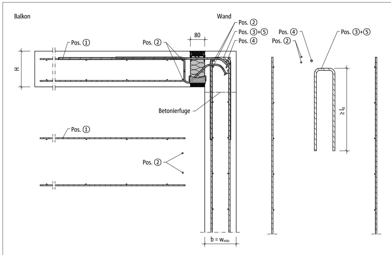
Abb. 134: Schöck Isokorb® T Typ K-O: Bauseitige Bewehrung für Wandanschluss nach unten mit minimaler Bauteilabmessung ( $w_{vorh} = w_{min}$ )
