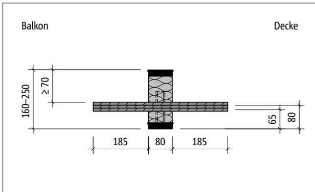
Abb. 280: Schöck Isokorb® T Typ H-VV1-NN1: Produktschnitt
