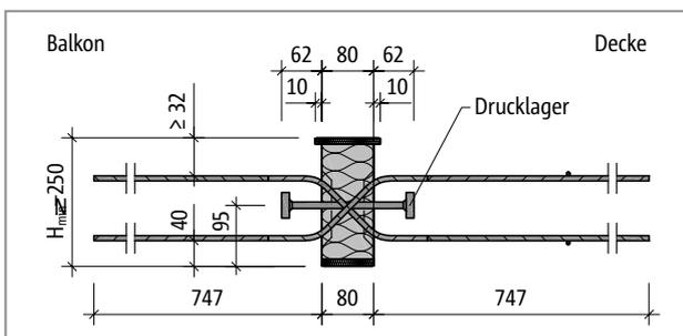
Abb. 221: Schöck Isokorb® T Typ Q-P-VV8 bis Q-P-VV9: Produktschnitt
