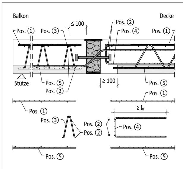
Abb. 235: Schöck Isokorb® T Typ Q-P: Bauseitige Bewehrung mit Gitterträger
