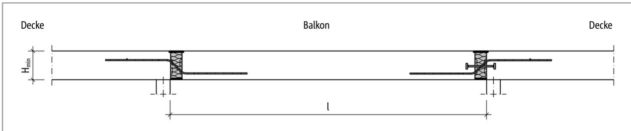
Abb. 209: Schöck Isokorb® T Typ Q-PZ, Q-P: Statisches System
