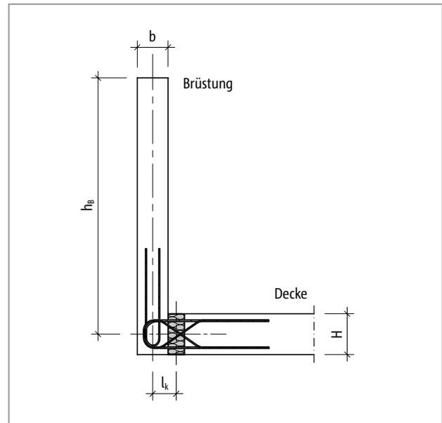
Abb. 340: Schöck Isokorb® T Typ F: Statisches System
