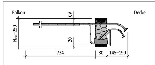
Abb. 124: Schöck Isokorb® T Typ K-O-M4: Produktschnitt
