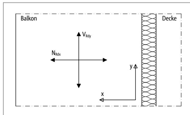
Abb. 272: Schöck Isokorb® T Typ H: Vorzeichenregel für die Bemessung
