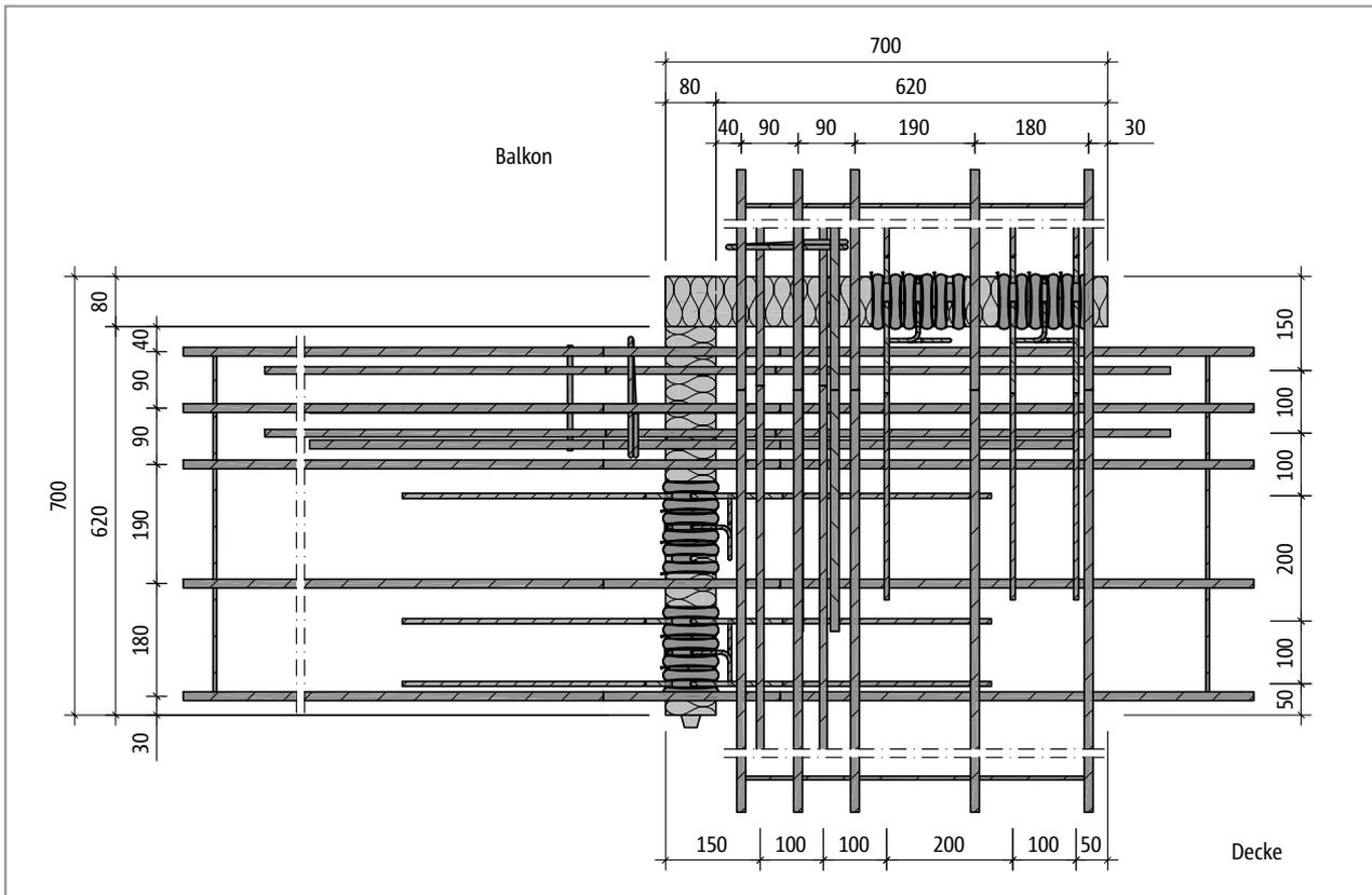
Abb. 252: Schöck Isokorb® T Typ C-M2: Produktgrundriss
