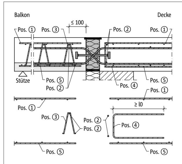
Abb. 232: Schöck Isokorb® T Typ Q-P-VV: Bauseitige Bewehrung, balkonseitig mit Gitterträger
