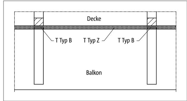
Abb. 366: Schöck Isokorb® T Typ B: Balkonkonstruktion mit frei auskragenden Unterzügen
