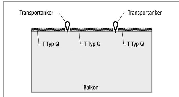
Abb. 288: Schöck Isokorb® T Typ Q: Elementbalkon mit Transportanker; Dämmzwischenstück T Typ Z kann bauseitig eingelegt werden
