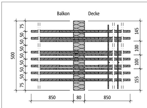
Abb. 64: Schöck Isokorb® T Typ K-M14-V1: Produktgrundriss
