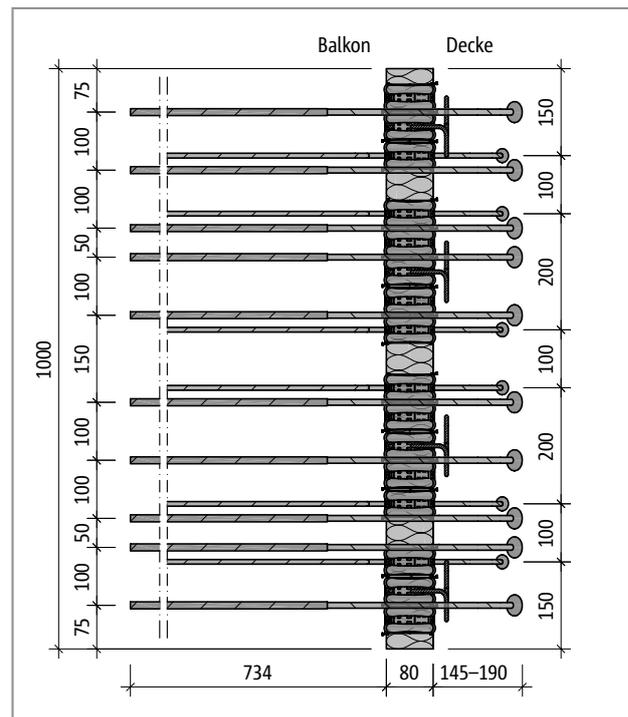
Abb. 126: Schöck Isokorb® T Typ K-O-M4: Produktgrundriss
