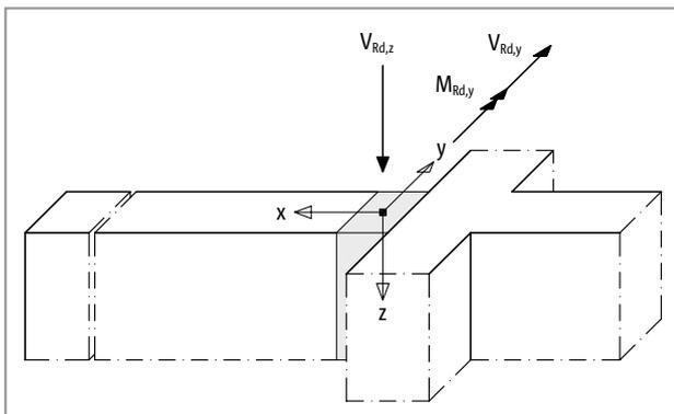
Abb. 379: Schöck Isokorb® T Typ W: Vorzeichenregel für die Bemessung
