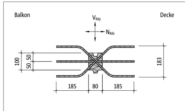
Abb. 281: Schöck Isokorb® T Typ H-VV1-NN1: Produktgrundriss
