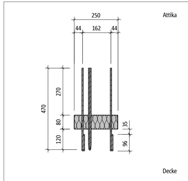
Abb. 325: Schöck Isokorb® T Typ A-MM1-X80: Produktansicht
