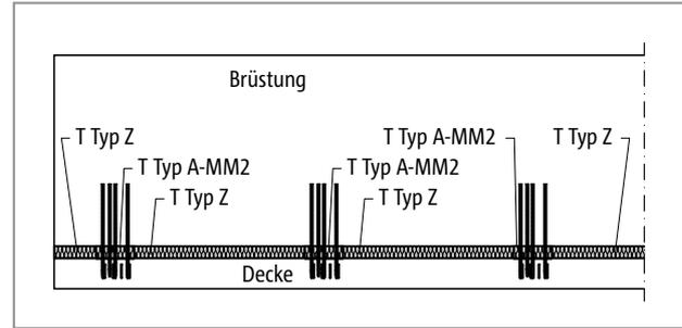
Abb. 316: Schöck Isokorb® T Typ A, Z: Brüstung (T Typ A-MM2)
