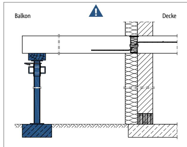
Abb. 200: Schöck Isokorb® T Typ Q: Stützung durchgängig erforderlich
