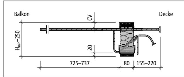
Abb. 120: Schöck Isokorb® T Typ K-U-M4: Produktschnitt
