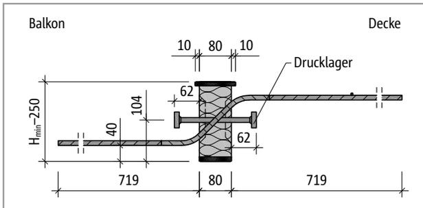
Abb. 217: Schöck Isokorb® T Typ Q-P-V7: Produktschnitt
