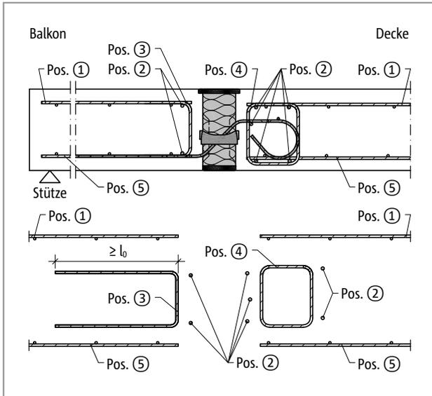
Abb. 190: Schöck Isokorb® T Typ Q-V1 bis Q-V5: Bauseitige Bewehrung
