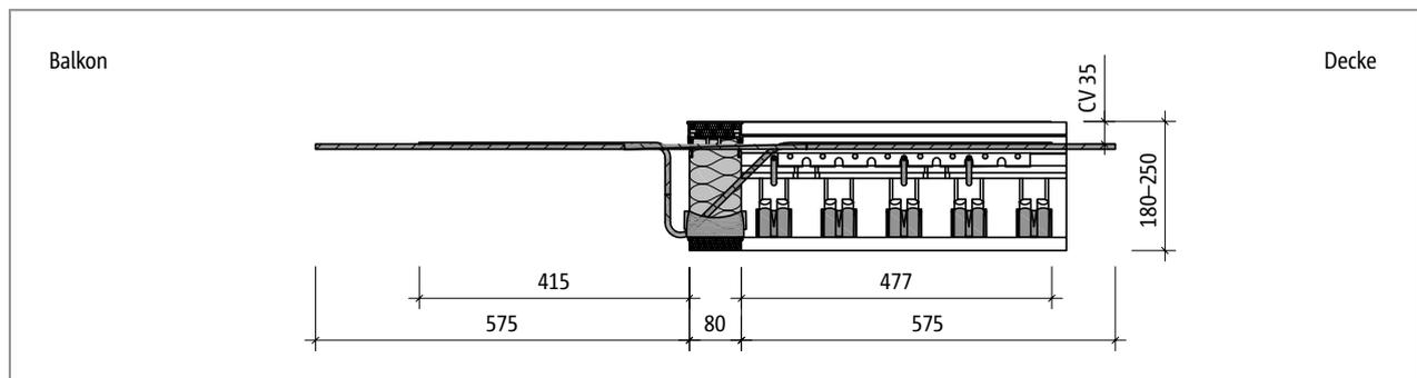
Abb. 250: Schöck Isokorb® T Typ C-M1: Produktschnitt
