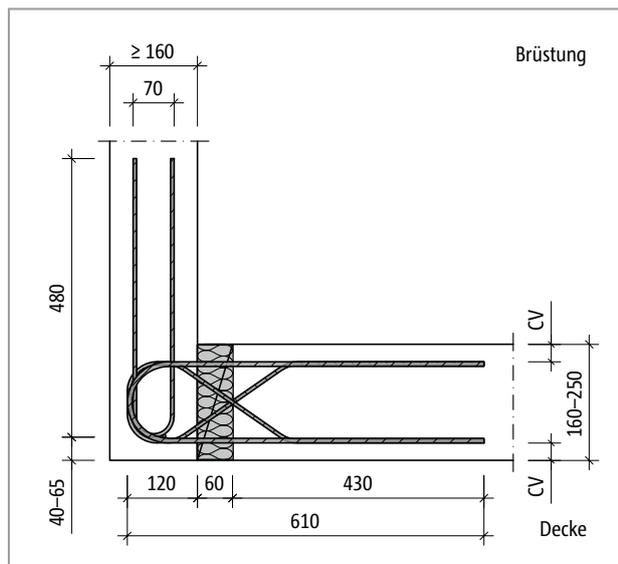
Abb. 346: Schöck Isokorb® T Typ F-X60: Produktschnitt
