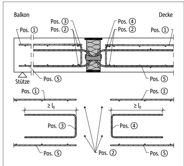
Abb. 193: Schöck Isokorb® T Typ Q-VV6 bis Q-VV12: Bauseitige Bewehrung
