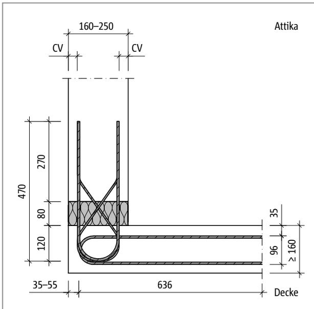
Abb. 324: Schöck Isokorb® T Typ A-MM1-X80: Produktschnitt
