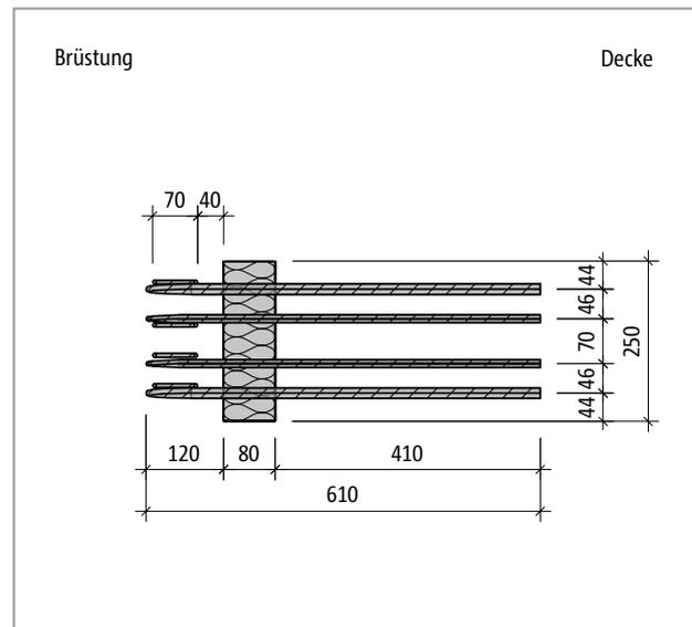
Abb. 345: Schöck Isokorb® T Typ F-X80: Produktgrundriss
