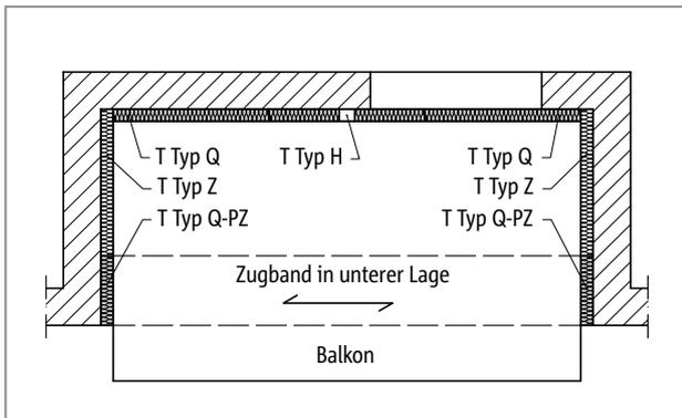
Abb. 203: Schöck Isokorb® T Typ Q, Q-PZ: Dreiseitig gelagerte Loggia - symmetrisch mit Zugband
