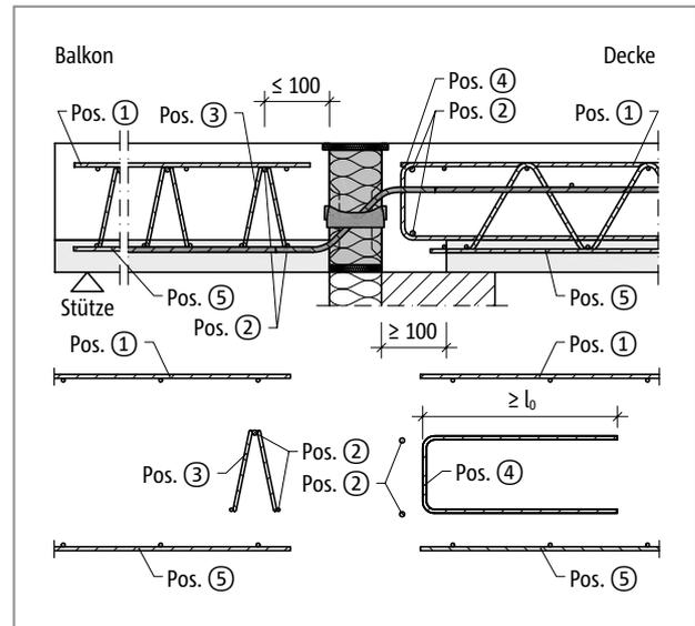
Abb. 189: Schöck Isokorb® T Typ Q-V6 bis Q-V12: Bauseitige Bewehrung mit Gitterträger
