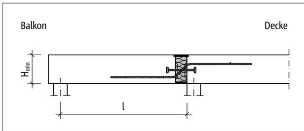
Abb. 208: Schöck Isokorb® T Typ Q-P: Statisches System
