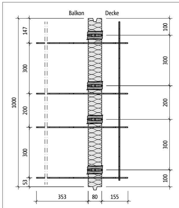
Abb. 178: Schöck Isokorb® T Typ Q-V1: Produktgrundriss
