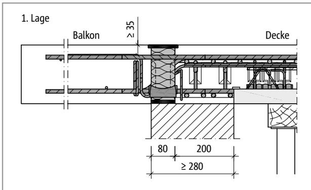
Abb. 263: Schöck Isokorb® T Typ C: Elementplatte mit Randunterstützung mit wärmedämmendem Mauerwerk (Schnitt T Typ C-CV35-1. Lage, Ansicht T Typ C-CV50-2. Lage)
