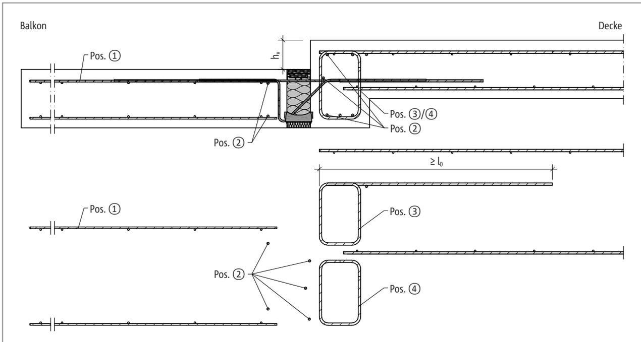
Abb. 127: Schöck Isokorb® T Typ K: Bauseitige Bewehrung für kleinen Höhenversatz
