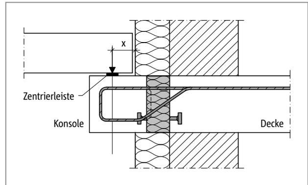
Abb. 353: Schöck Isokorb® T Typ O: Anschluss einer Konsole als Deckenaufleger; Zentrierleisten verhindern eine Verschiebung des Lasteinleitungspunktes
