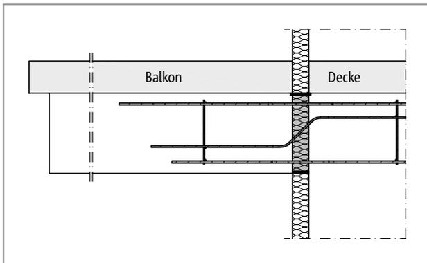
Abb. 367: Schöck Isokorb® T Typ B: Balkonkonstruktion mit frei auskragenden Unterzügen (Fertigteilebalkon)
