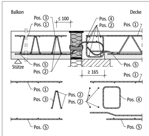
Abb. 188: Schöck Isokorb® T Typ Q-V1 bis Q-V5: Bauseitige Bewehrung mit Gitterträger
