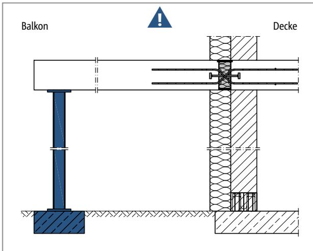
Abb. 241: Schöck Isokorb® T Typ Q-P-VV: Stützung durchgängig erforderlich
