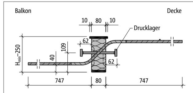
Abb. 218: Schöck Isokorb® T Typ Q-P-V8 bis Q-P-V9: Produktschnitt
