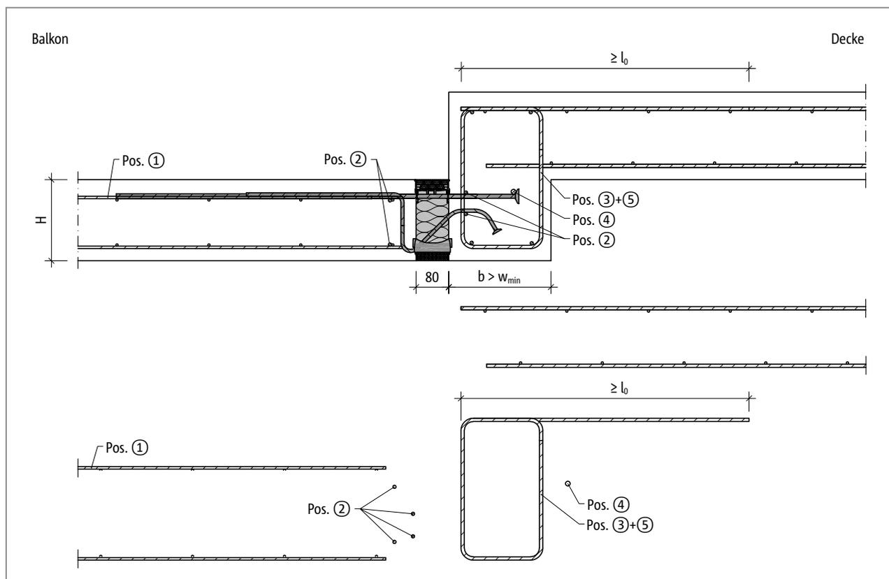
Abb. 129: Schöck Isokorb® T Typ K-U: Bauseitige Bewehrung für Balkon mit Höhenversatz nach unten mit größerer Bauteilabmessung ( $w_{vorh} > w_{min}$ )
