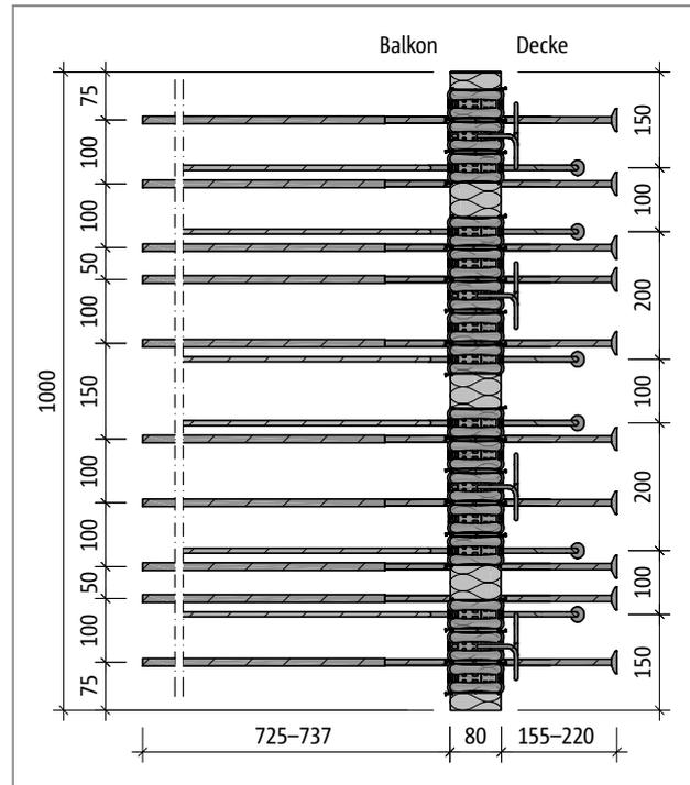
Abb. 122: Schöck Isokorb® T Typ K-U-M4: Produktgrundriss
