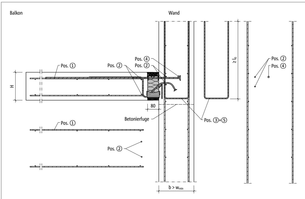
Abb. 131: Schöck Isokorb® T Typ K-U: Bauseitige Bewehrung für Wandanschluss nach oben mit größerer Bauteilabmessung ( $w_{vorh} > w_{min}$ )
