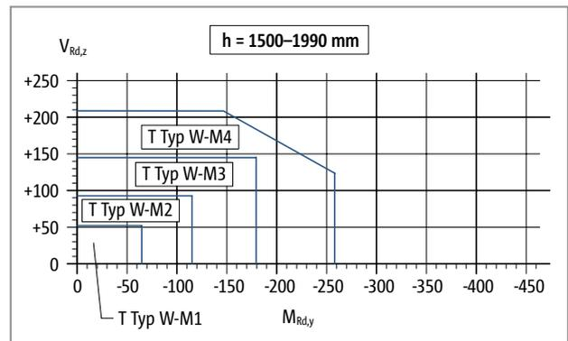
Abb. 380: Schöck Isokorb® T Typ W: Interaktionsdiagramm
