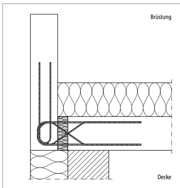
Abb. 337: Schöck Isokorb® T Typ F: Anschluss einer frontal angeschlossenen Brüstung mit Wärmedämmverbundsystem
