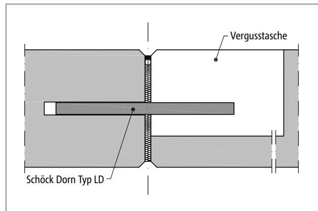
Abb. 37: Schöck Dorn: Dehnfugenausbildung Fertigteilbalkon
