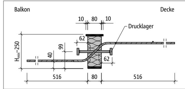
Abb. 214: Schöck Isokorb® T Typ Q-P-V4: Produktschnitt
