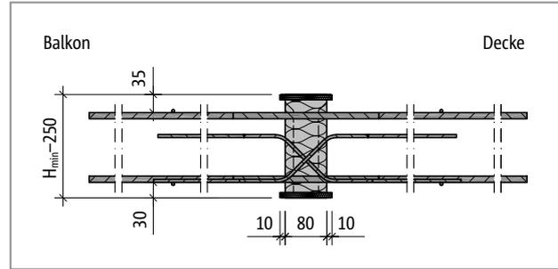
Abb. 307: Schöck Isokorb® T Typ D bei CV35: Produktschnitt
