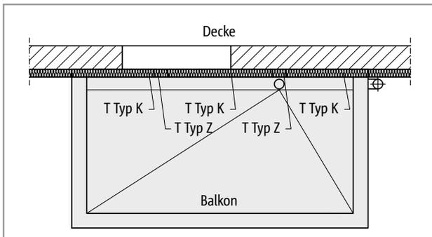
Abb. 291: Schöck Isokorb® T Typ Z, K: Aussparung für Entwässerung mit Schöck Isokorb® T Typ Z
