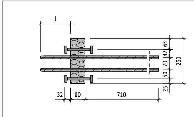
Abb. 359: Schöck Isokorb® T Typ O-X80: Produktgrundriss
