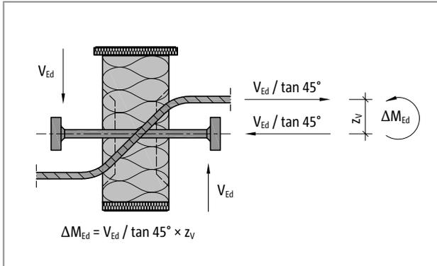
Abb. 211: Schöck Isokorb® T Typ Q-P: Momente aus exzentrischem Anschluss
