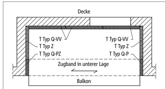
Abb. 292: Schöck Isokorb® T Typ K: Dreiseitig gelagerte Loggia mit Zugband
