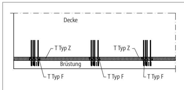
Abb. 336: Schöck Isokorb® T Typ F, Z: Frontal angeschlossene Brüstung
