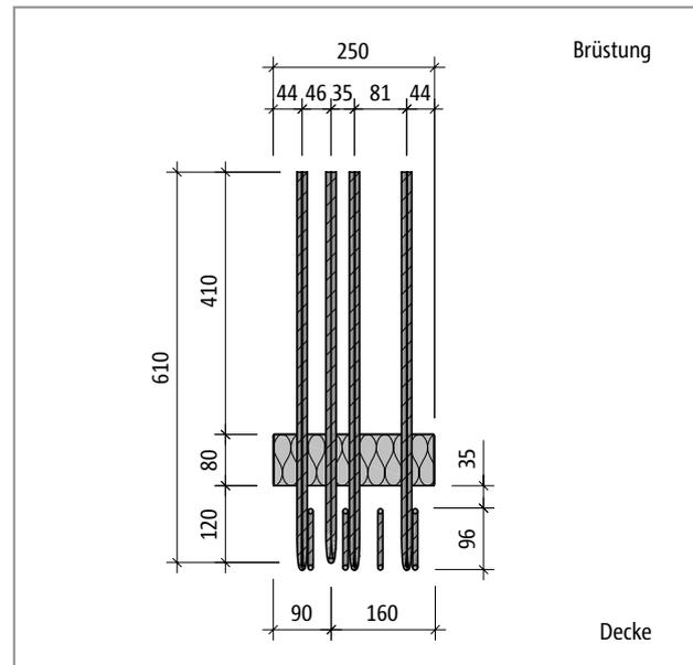
Abb. 327: Schöck Isokorb® T Typ A-MM2-X80: Produktansicht
