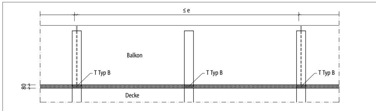
Abb. 370: Schöck Isokorb® T Typ B: Dehnfugenanordnung
