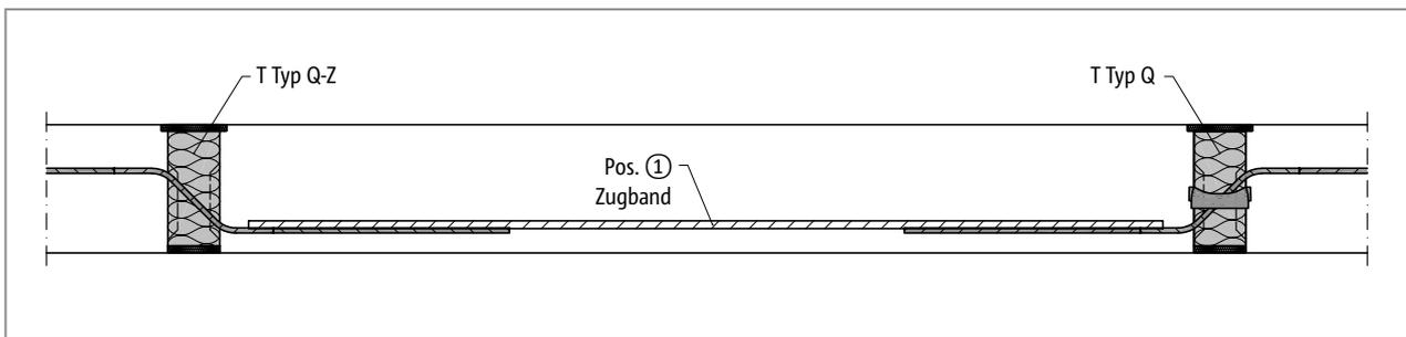
Abb. 198: Schöck Isokorb® T Typ Q-Z-V6 bis Q-Z-V12, Q-V6 bis Q-V12: Schnitt A-A; Einachsig gespannte Stahlbetonplatte
