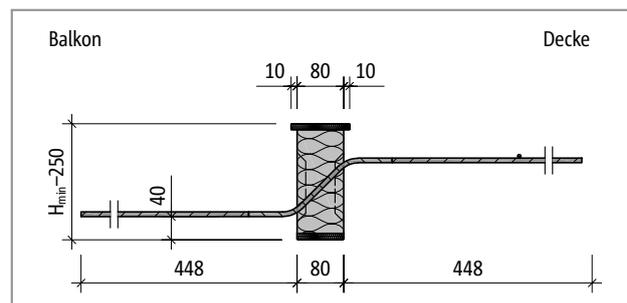
Abb. 222: Schöck Isokorb® T Typ Q-P-VZ1 bis Q-P-VZ3: Produktschnitt
