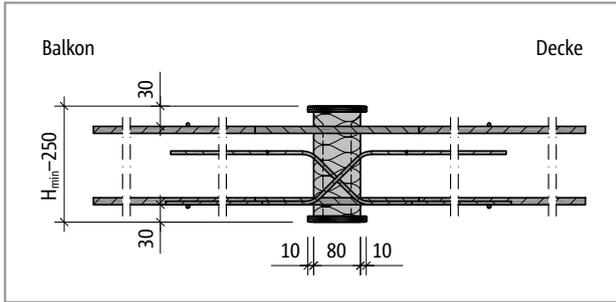
Abb. 306: Schöck Isokorb® T Typ D bei CV30: Produktschnitt
