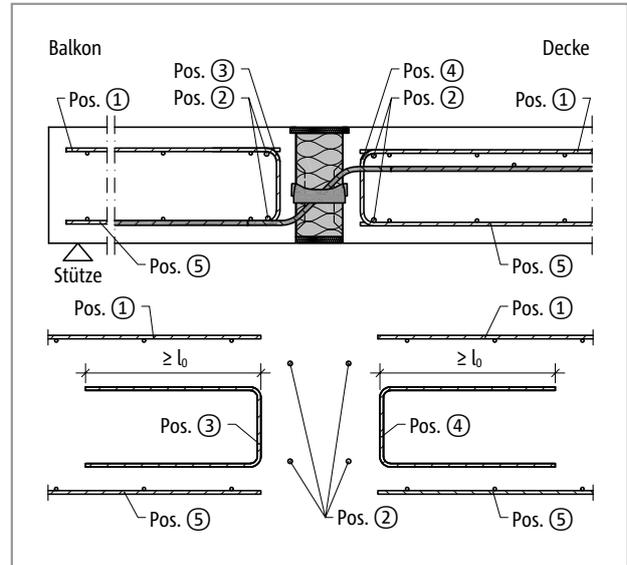
Abb. 191: Schöck Isokorb® T Typ Q-V6 bis Q-V12: Bauseitige Bewehrung
