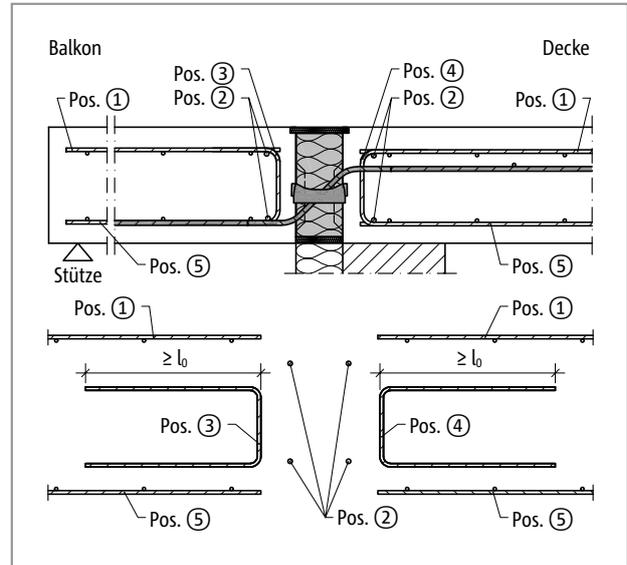
Abb. 185: Schöck Isokorb® T Typ Q-V6 bis Q-V12: Bauseitige Bewehrung
