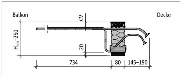
Abb. 123: Schöck Isokorb® T Typ K-O-M2: Produktschnitt
