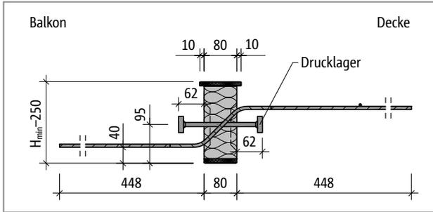
Abb. 213: Schöck Isokorb® T Typ Q-P-V1 bis Q-P-V3: Produktschnitt
