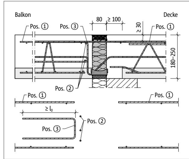
Abb. 88: Schöck Isokorb® T Typ K-F: Bauseitige Bewehrung bei Balkonplattendicke  $h = 180-250$  mm
