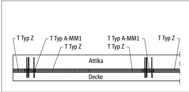
Abb. 315: Schöck Isokorb® T Typ A, Z: Attika (T Typ A-MM1)
