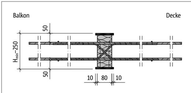
Abb. 308: Schöck Isokorb® T Typ D bei CV50: Produktschnitt
