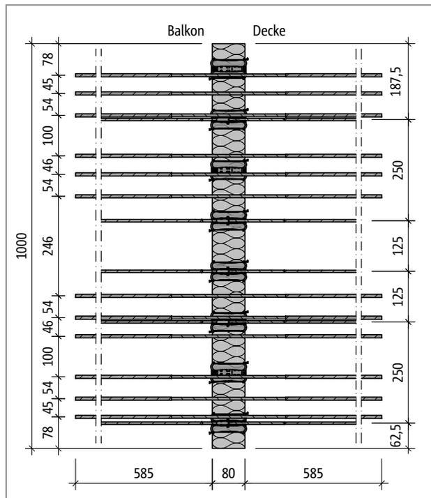
Abb. 54: Schöck Isokorb® T Typ K-M4-V1: Produktgrundriss
