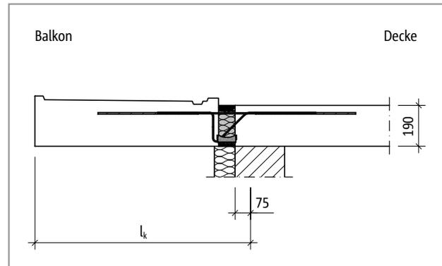
Abb. 82: Schöck Isokorb® T Typ K: Statisches System
