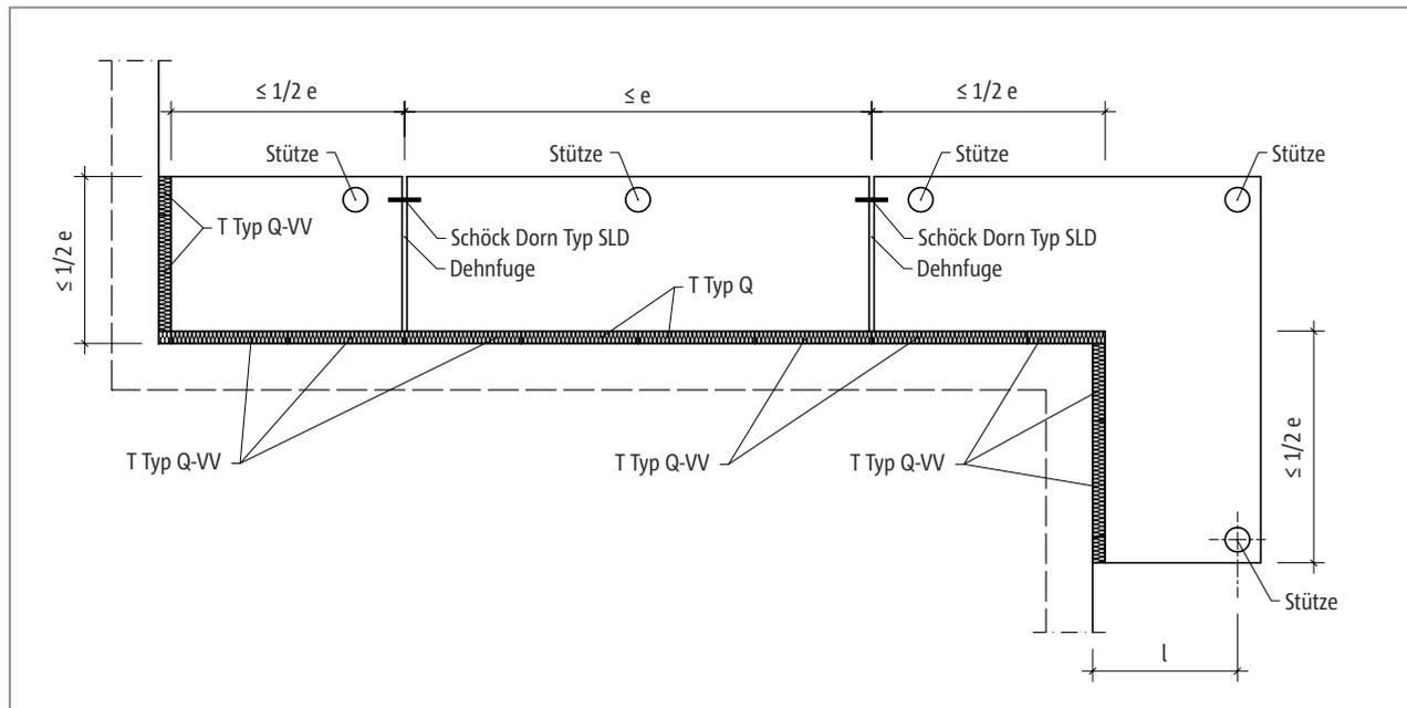
Abb. 167: Schöck Isokorb® T Typ Q, Q-VV: Dehnfugenanordnung
