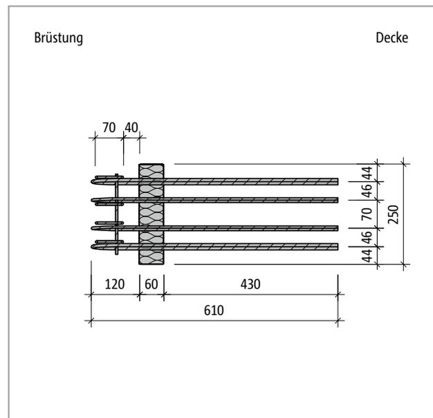
Abb. 347: Schöck Isokorb® T Typ F-X60: Produktgrundriss
