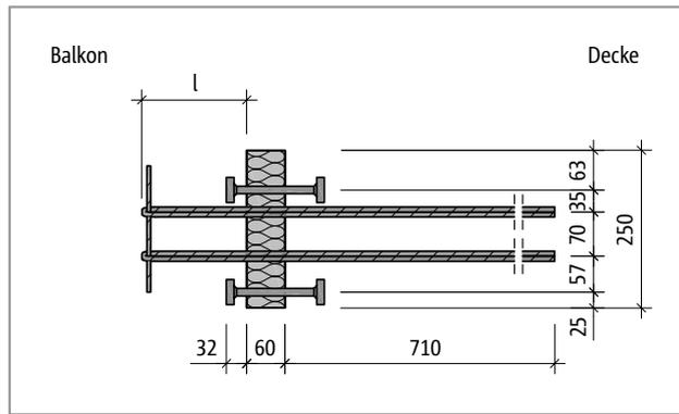
Abb. 361: Schöck Isokorb® T Typ O-X60: Produktgrundriss
