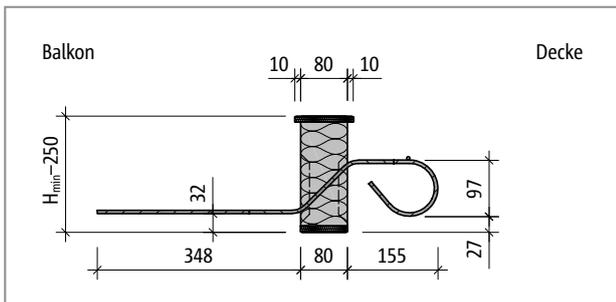
Abb. 176: Schöck Isokorb® T Typ Q-Z-V1 bis Q-Z-V5: Produktschnitt
