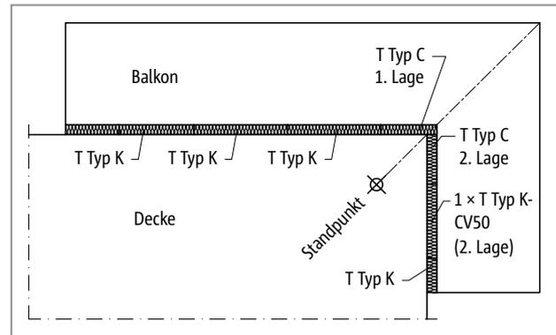
Abb. 244: Schöck Isokorb® T Typ C: Balkon mit Außenecke frei auskragend
