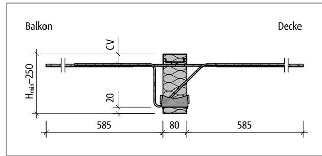
Abb. 66: Schöck Isokorb® T Typ K-M5 und K-M6 bei R0: Produktschnitt
