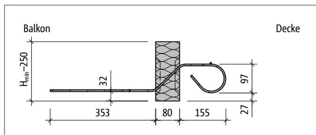
Abb. 182: Schöck Isokorb® T Typ Q-Z-V1 bis V5 bei R0: Produktschnitt
