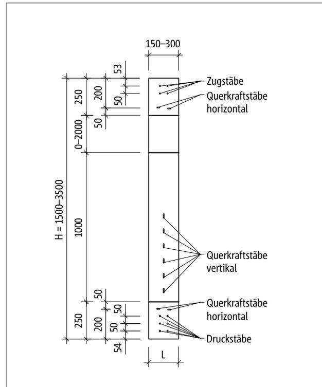
Abb. 388: Schöck Isokorb® T Typ W bei R0: Produktansicht
