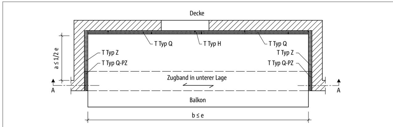
Für die zwängungsfreie Lagerung bei symmetrischen Lasten ist auf beiden Seiten ein T Typ Q-PZ ohne Drucklager anzuordnen. Um das Kräftegleichgewicht zu erhalten ist zwischen T Typen Q-PZ ein Zugband auszubilden, das mit den Querkraftstäben des Schöck Isokorb® zu übergreifen ist.
