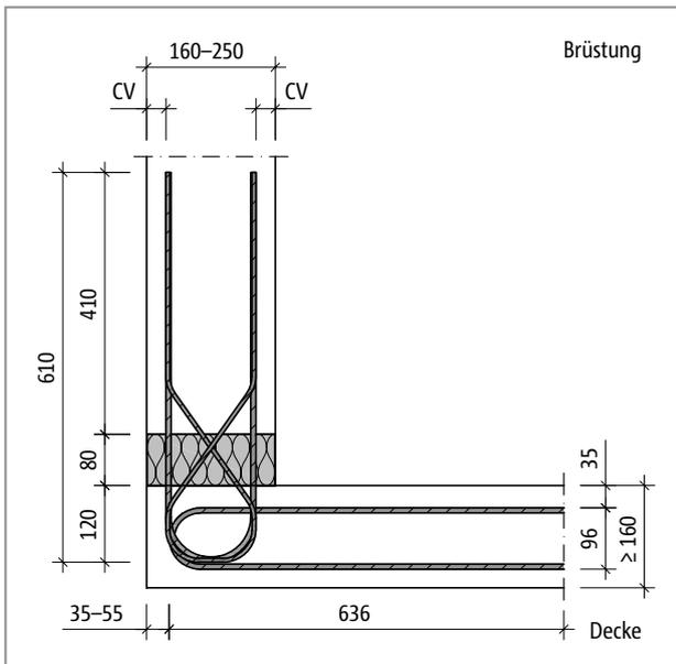
Abb. 326: Schöck Isokorb® T Typ A-MM2-X80: Produktschnitt
