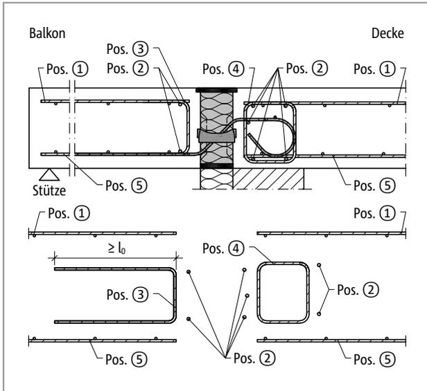
Abb. 184: Schöck Isokorb® T Typ Q-V1 bis Q-V5: Bauseitige Bewehrung
