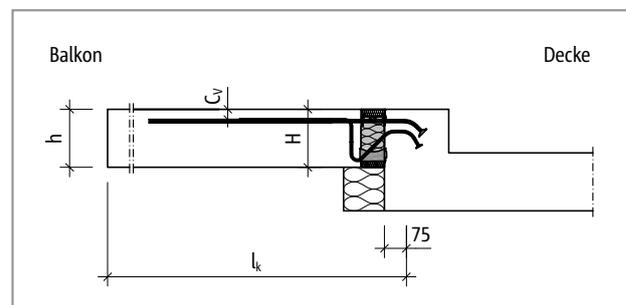
Abb. 115: Schöck Isokorb® T Typ K-O: Statisches System
