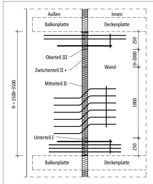
Abb. 378: Schöck Isokorb® T Typ W: Balkonkonstruktion mit wärmeisolierten tragenden Wandscheiben
