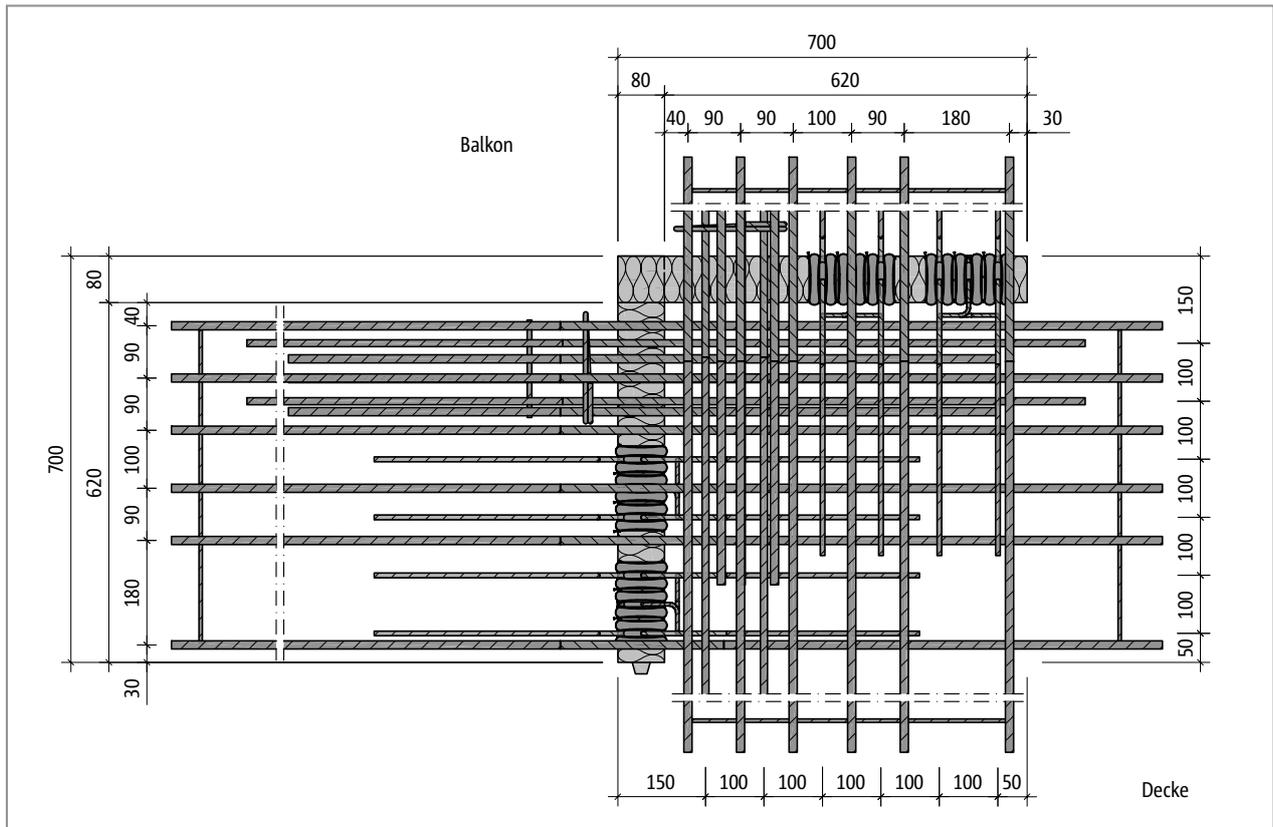
Abb. 255: Schöck Isokorb® T Typ C-M3: Produktgrundriss
