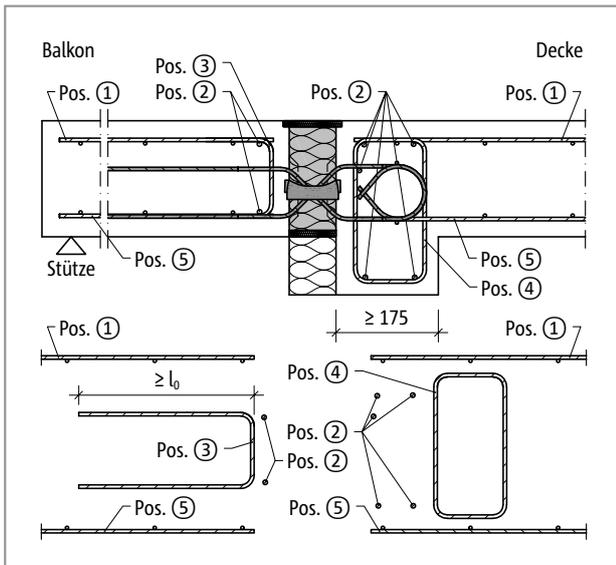
Abb. 192: Schöck Isokorb® T Typ Q-VV1 bis Q-VV5: Bauseitige Bewehrung in Unterzug
