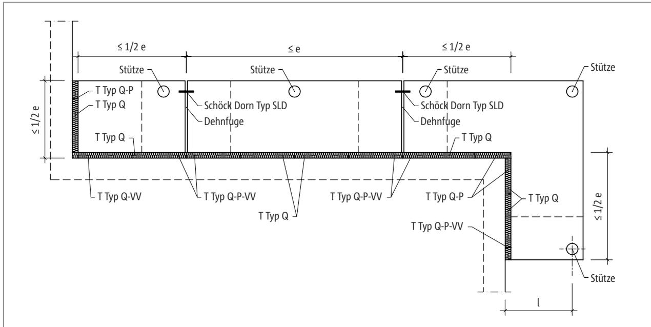
Abb. 212: Schöck Isokorb® T Typ Q-P, Q-P-VV: Dehnfugenanordnung
