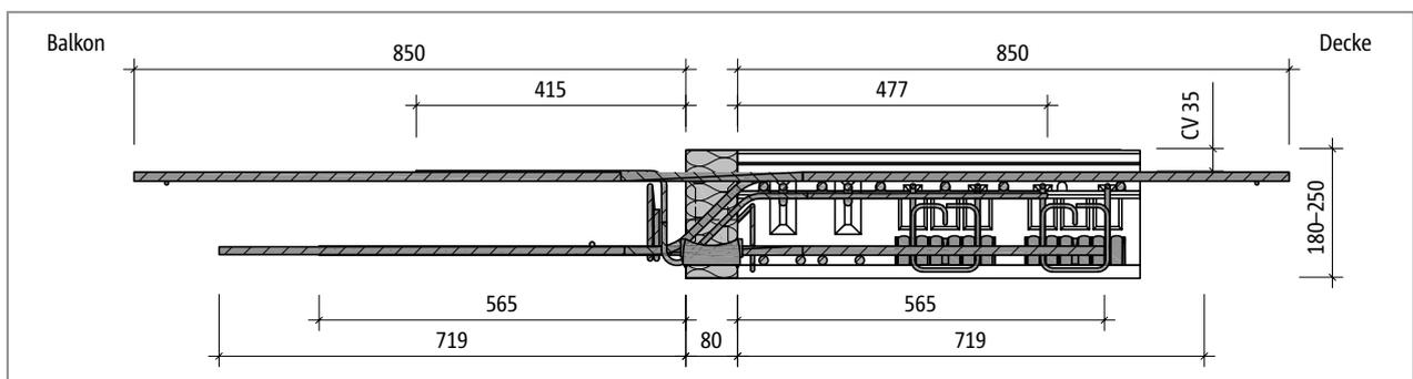
Abb. 256: Schöck Isokorb® T Typ C-M3: Produktschnitt
