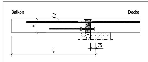
Abb. 47: Schöck Isokorb® T Typ K-M12: Statisches System
