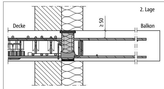
Abb. 246: Schöck Isokorb® T Typ C: Schnitt 2. Lage; Anschluss bei Wärmedämmverbundsystem (WDVS)
