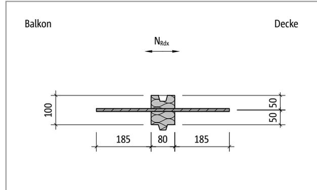
Abb. 277: Schöck Isokorb® T Typ H-NN1: Produktgrundriss
