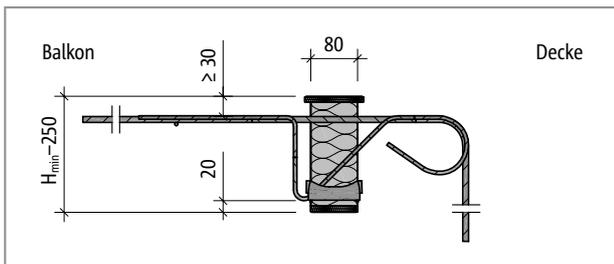
Abb. 102: Schöck Isokorb® T Typ K-WU: Produktschnitt
