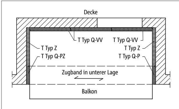
Abb. 201: Schöck Isokorb® T Typ Q-VV, Q-P, Q-PZ: Dreiseitig gelagerte Loggia mit Zugband
