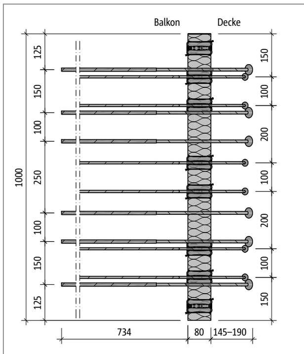
Abb. 125: Schöck Isokorb® T Typ K-O-M2: Produktgrundriss
