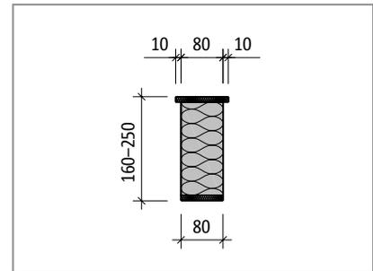
Abb. 298: Schöck Isokorb® T Typ Z-EI120-T: Produktschnitt
