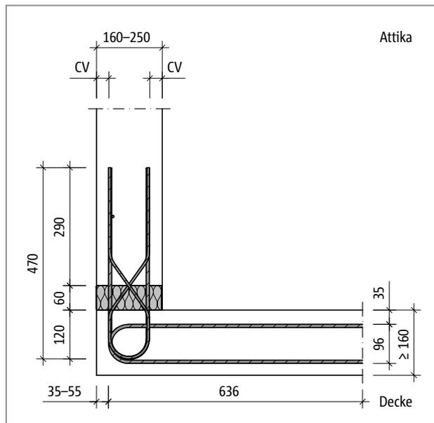
Abb. 328: Schöck Isokorb® T Typ A-MM1-X60: Produktschnitt
