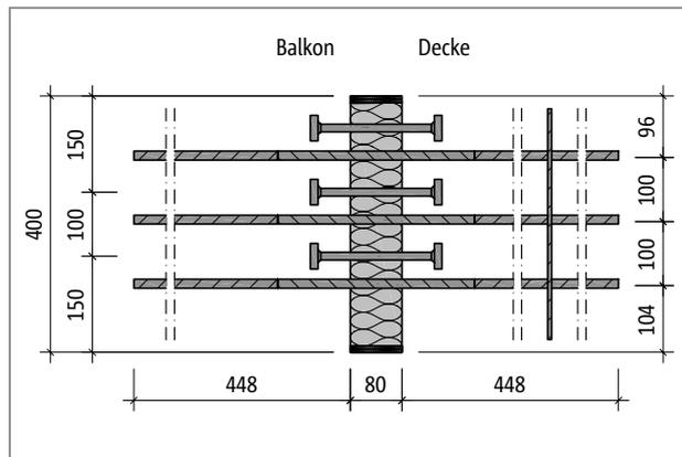
Abb. 225: Schöck Isokorb® T Typ Q-P-V9: Produktgrundriss
