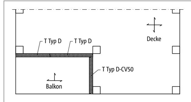
Abb. 302: Schöck Isokorb® T Typ D: Einsatz in Flachdecken
