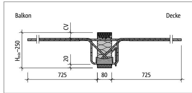
Abb. 57: Schöck Isokorb® T Typ K-M6-VV1: Produktschnitt
