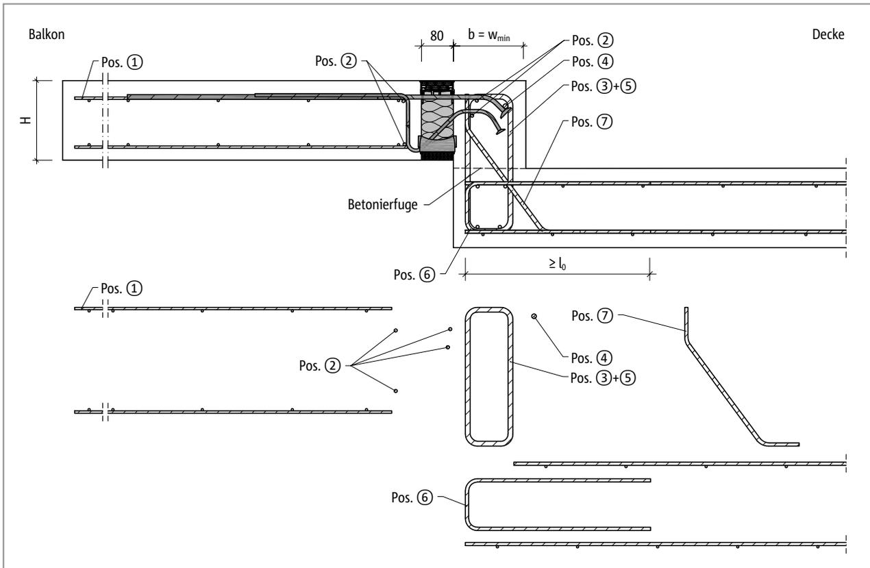
Abb. 132: Schöck Isokorb® T Typ K-O: Bauseitige Bewehrung für Balkon mit Höhenversatz nach oben mit minimaler Bauteilabmessung ( $w_{vorh} = w_{min}$ )
