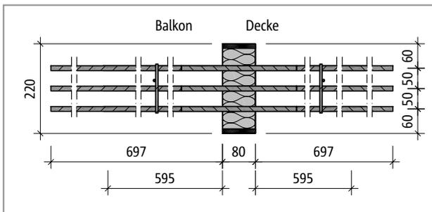
Abb. 372: Schöck Isokorb® T Typ B: Produktgrundriss
