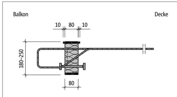
Abb. 362: Schöck Isokorb® T Typ O bei REI120: Produktschnitt; Brandschutzplatte oben und unten
