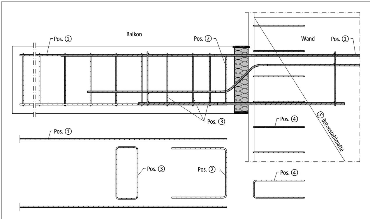
Abb. 376: Schöck Isokorb® T Typ B: Bauseitige Bewehrung (Schnitt)
