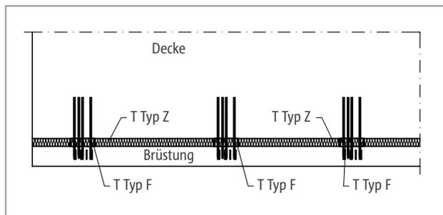
Abb. 341: Schöck Isokorb® T Typ F, Z: Frontal angeschlossene Brüstung
