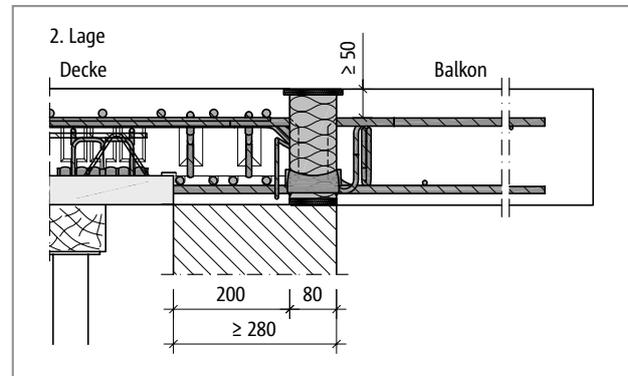
Abb. 264: Schöck Isokorb® T Typ C: Elementplatte mit Randunterstützung mit wärmedämmendem Mauerwerk (Schnitt T Typ C-CV50-2. Lage, Ansicht T Typ C-CV35-1. Lage)
