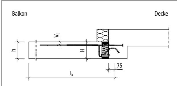
Abb. 116: Schöck Isokorb® T Typ K-U: Statisches System
