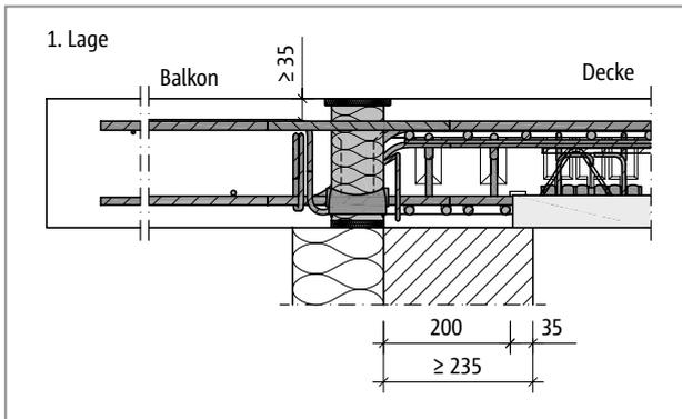
Abb. 261: Schöck Isokorb® T Typ C: Elementplatte ohne Randunterstützung mit WDV5 (Schnitt T Typ C-CV35-1. Lage, Ansicht T Typ C-CV50-2. Lage)
