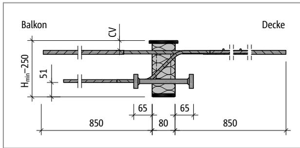
Abb. 60: Schöck Isokorb® T Typ K-M12: Produktschnitt
