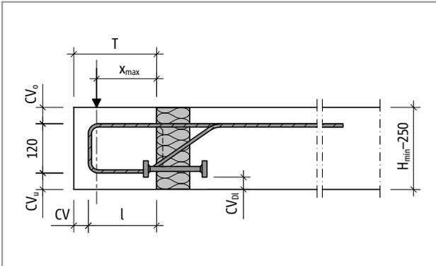
Abb. 358: Schöck Isokorb® T Typ O-X80: Produktschnitt
