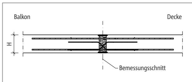
Abb. 305: Schöck Isokorb® T Typ D: Statisches System
