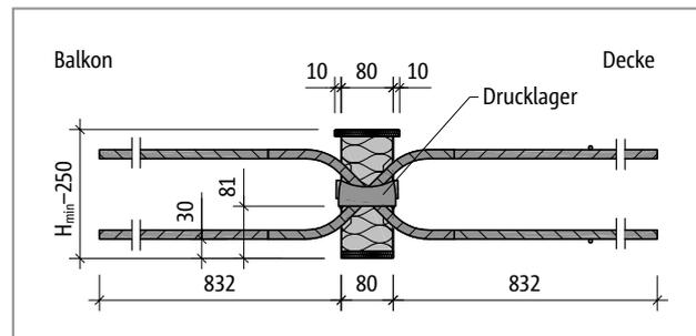
Abb. 175: Schöck Isokorb® T Typ Q-VV12: Produktschnitt
