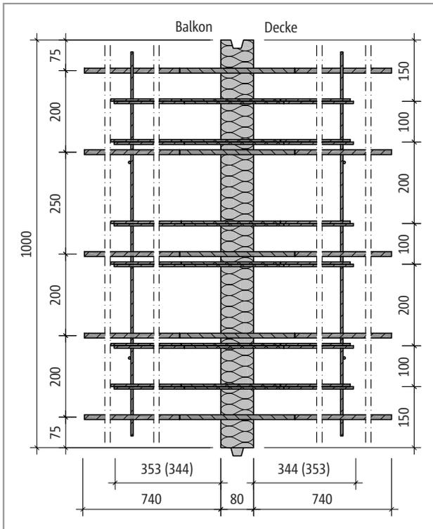
Abb. 309: Schöck Isokorb® T Typ D-MM2-VV1: Grundriss
