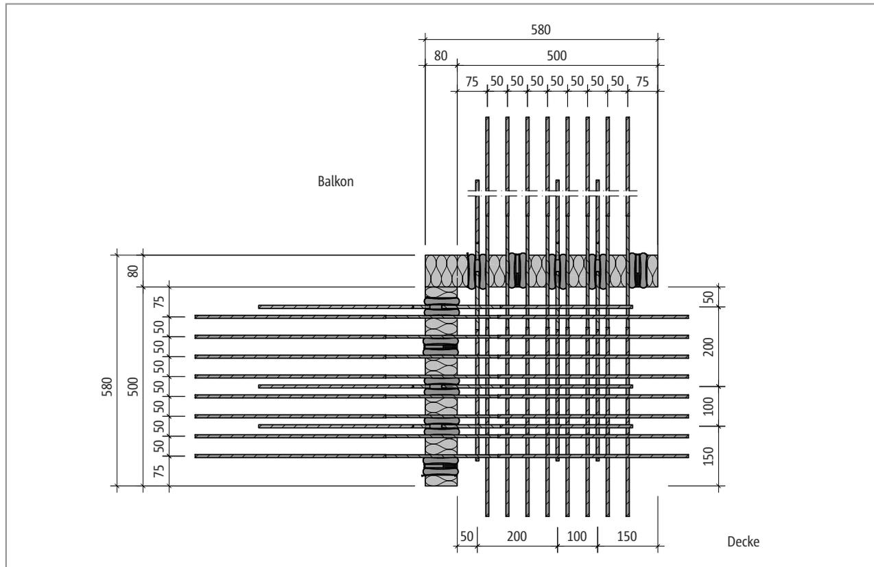
Abb. 249: Schöck Isokorb® T Typ C-M1: Produktgrundriss
