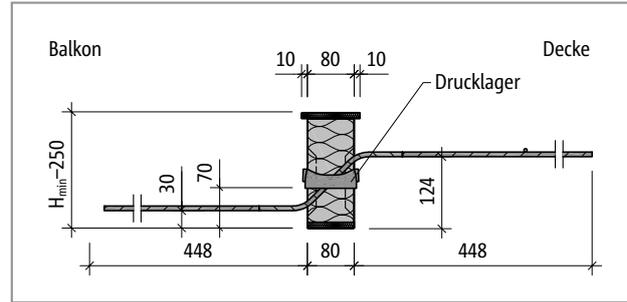
Abb. 169: Schöck Isokorb® T Typ Q-V6: Produktschnitt
