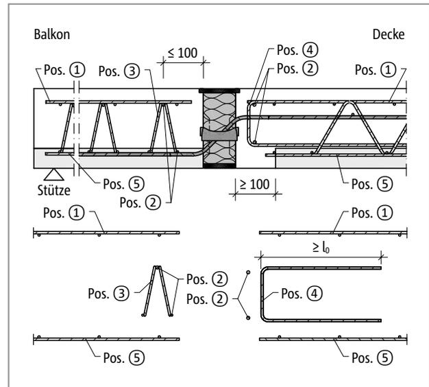
Abb. 195: Schöck Isokorb® T Typ Q-V6 bis Q-V12: Bauseitige Bewehrung mit Gitterträger
