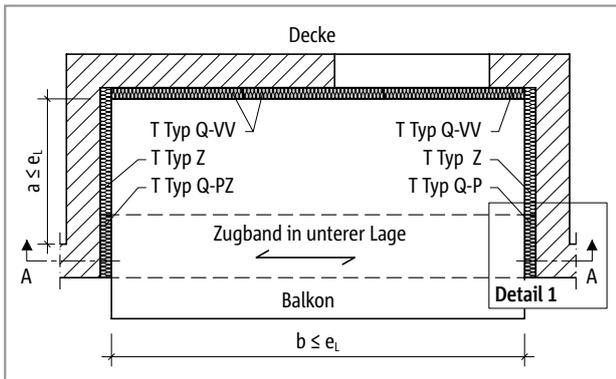
Abb. 237: Schöck Isokorb® T Typ Q-PZ, Q-P: Grundriss Loggia
