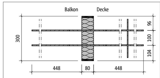
Abb. 224: Schöck Isokorb® T Typ Q-PZ-V1: Produktgrundriss
