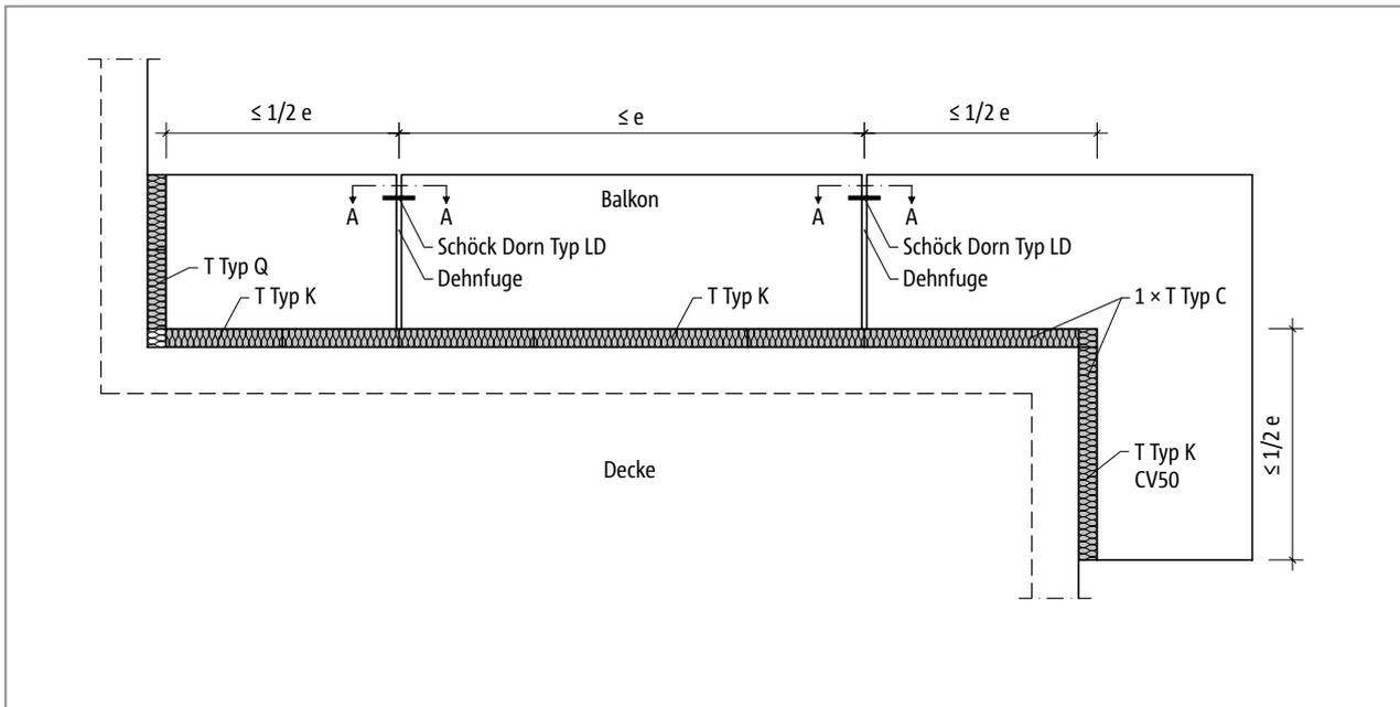
Abb. 35: Schöck Isokorb® T Typ K: Dehnfugenausbildung mit längsverschieblichem Querkraftdorn, z. B. Schöck Dorn
