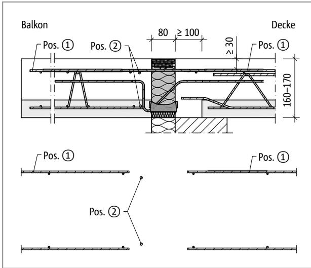
Abb. 87: Schöck Isokorb® T Typ K-F: Bauseitige Bewehrung bei Balkonplattendicke  $h = 160-170$  mm
