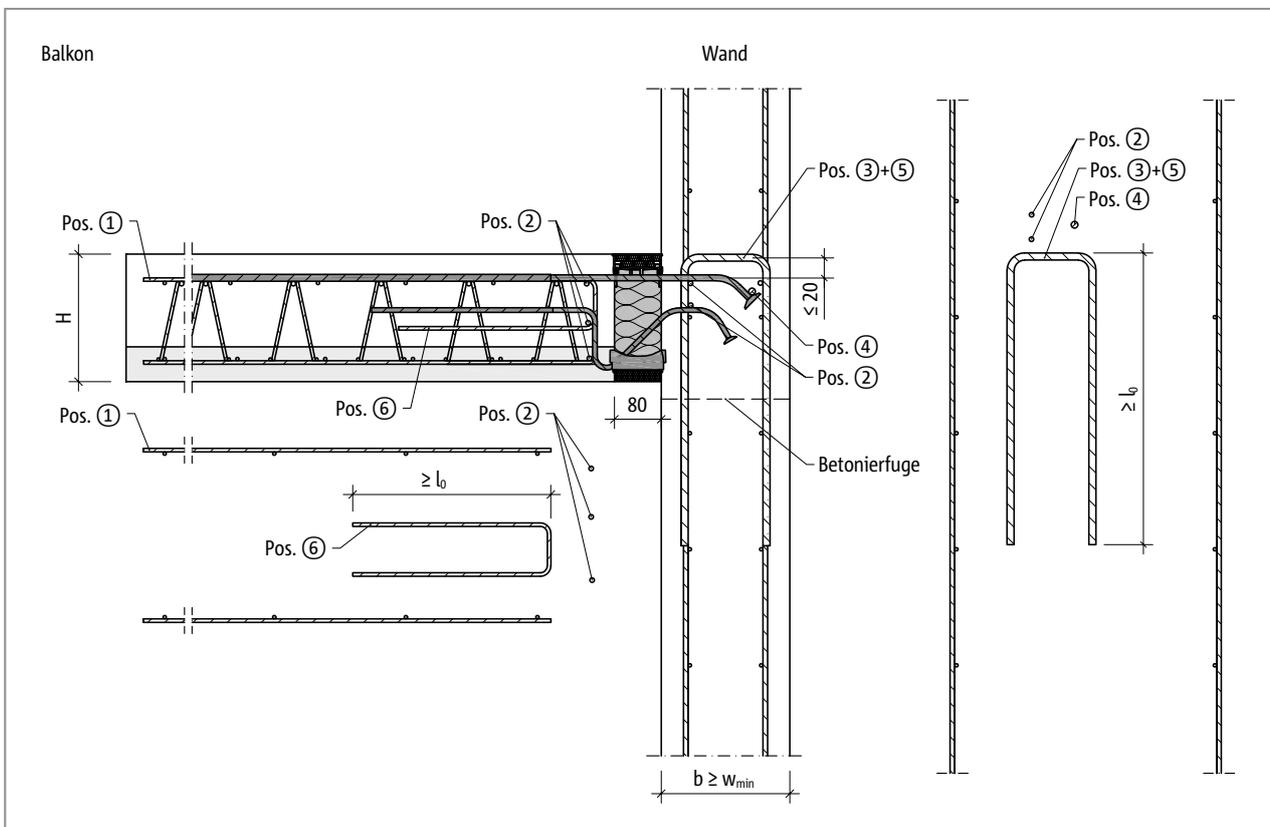
Abb. 145: Schöck Isokorb® T Typ K-O-F: Bauseitige Bewehrung für Wandanschluss nach unten
