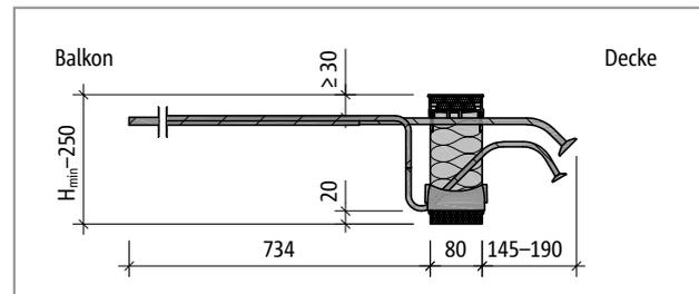
Abb. 101: Schöck Isokorb® T Typ K-O: Produktschnitt
