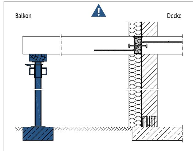
Abb. 242: Schöck Isokorb® T Typ Q-P: Stützung durchgängig erforderlich
