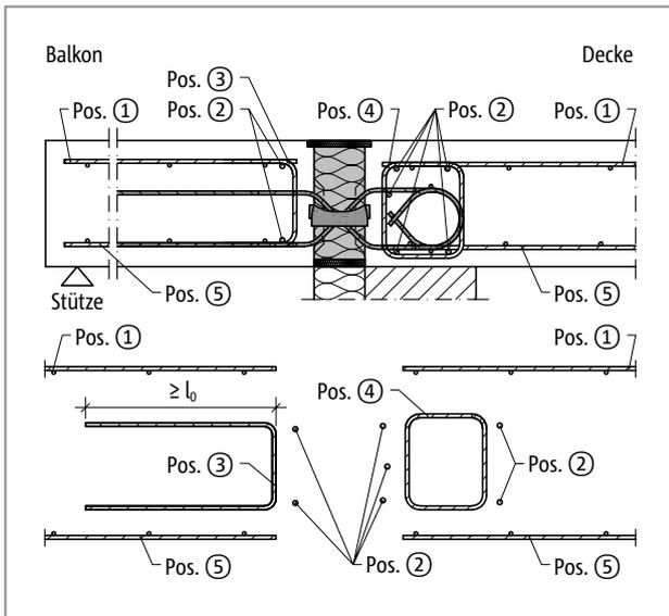
Abb. 186: Schöck Isokorb® T Typ Q-VV1 bis Q-VV5: Bauseitige Bewehrung
