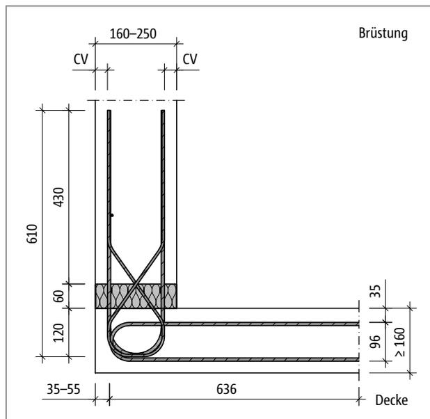
Abb. 330: Schöck Isokorb® T Typ A-MM2-X60: Produktschnitt
