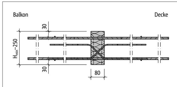
Abb. 311: Schöck Isokorb® T Typ D bei R0-CV30: Produktschnitt
