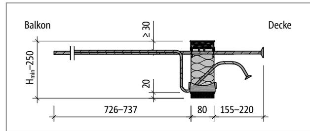
Abb. 98: Schöck Isokorb® T Typ K-U: Produktschnitt
