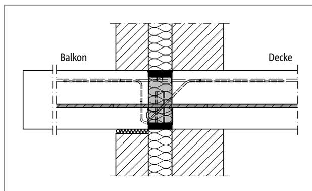
Abb. 269: Schöck Isokorb® T Typ K, H-NN: Mauerwerk mit Kerndämmung
