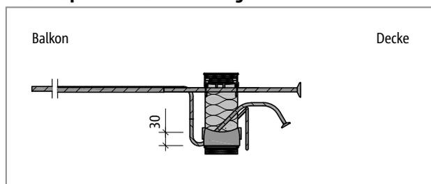
Abb. 27: Schöck Isokorb® T Typ K-U-M4: Produktschnitt
