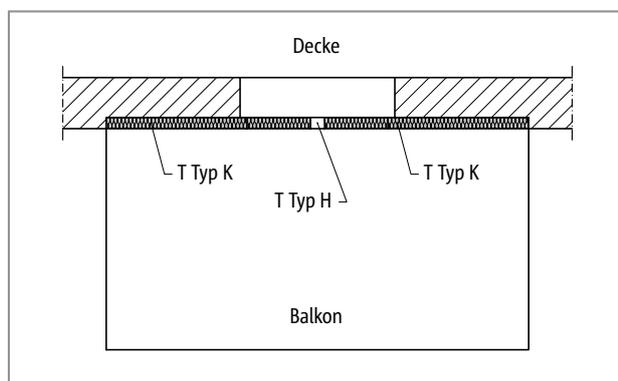
Abb. 267: Schöck Isokorb® T Typ H: Balkon frei auskragend
