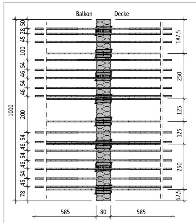
Abb. 55: Schöck Isokorb® T Typ K-M6-V1: Produktgrundriss
