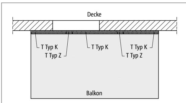
Abb. 289: Schöck Isokorb® T Typ Z, K: Balkon frei ausragend
