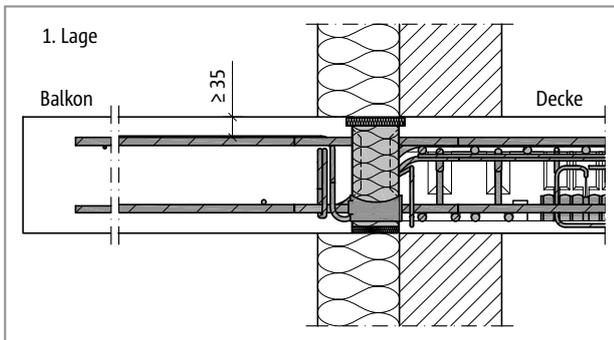
Abb. 245: Schöck Isokorb® T Typ C: Schnitt 1. Lage; Anschluss bei Wärmedämmverbundsystem (WDVS)
