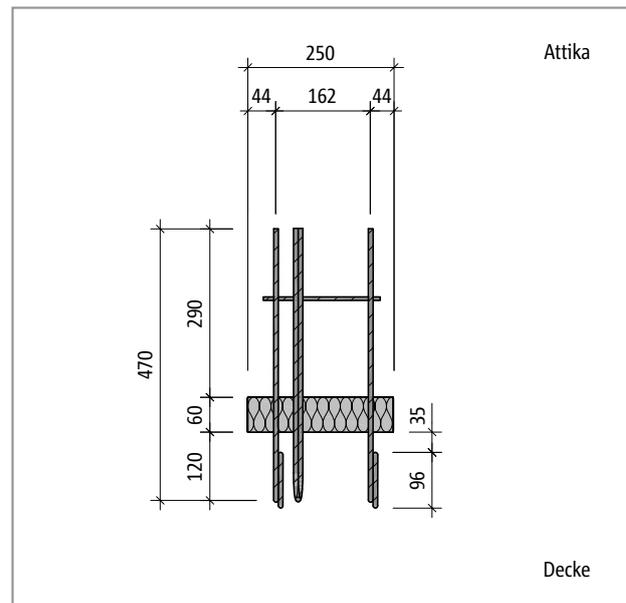
Abb. 329: Schöck Isokorb® T Typ A-MM1-X60: Produktansicht
