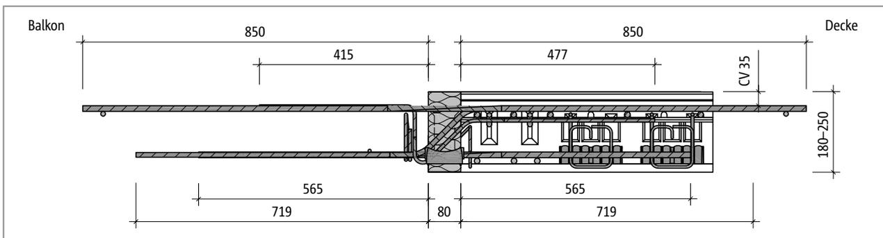
Abb. 253: Schöck Isokorb® T Typ C-M2: Produktschnitt
