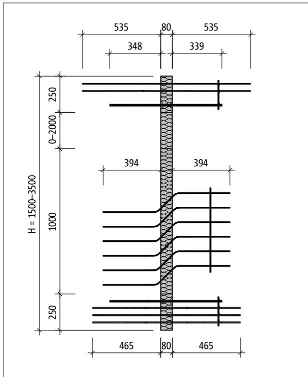
Abb. 387: Schöck Isokorb® T Typ W bei R0: Produktschnitt
