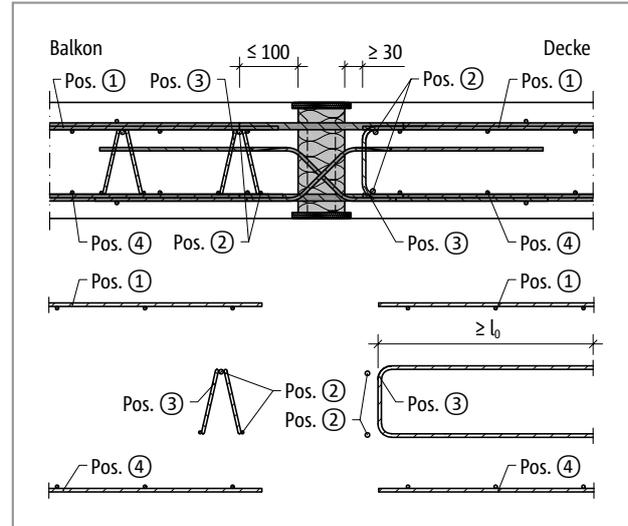
Abb. 314: Schöck Isokorb® T Typ D: Bauseitige Bewehrung mit Gitterträger
