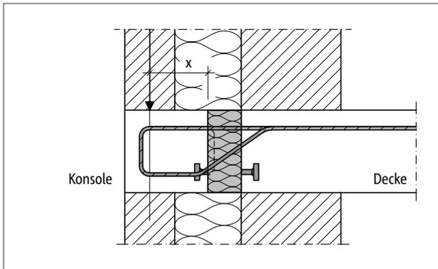
Abb. 352: Schöck Isokorb® T Typ O: Konsole mit Verblendmauerwerk
