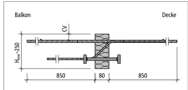
Abb. 68: Schöck Isokorb® T Typ K-M12 bei R0: Produktschnitt
