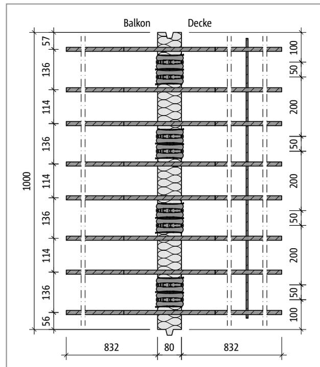
Abb. 179: Schöck Isokorb® T Typ Q-V12: Produktgrundriss
