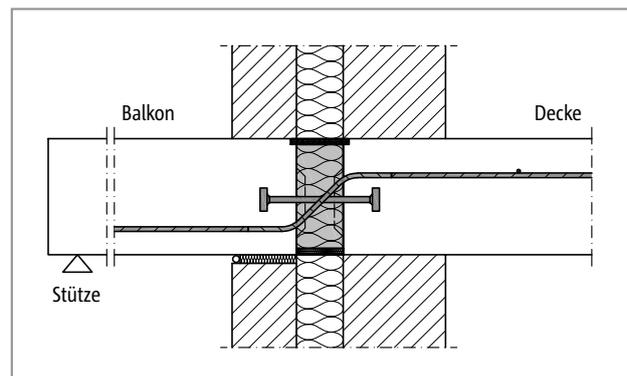
Abb. 207: Schöck Isokorb® T Typ Q-P: Anschluss gestützter Balkon bei zweisechaligem Mauerwerk mit Kerndämmung
