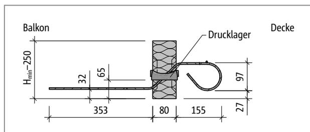
Abb. 180: Schöck Isokorb® T Typ Q-V1 bis Q-V5 bei R0: Produktschnitt
