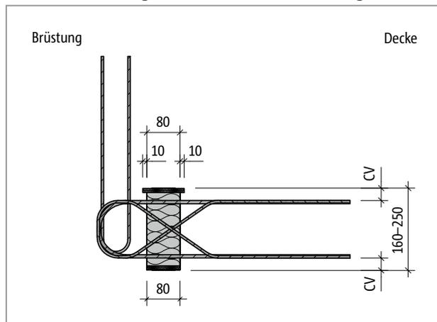
Abb. 348: Schöck Isokorb® T Typ F bei REI120: Produktschnitt; Brandschutzplatte oben und unten
