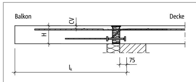
Abb. 50: Schöck Isokorb® T Typ K-M12: Statisches System
