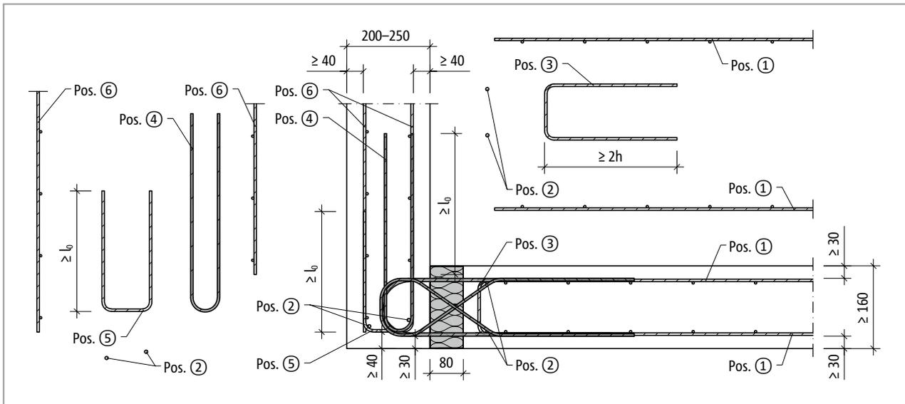
Abb. 350: Schöck Isokorb® T Typ F: Bauseitige Bewehrung bei Brüstungsbreite  $b = 200 - 250$ ; Bauseitige Bewehrung  $b = 160 - 190$  wie  $b = 200 - 250$  ohne Pos. 5
