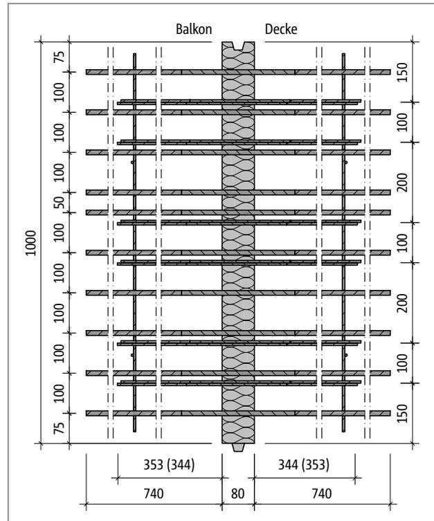
Abb. 310: Schöck Isokorb® T Typ D-MM4-VV1: Grundriss
