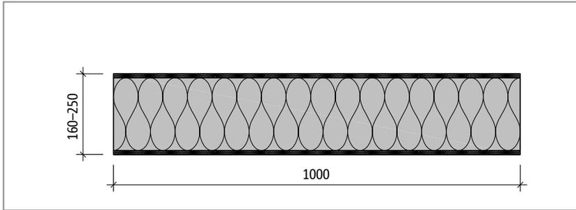
Abb. 295: Schöck Isokorb® T Typ Z-EI120-L1000: Produktansicht
