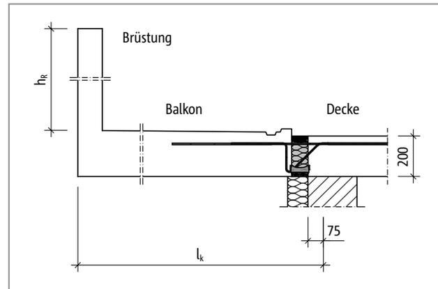
Abb. 286: Schöck Isokorb® T Typ K: Statisches System
