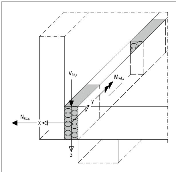
Abb. 339: Schöck Isokorb® T Typ F: Vorzeichenregel für die Bemessung
