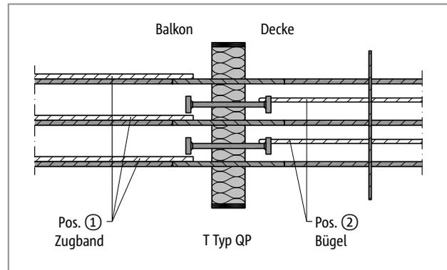
Abb. 238: Schöck Isokorb® T Typ Q-P: Detail 1; Bewehrungsanschluss Zugband
