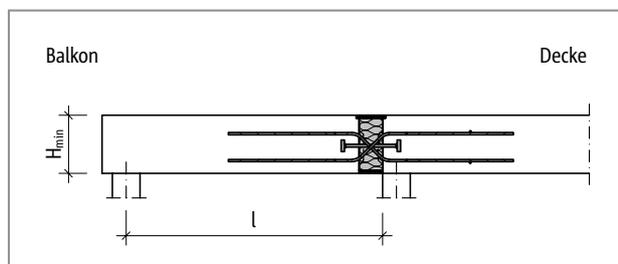
Abb. 210: Schöck Isokorb® T Typ Q-P-VV: Statisches System
