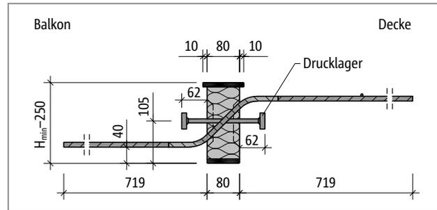
Abb. 216: Schöck Isokorb® T Typ Q-P-V6: Produktschnitt
