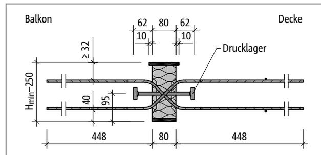
Abb. 220: Schöck Isokorb® T Typ Q-P-VV1 bis Q-P-VV3: Produktschnitt
