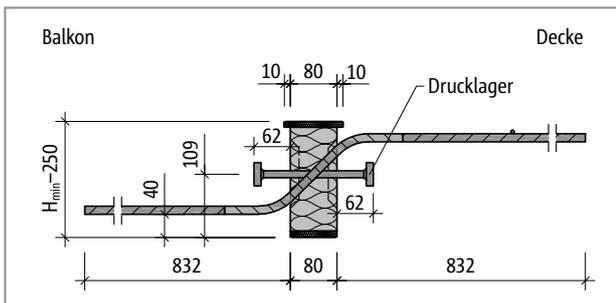
Abb. 219: Schöck Isokorb® T Typ Q-P-V10: Produktschnitt
