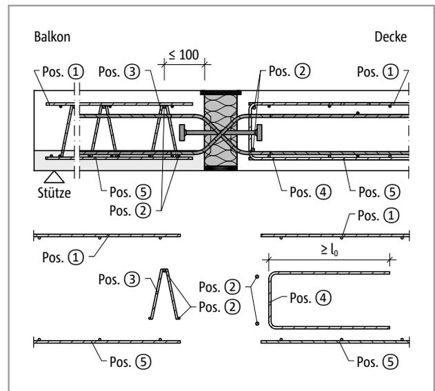
Abb. 236: Schöck Isokorb® T Typ Q-P-VV: Bauseitige Bewehrung, balkonseitig mit Gitterträger
