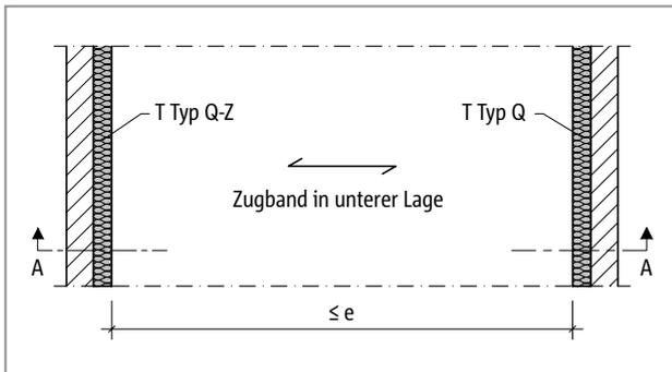
Abb. 196: Schöck Isokorb® T Typ Q-Z, Q: Einachsig gespannte Stahlbetonplatte
