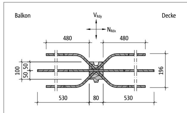
Abb. 283: Schöck Isokorb® T Typ H-VV2-NN1: Produktgrundriss
