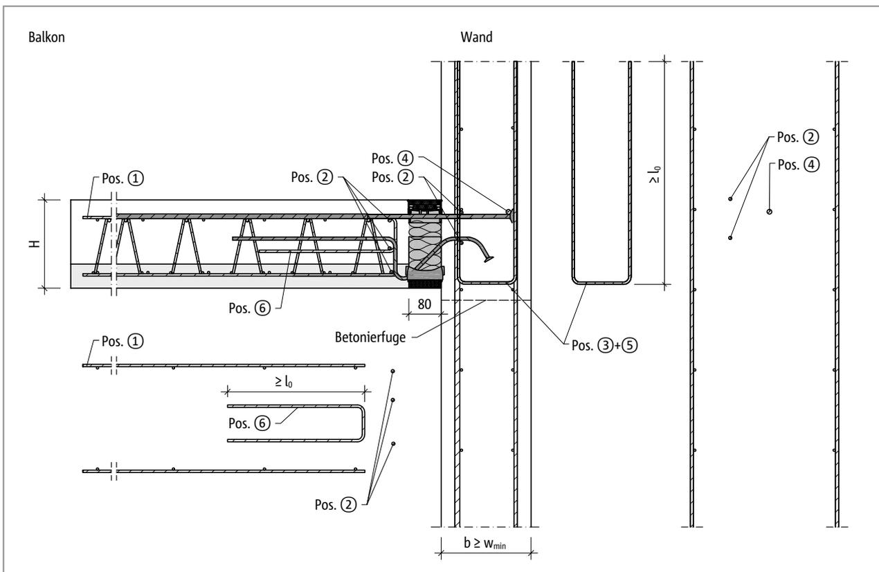
Abb. 143: Schöck Isokorb® T Typ K-U-F: Bauseitige Bewehrung für Wandanschluss nach oben
