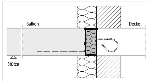
Abb. 294: Schöck Isokorb® T Typ Z, Q: Wärmedämmverbundsystem (WDVS)
