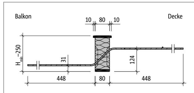
Abb. 177: Schöck Isokorb® T Typ Q-Z-V6: Produktschnitt
