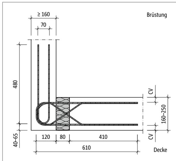
Abb. 344: Schöck Isokorb® T Typ F-X80: Produktschnitt
