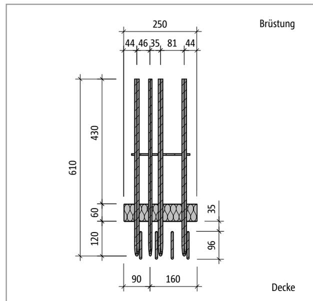
Abb. 331: Schöck Isokorb® T Typ A-MM2-X60: Produktansicht
