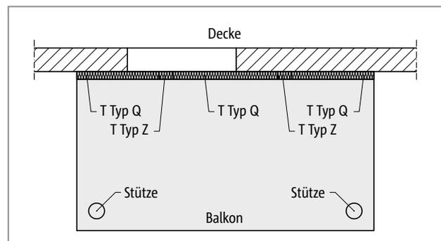
Abb. 290: Schöck Isokorb® T Typ Z, K: Balkon mit Stützenlagerung
