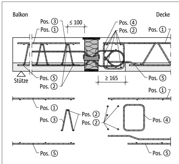
Abb. 194: Schöck Isokorb® T Typ Q-VV1 bis Q-VV5: Bauseitige Bewehrung mit Gitterträger
