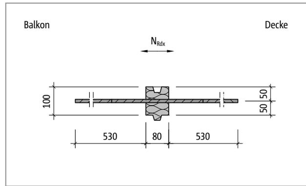
Abb. 279: Schöck Isokorb® T Typ H-NN2: Produktgrundriss
