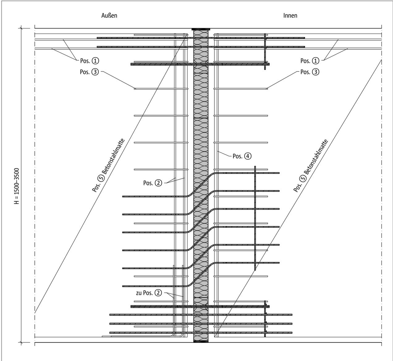
Abb. 389: Schöck Isokorb® T Typ W: Bauseitige Bewehrung (Schnitt)
