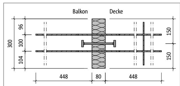
Abb. 228: Schöck Isokorb® T Typ Q-P-V1 bei R0: Produktgrundriss
