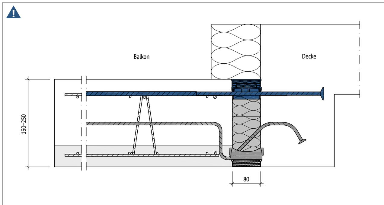
Abb. 150: Schöck Isokorb® T Typ K-U-F: Mehrteiliger Aufbau mit Oberteil, Zwischenteil (optional) und Unterteil. Hier: Oberteil eingefärbt.
