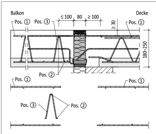
Abb. 89: Schöck Isokorb® T Typ K-F: Bauseitige Bewehrung bei Balkonplattendicke  $h = 180-250$  mm mit Gitterträger (Pos.2:  $2\phi 8$ )
