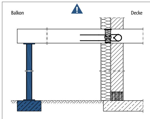
Abb. 199: Schöck Isokorb® T Typ Q-VV: Stützung durchgängig erforderlich
