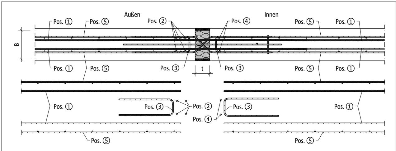
Abb. 390: Schöck Isokorb® T Typ W: Bauseitige Bewehrung (Grundriss)
