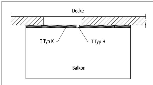
Abb. 38: Schöck Isokorb® T Typ K: Balkon frei auskragend, optional mit T Typ H (ab Seite 189) bei planmäßigen Horizontallasten, z. B. geschlossene Brüstungen
