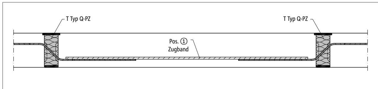
Abb. 240: Schöck Isokorb® T Typ Q-PZ: Bewehrungsanschluss Zugband
