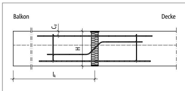
Abb. 369: Schöck Isokorb® T Typ B: Statisches System
