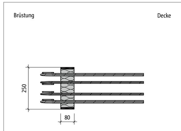
Abb. 349: Schöck Isokorb® T Typ F bei REI120: Produktgrundriss; Brandschutzplatten seitlich
