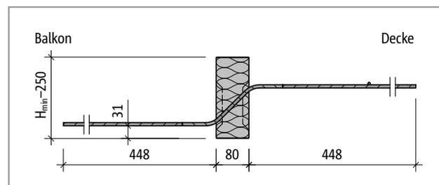
Abb. 183: Schöck Isokorb® T Typ Q-Z-V6 bei R0: Produktschnitt
