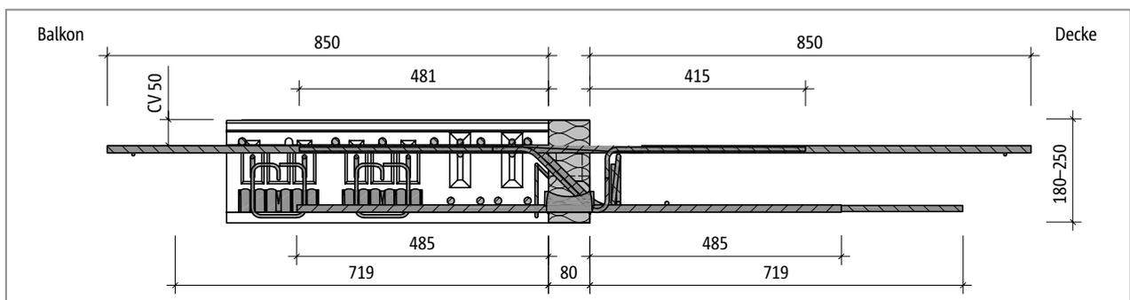
Abb. 257: Schöck Isokorb® T Typ C-M3: Produktschnitt
