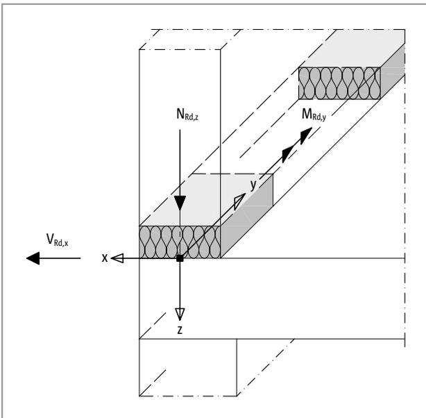
Abb. 319: Schöck Isokorb® T Typ A: Vorzeichenregel für die Bemessung
