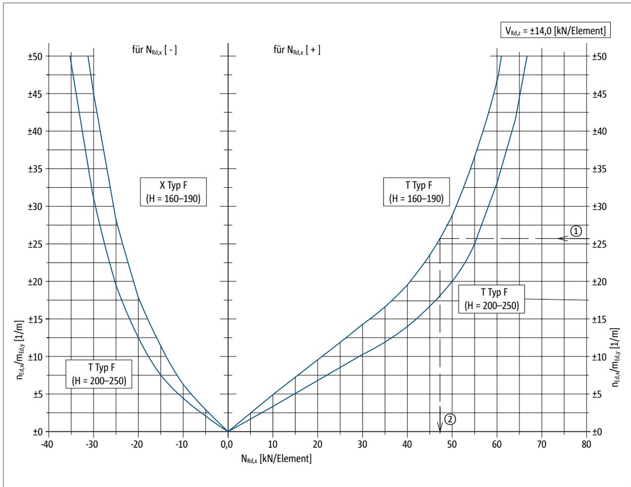
Detailausschnitt Diagramm Achsabstände C25/30 (-5 <  $N_{Rd,z}$  < 5 [kN/Element])
