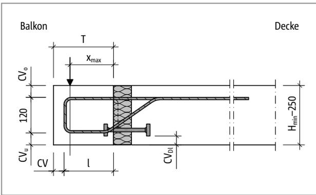
Abb. 360: Schöck Isokorb® T Typ O-X60: Produktschnitt
