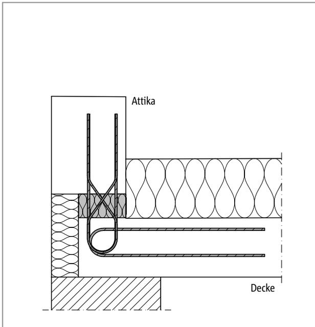
Abb. 317: Schöck Isokorb® T Typ A: Anschluss einer Attika (T Typ A-MM1)
