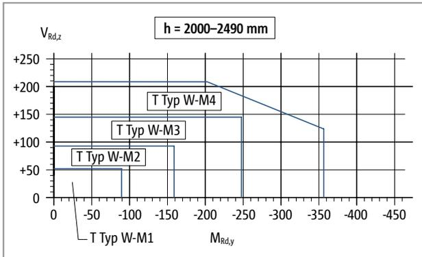
Abb. 381: Schöck Isokorb® T Typ W: Interaktionsdiagramm
