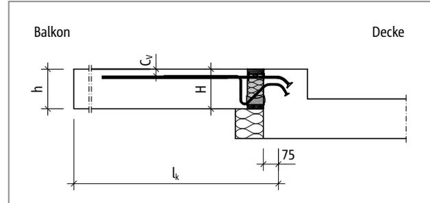
Abb. 117: Schöck Isokorb® T Typ K-O: Statisches System
