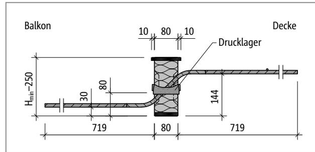
Abb. 171: Schöck Isokorb® T Typ Q-V9 bis Q-V11: Produktschnitt
