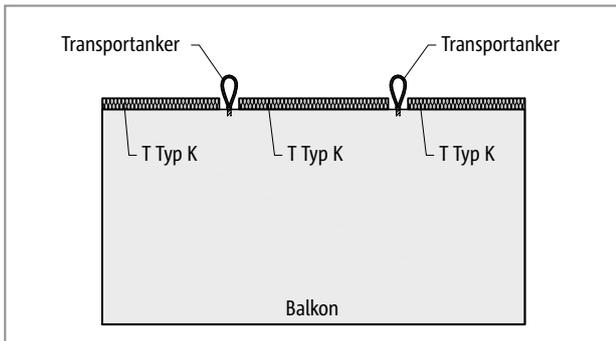
Abb. 287: Schöck Isokorb® T Typ K: Elementbalkon mit Transportanker; Dämmzwischenstück T Typ Z kann bauseitig eingelegt werden
