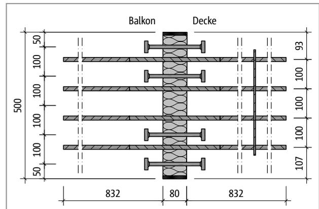
Abb. 226: Schöck Isokorb® T Typ Q-P-V10: Produktgrundriss
