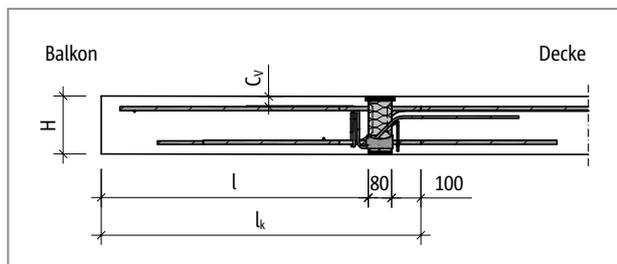
Abb. 247: Schöck Isokorb® T Typ C: Statisches System
