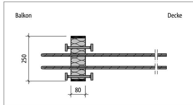
Abb. 363: Schöck Isokorb® T Typ O bei REI120: Produktgrundriss; Brandschutzplatten seitlich
