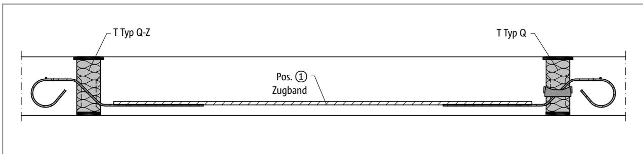
Abb. 197: Schöck Isokorb® T Typ Q-Z-V1 bis Q-Z-V5, Q-V1 bis Q-V5: Schnitt A-A; Einachsig gespannte Stahlbetonplatte
