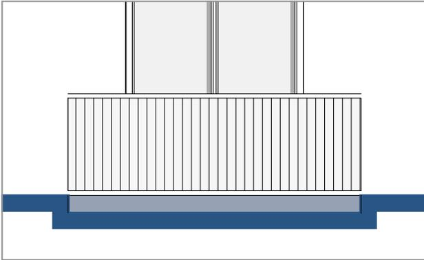
Abb. 14: Schöck Isokorb® Variante R0: Brandriegel unterhalb angeordnet
