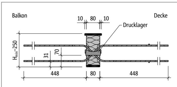
Abb. 174: Schöck Isokorb® T Typ Q-VV6: Produktschnitt
