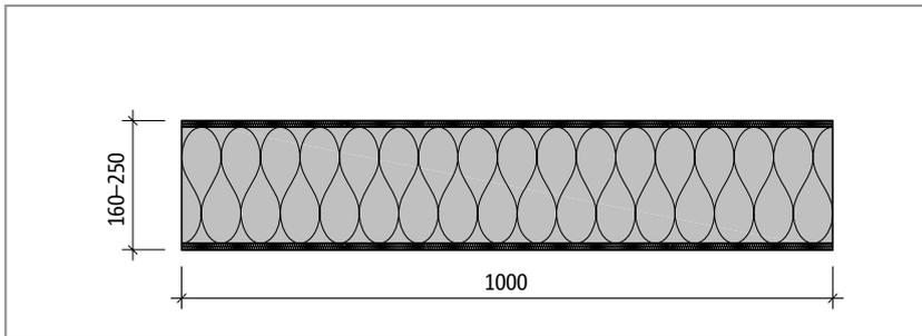
Abb. 297: Schöck Isokorb® T Typ Z-EI120-T-L1000: Produktansicht
