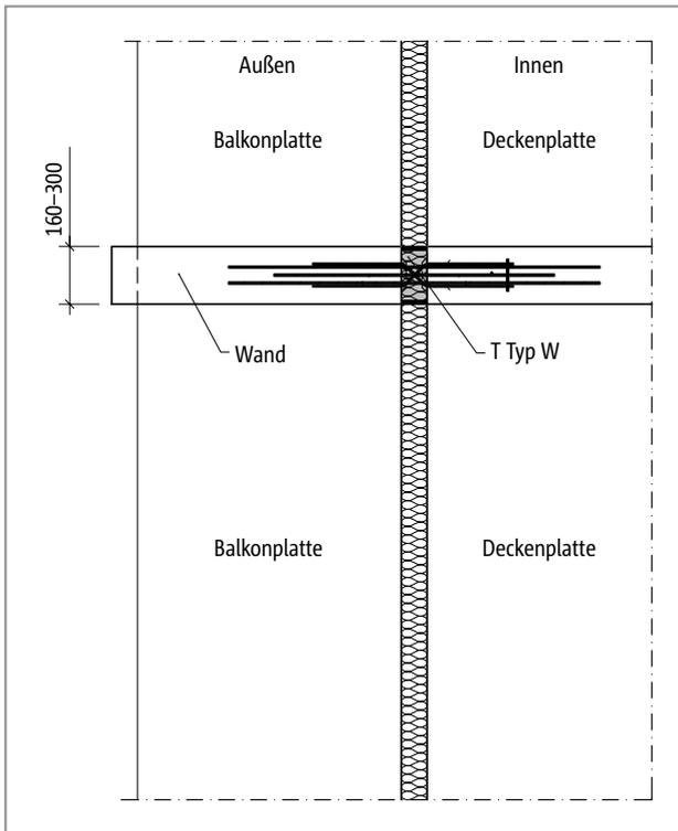
Abb. 377: Schöck Isokorb® T Typ W: Grundriss; Balkonkonstruktion mit wärmeisolierten tragenden Wandscheiben
