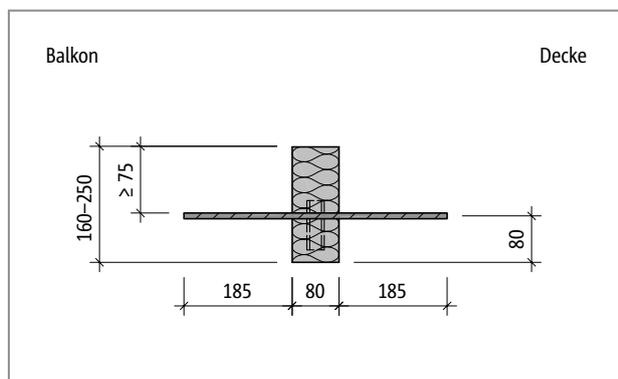
Abb. 284: Schöck Isokorb® T Typ H-NN bei R0: Produktschnitt
