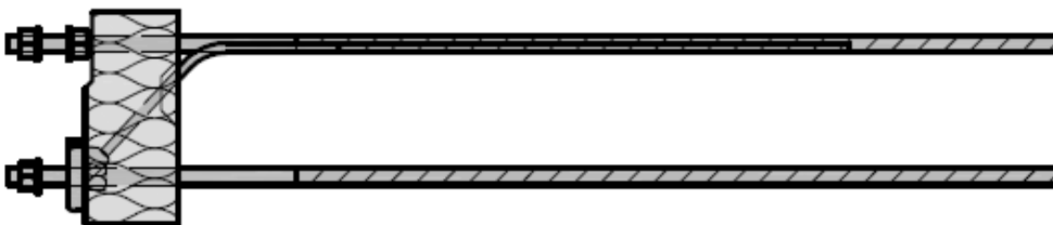
Fig.2: Schöck Isokorb® T type SK-MM1-VV1
